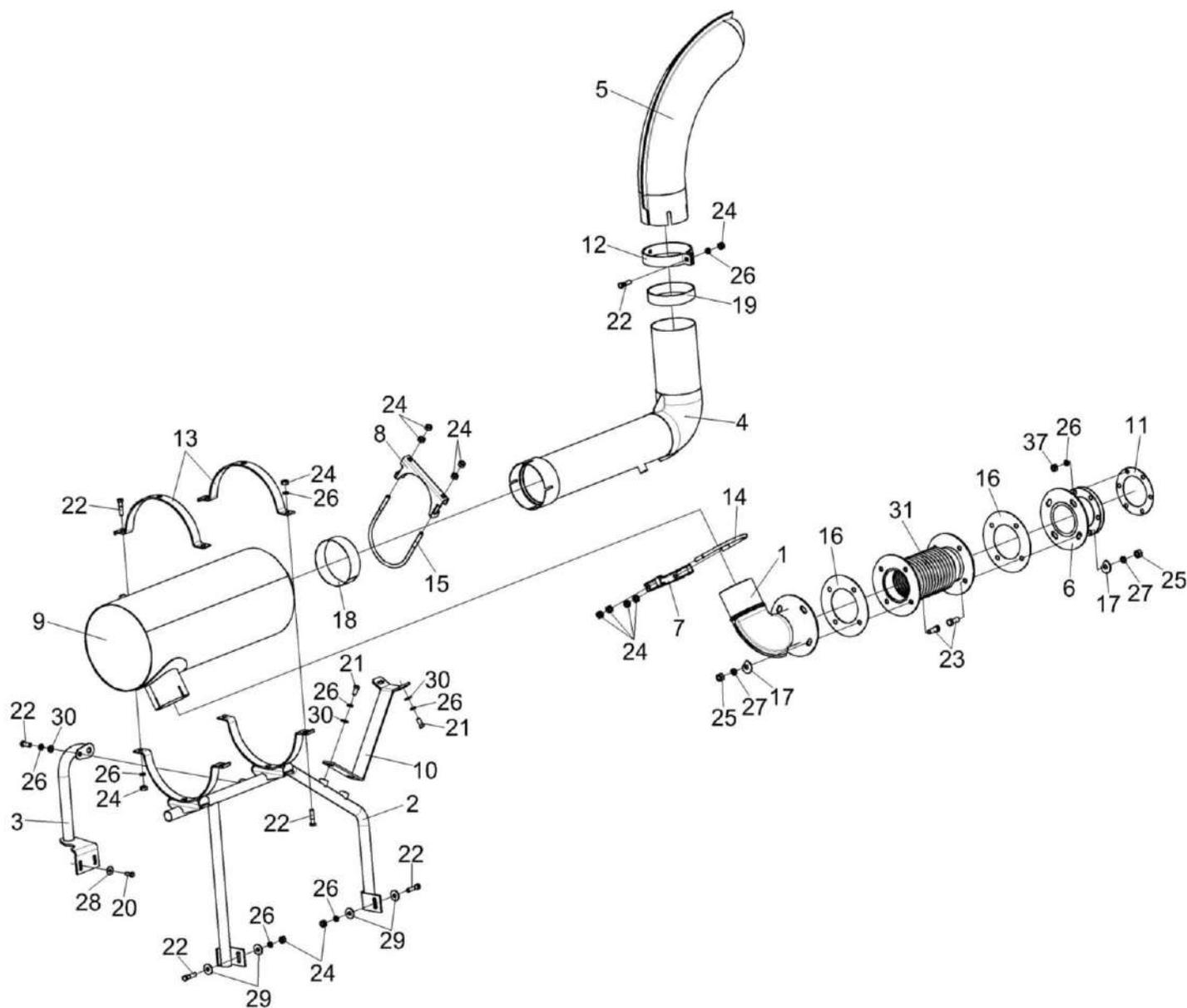
Рисунок 87 – Установка глушителя КСК-6025-0116060
