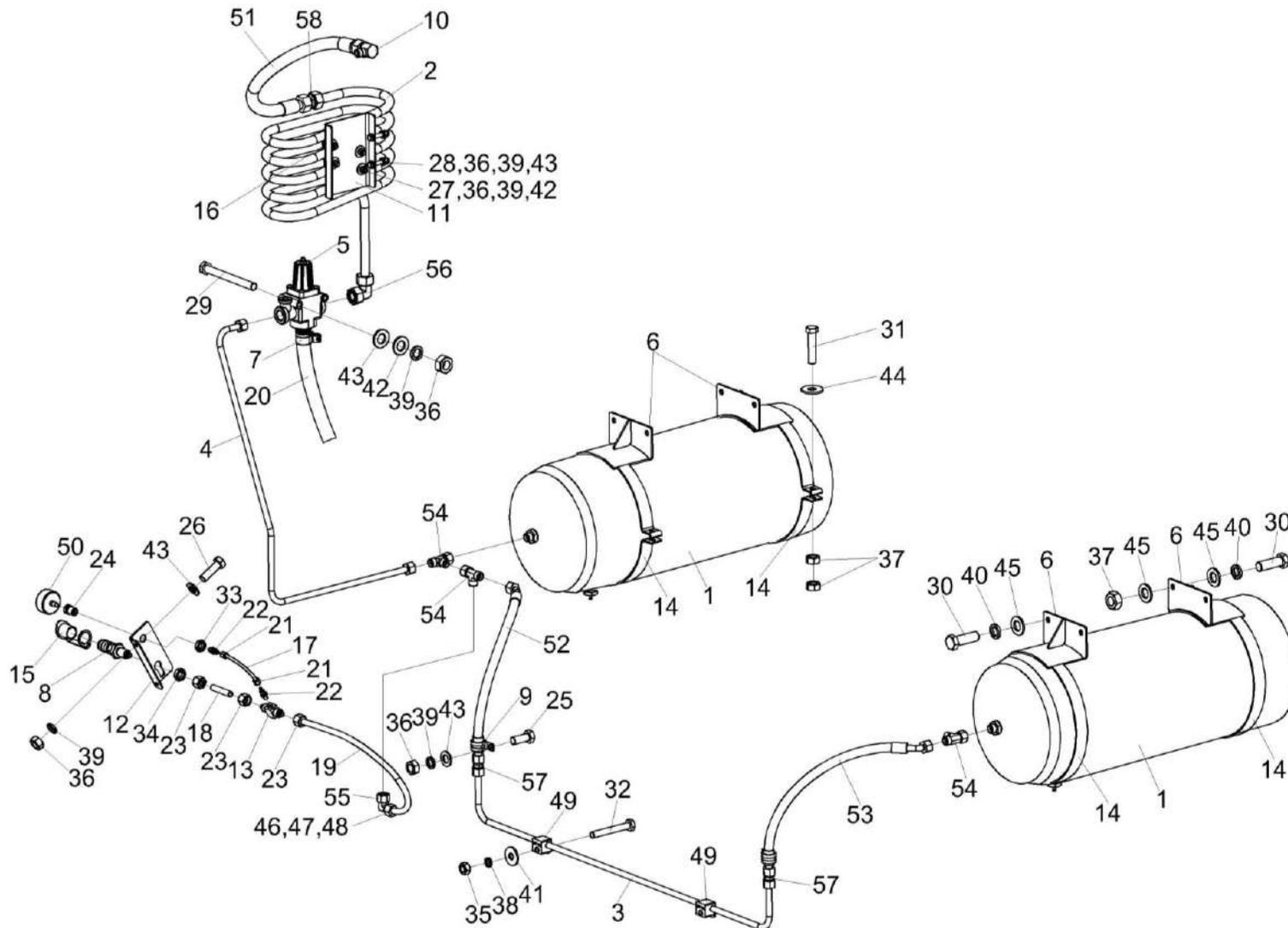
Рисунок 218 – Пневмосистема КСК-6025-0180000
