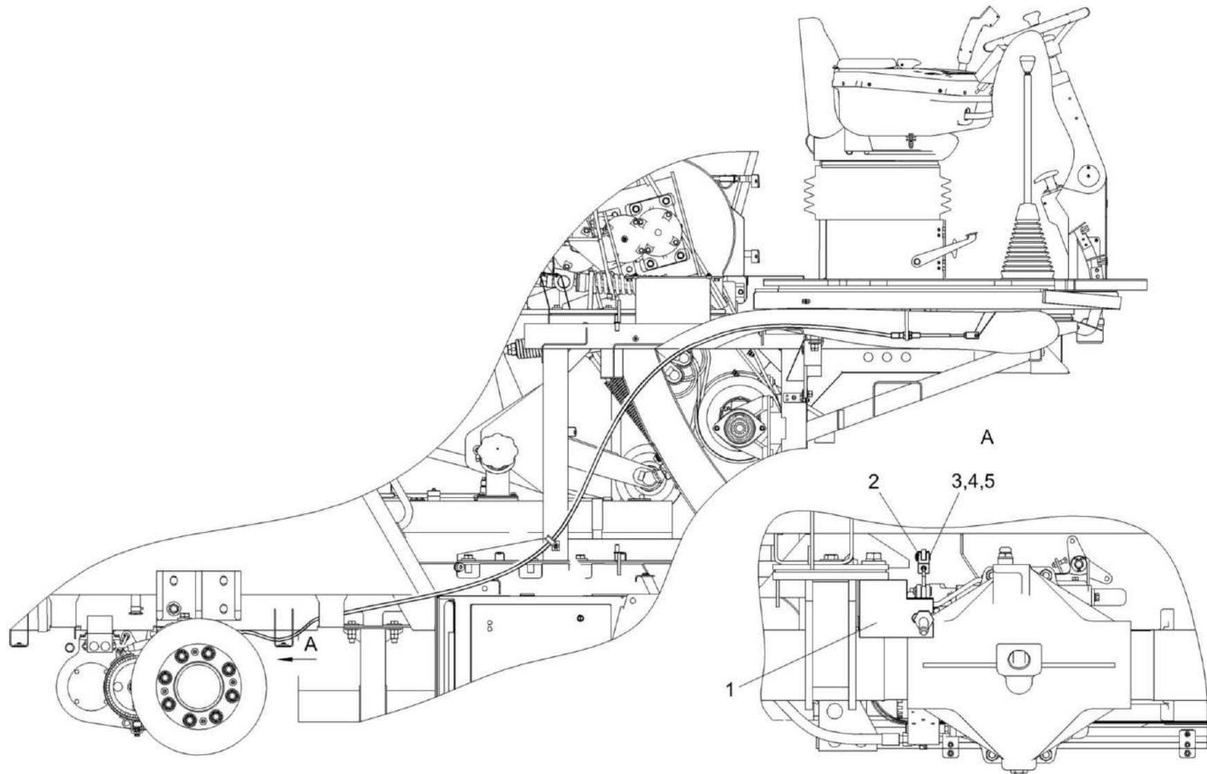
Рисунок 171 – Установка стояночного тормоза КСК-6025-0119610
