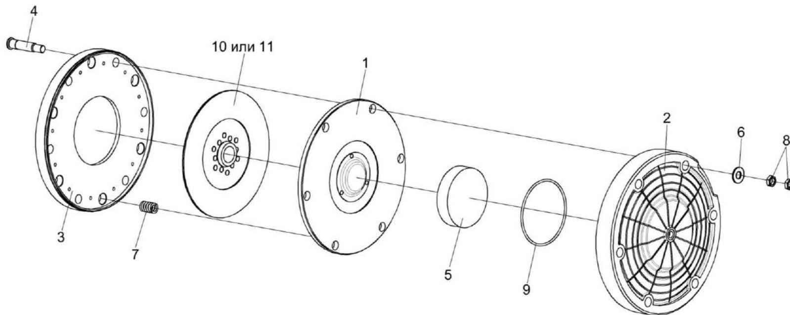
Рисунок 86 – Механизм нажимной КСК-6025-0116020
