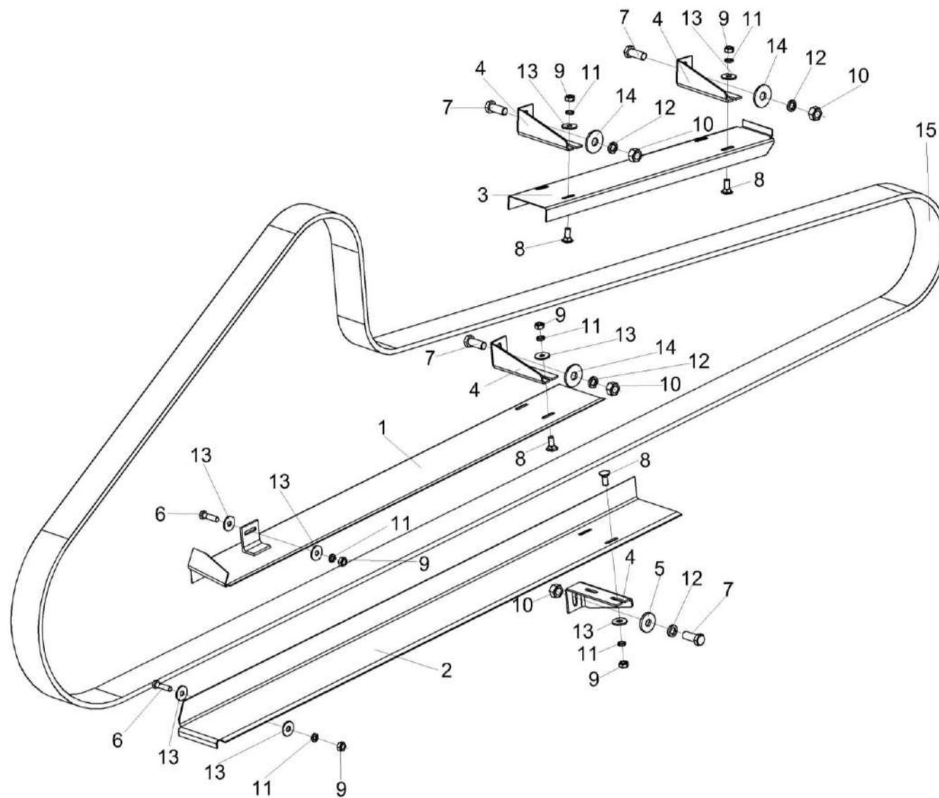
Рисунок 100 – Передача ременная КСК-6025-0131000 (лист 2)
