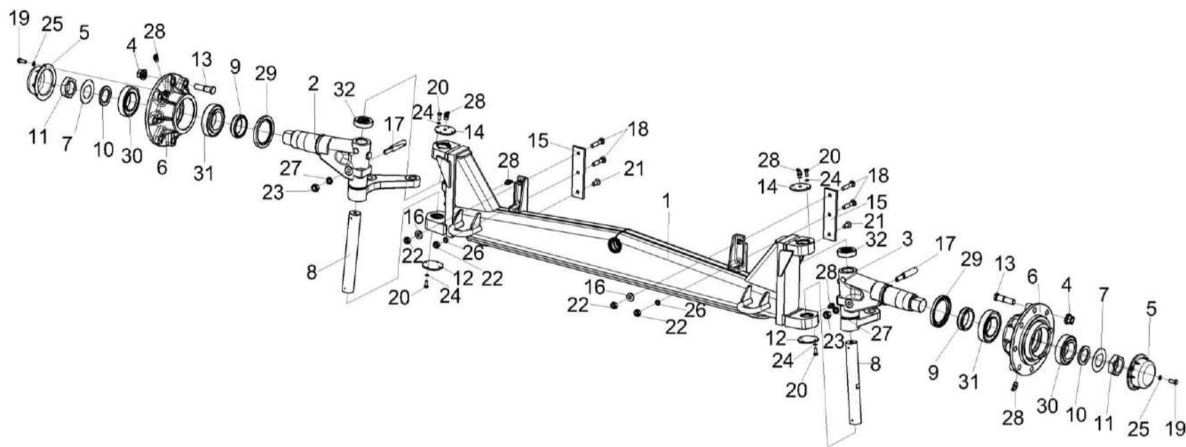
Рисунок 115 – Мост управляемых колес КСК-6025-0109000 (лист 1)
