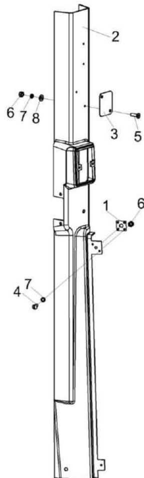
Рисунок 127 – Облицовка стойки КСК-6025-0120060
