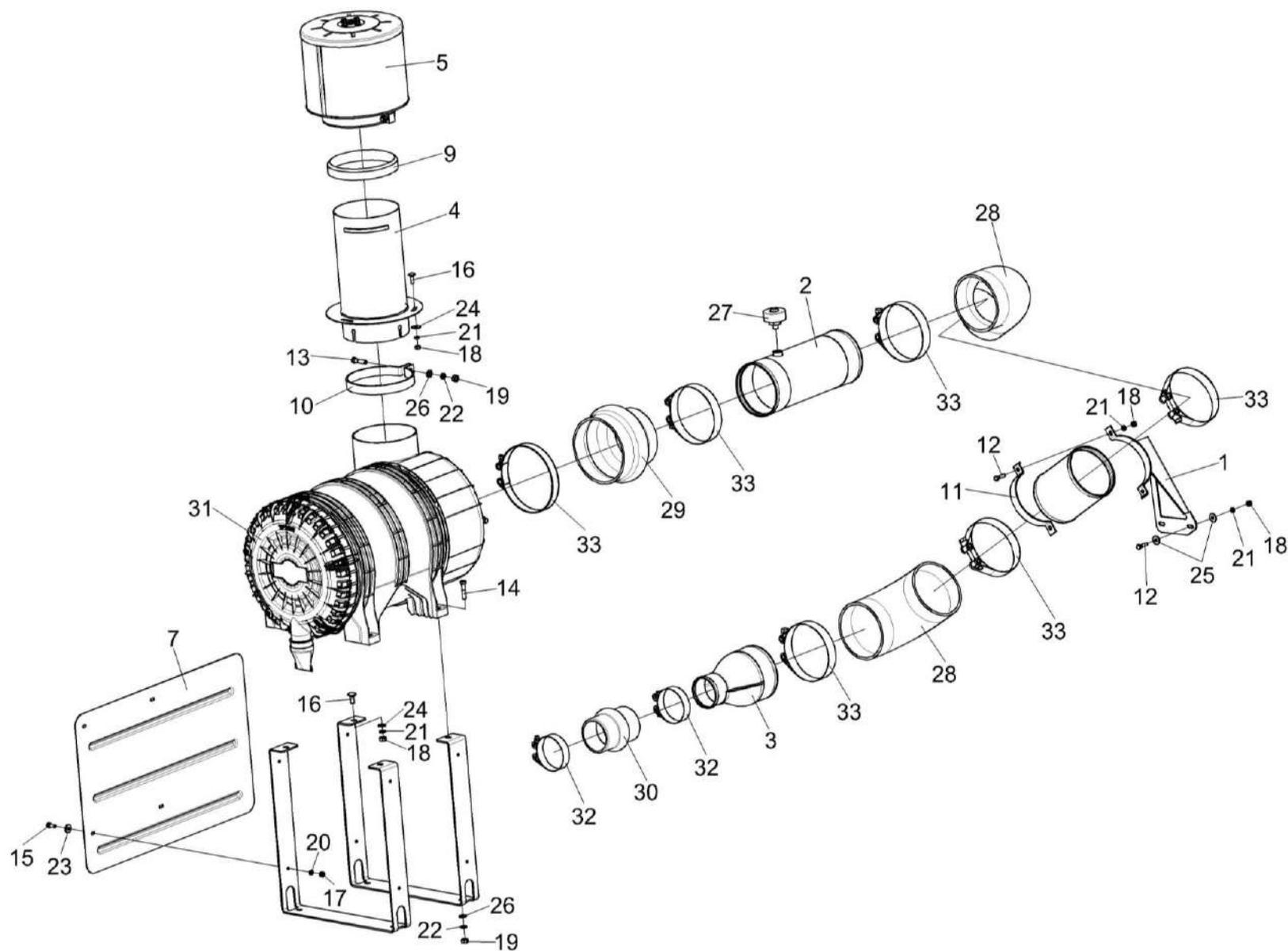
Рисунок 89 – Установка воздухоочистителя КСК-6025-0116080
