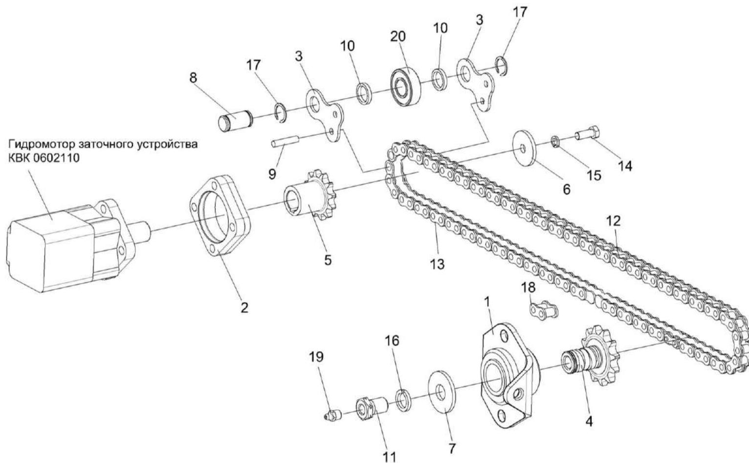
Рисунок 33 – Привод каретки КВК 0116010
