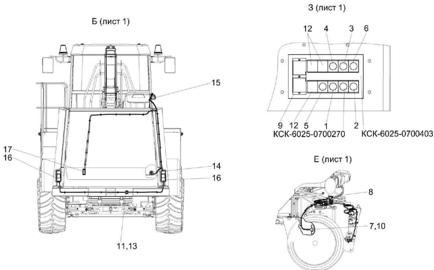
Рисунок 224 – Установка электрооборудования измельчителя КСК-6025-0721000 (лист 3)
