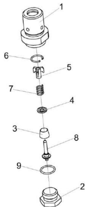
Рисунок 217 – Клапан сливной КВС-1-0103180
