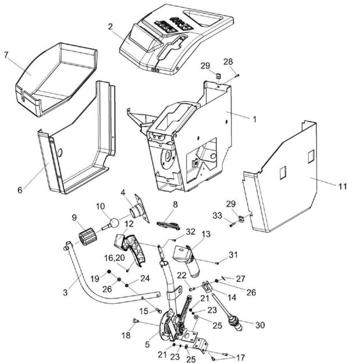
Рисунок 156 – Блок управления КСК-6025-0119240
