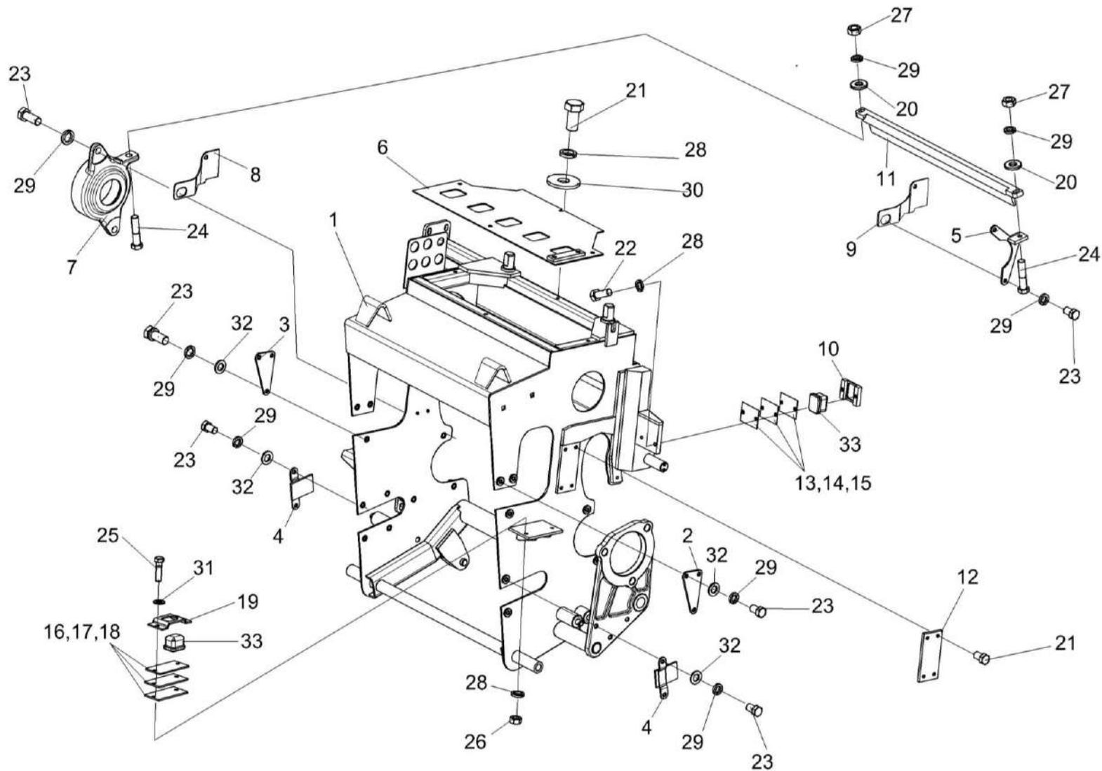
Рисунок 20 – Установка рамы КСК-6025-0151010
