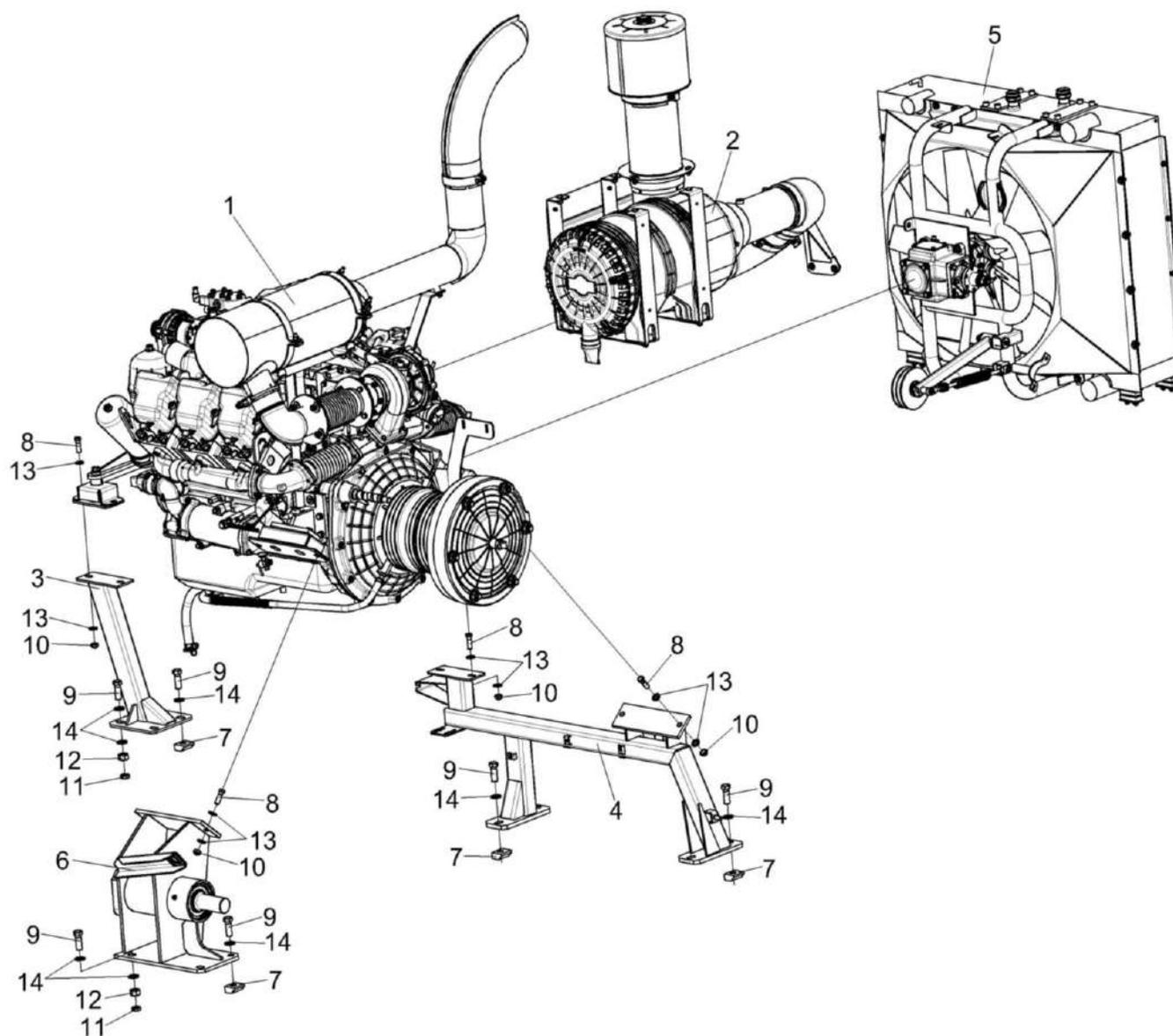
Рисунок 77 – Установка двигателя КСК-6025-0116000 (лист 1)
