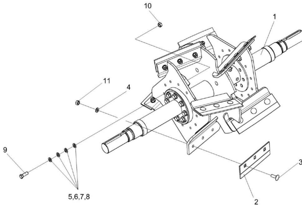
Рисунок 44 – Вал ускорителя выброса КСК-6025-0156210
