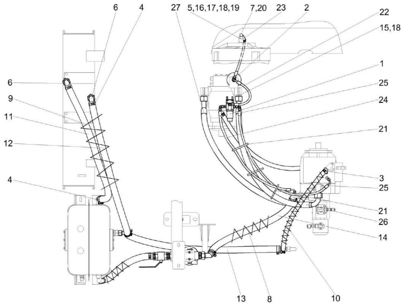
Рисунок 189 – Гидросистема привода ходовой части КСК-6025-0601000 (лист 1)
