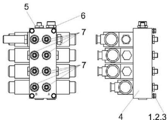
Рисунок 197 – Гидроблок четырехсекционный КСК-6025-0602310
