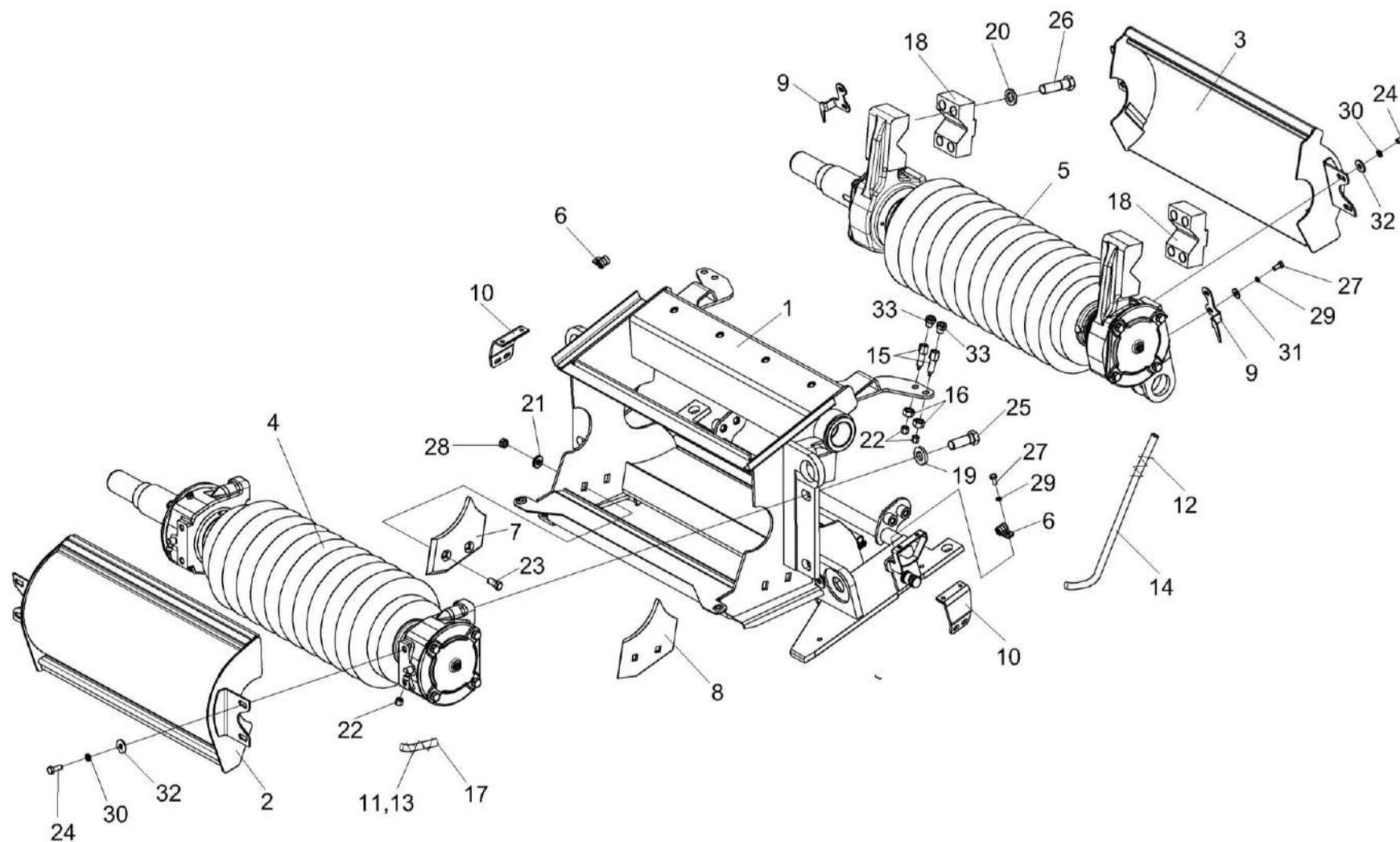
Рисунок 65 – Устройство доизмельчающее КСК-6025-0157010 (лист 2)
