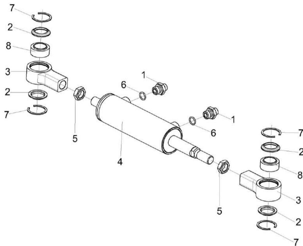
Рисунок 118 – Гидроцилиндр КСК-6025-0109070
