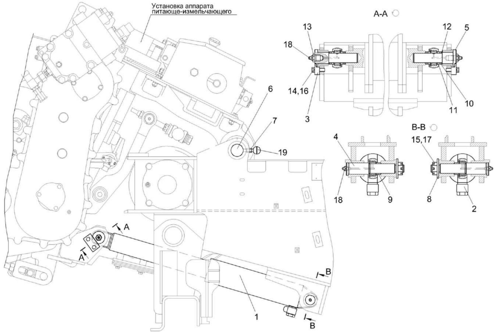
Рисунок 3 – Установка механизма вывешивания КСК-6025-0162000
