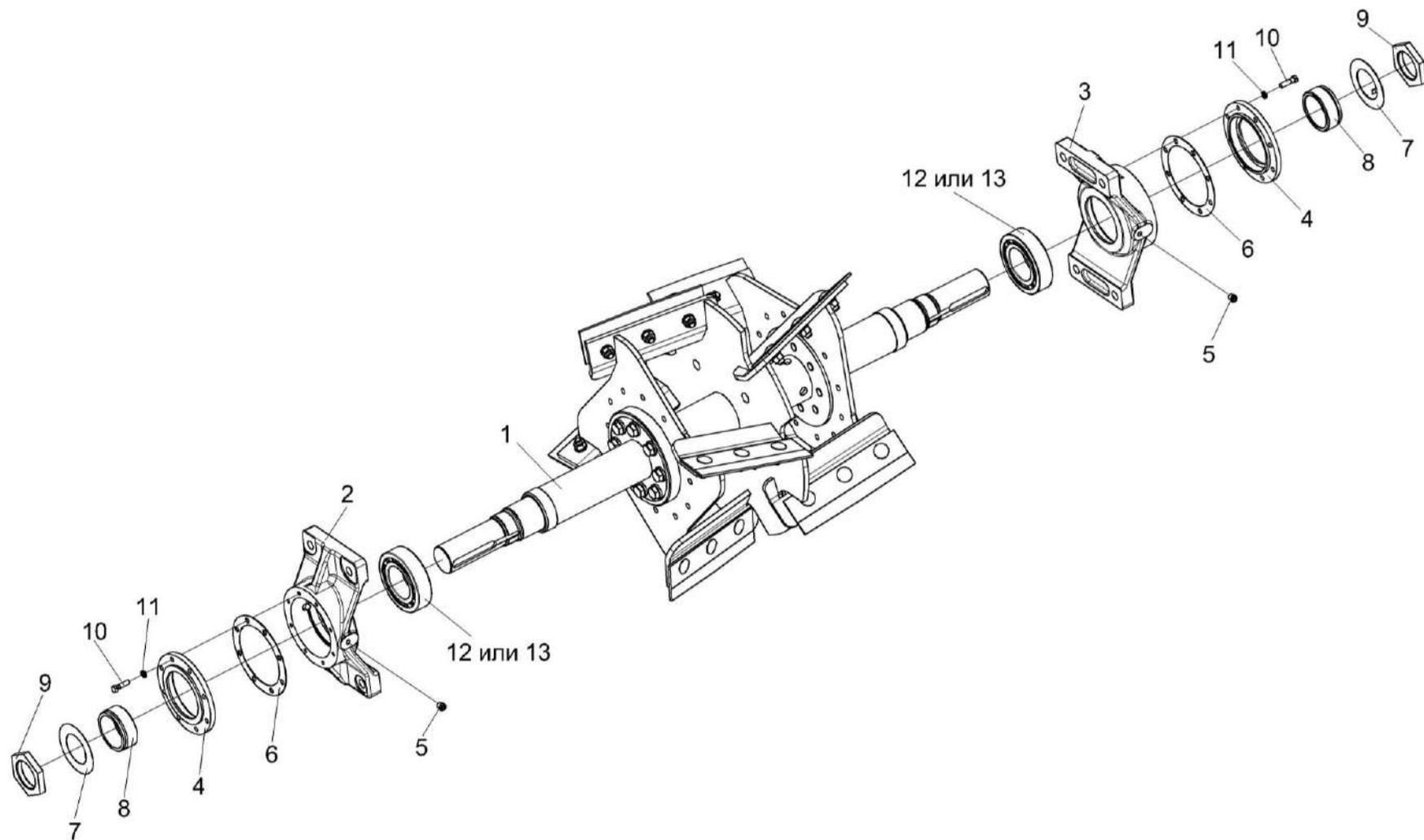
Рисунок 43 – Вал ускорителя выброса КСК-6025-0156200
