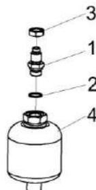
Рисунок 192 – Пневмогидроаккумулятор КСК-6025-0601330
