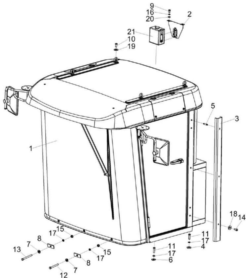
Рисунок 122 – Установка кабины КСК-6025-0120000
