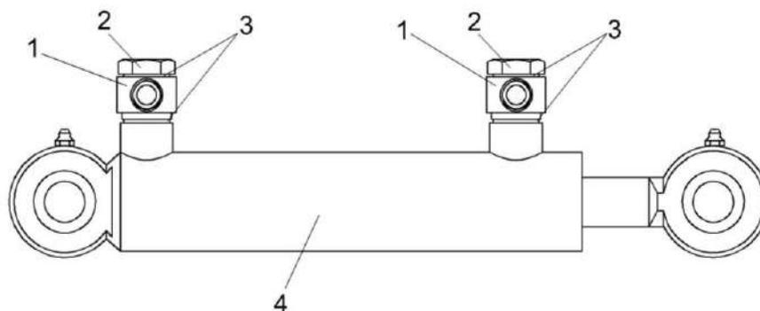
Рисунок 53 – Гидроцилиндр подъема силосопровода КВК 0602510А
