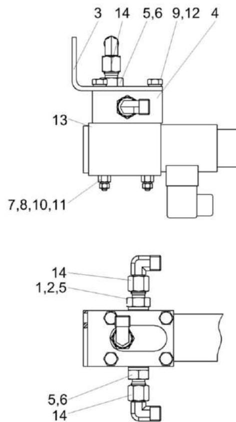
Рисунок 191 – Гидроблок включения главного привода КСК-6025-0601300
