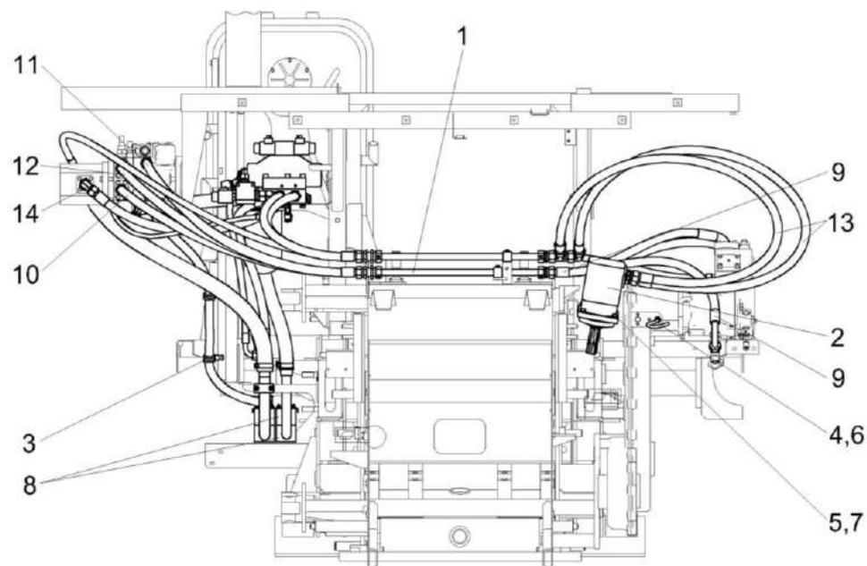
Рисунок 208 – Гидропривод питающего аппарата и адаптеров КСК-6025-0604000 (лист 3)
