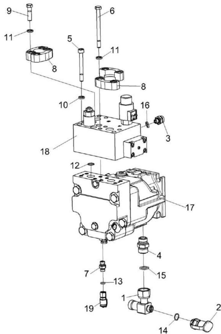
Рисунок 36 – Гидромотор привода питающего аппарата КСК-6025-0604230
