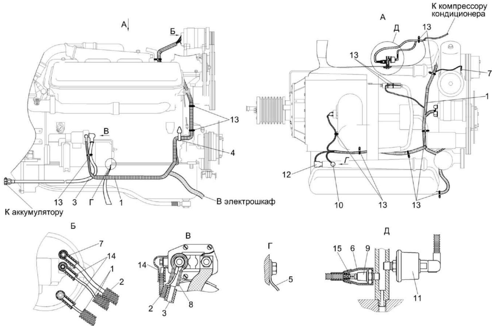
Рисунок 94 – Установка электрооборудования двигателя КСК-6025-0726000
