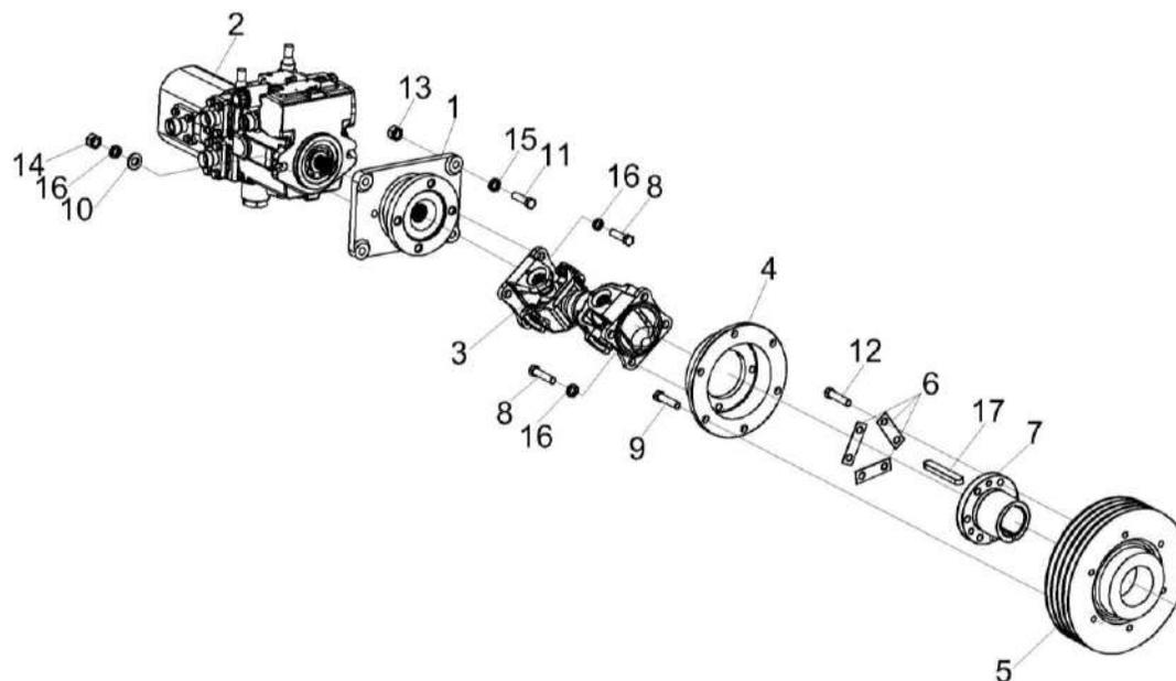
Рисунок 95 – Установка гидронасоса двухсекционного КСК-6025-0100150
