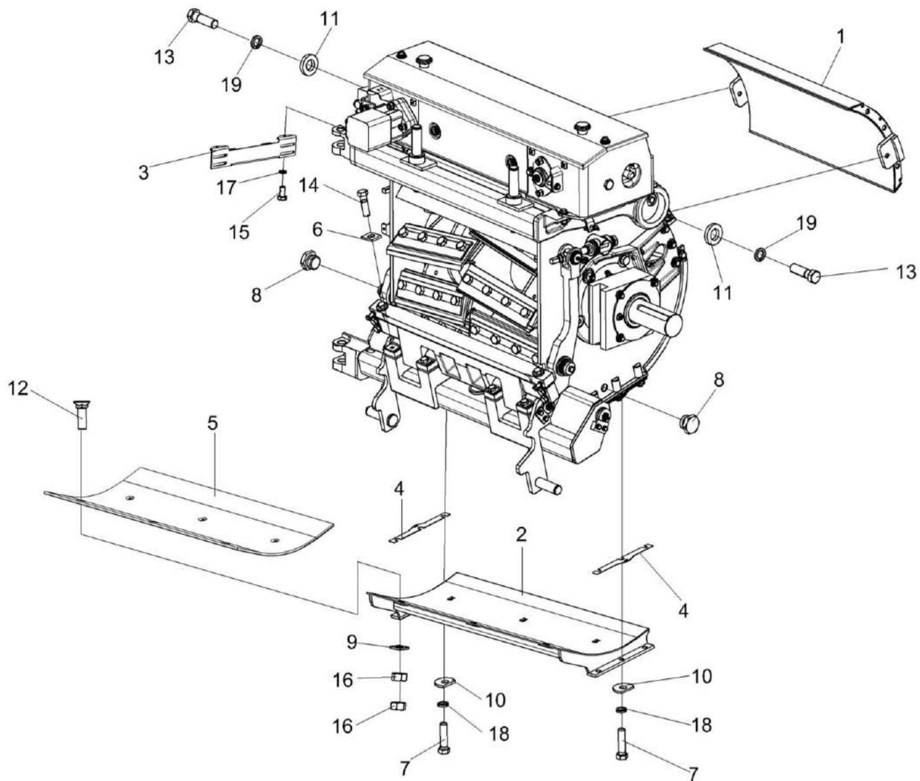
Рисунок 26 – Установка поддона КСК-6025-0153300
