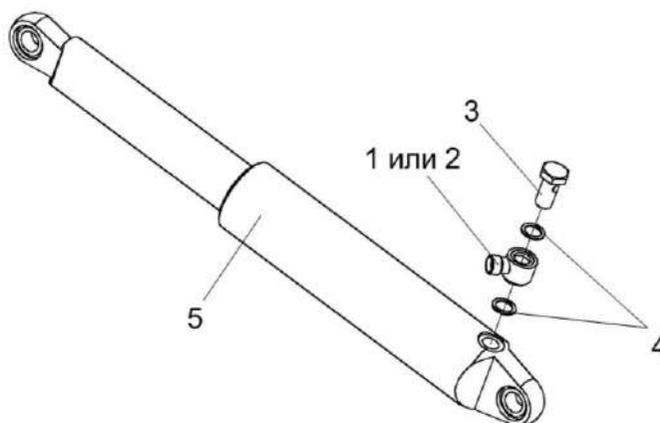
Рисунок 4 – Гидроцилиндры навески КСК-6025-0602490 и КСК-6025-0602490-01
