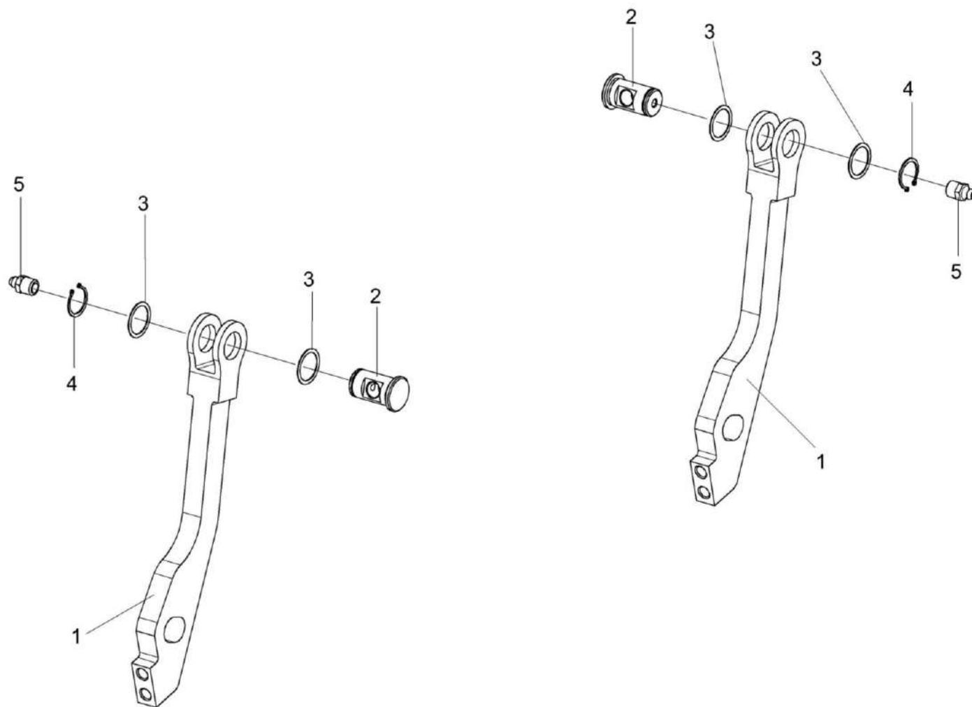
Рисунок 25 – Рычаг КСК-6025-0153200, КСК-6025-0153200-01
