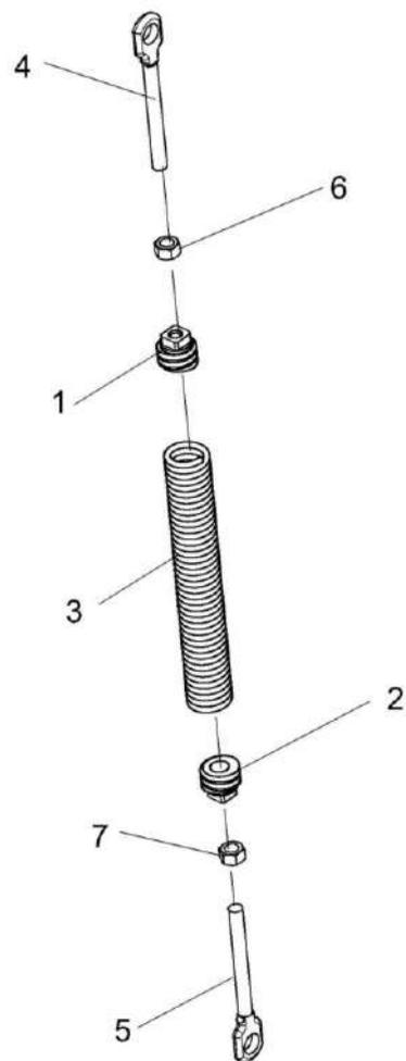
Рисунок 10 – Пружина КВС-1-0111020
