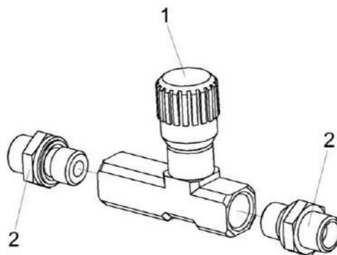
Рисунок 200 – Дроссель с обратным клапаном регулируемый КСК-6025-0602420
