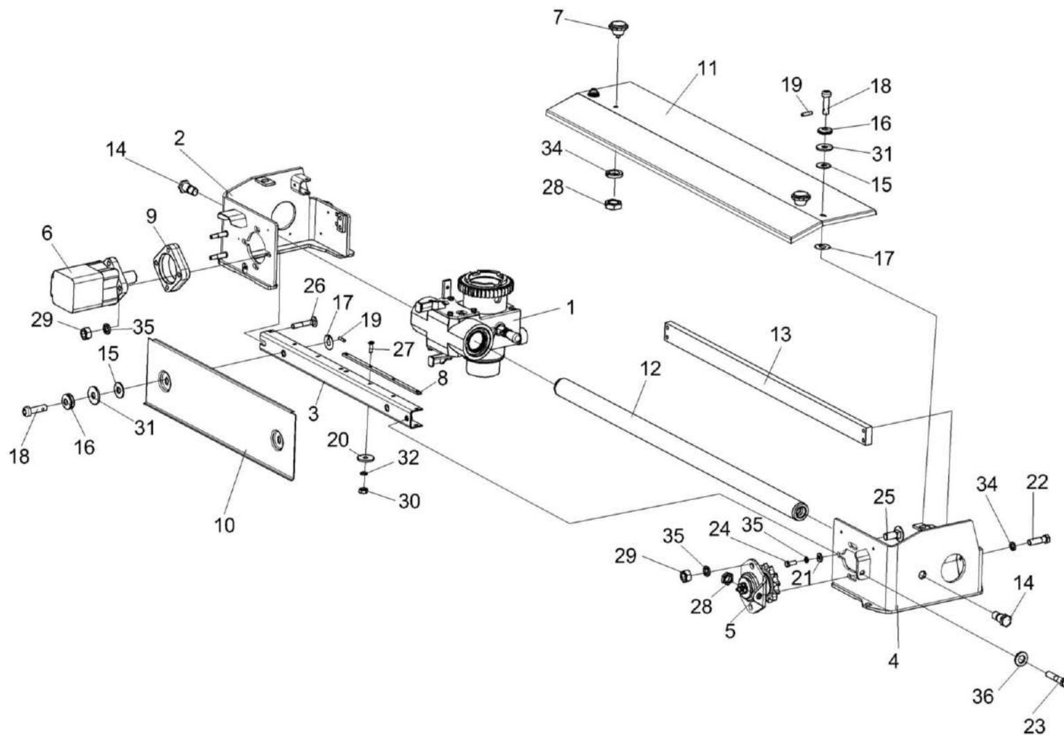
Рисунок 31 – Устройство заточное КСК-6025-0155000
