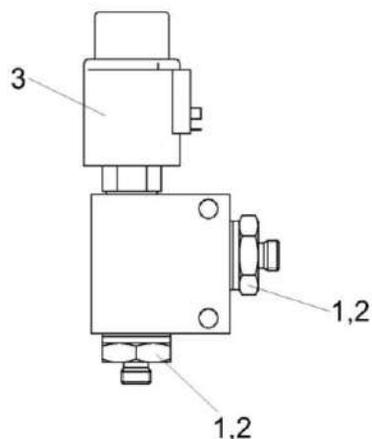
Рисунок 198 – Клапан электроуправляемый КСК-6025-0602320
