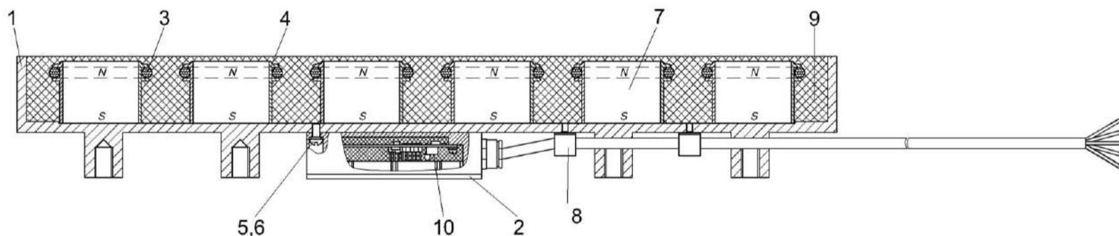
Рисунок 17 – Ванна магнитная КСК-6025-0701020
