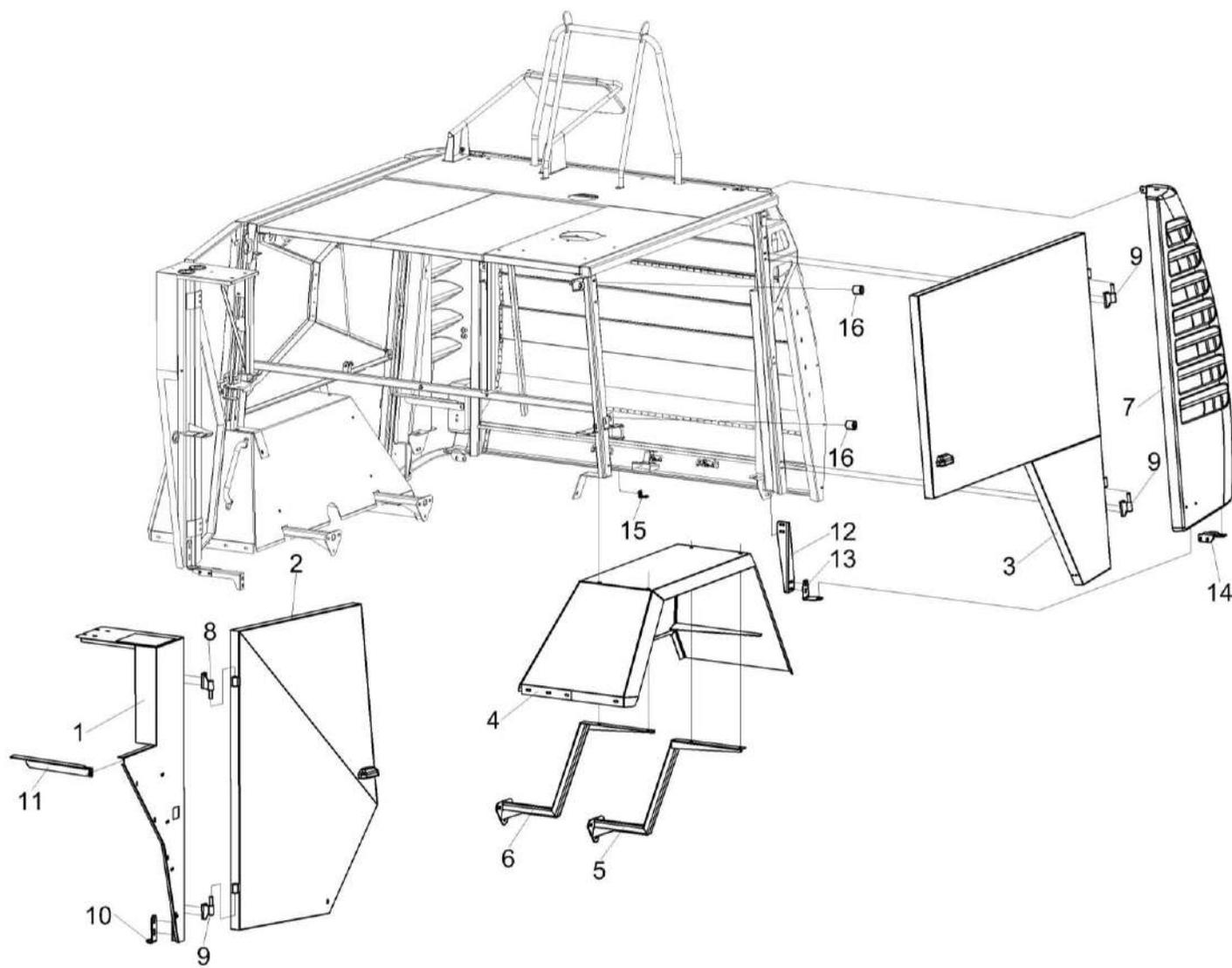
Рисунок 178 – Установка капотов КСК-6025-0128000 (лист 1)
