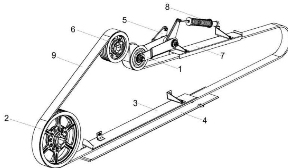
Рисунок 98 – Передача ременная КСК-6025-0131000 (общий вид)
