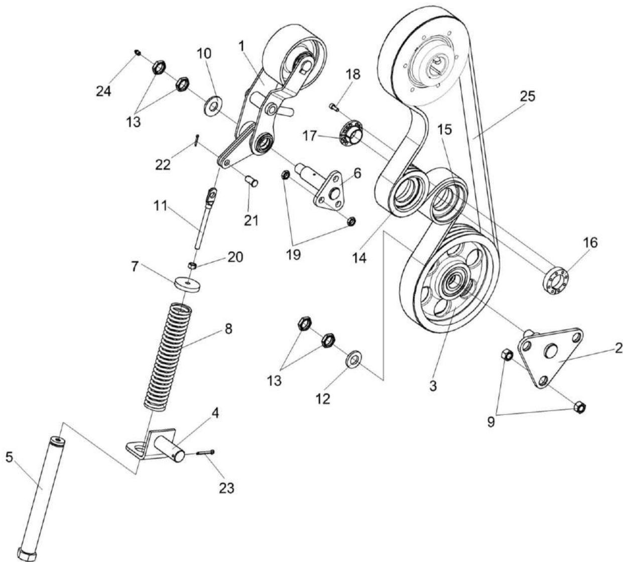
Рисунок 61 – Передача ременная КСК-6025-0132000
