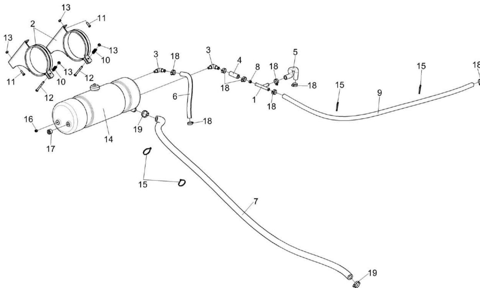
Рисунок 88 – Установка бачка расширительного КСК-6025-0116070
