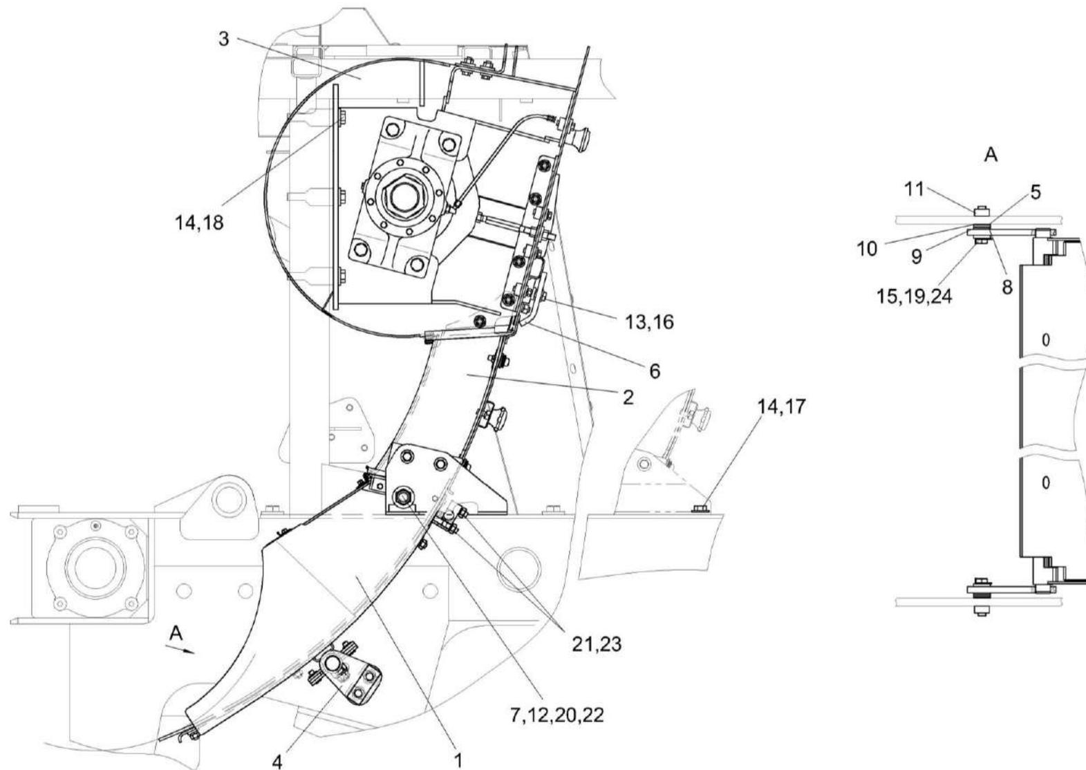
Рисунок 38 – Установка камеры приемной, проставки и ускорителя выброса КСК-6025-0152000
