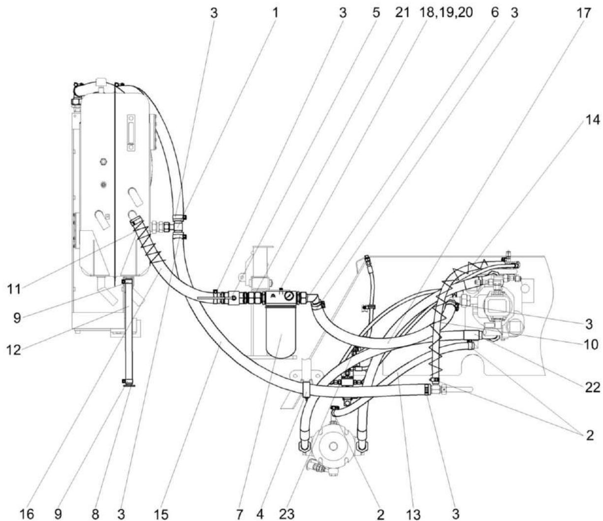
Рисунок 190 – Гидросистема привода ходовой части КСК-6025-0601000 (лист 2)
