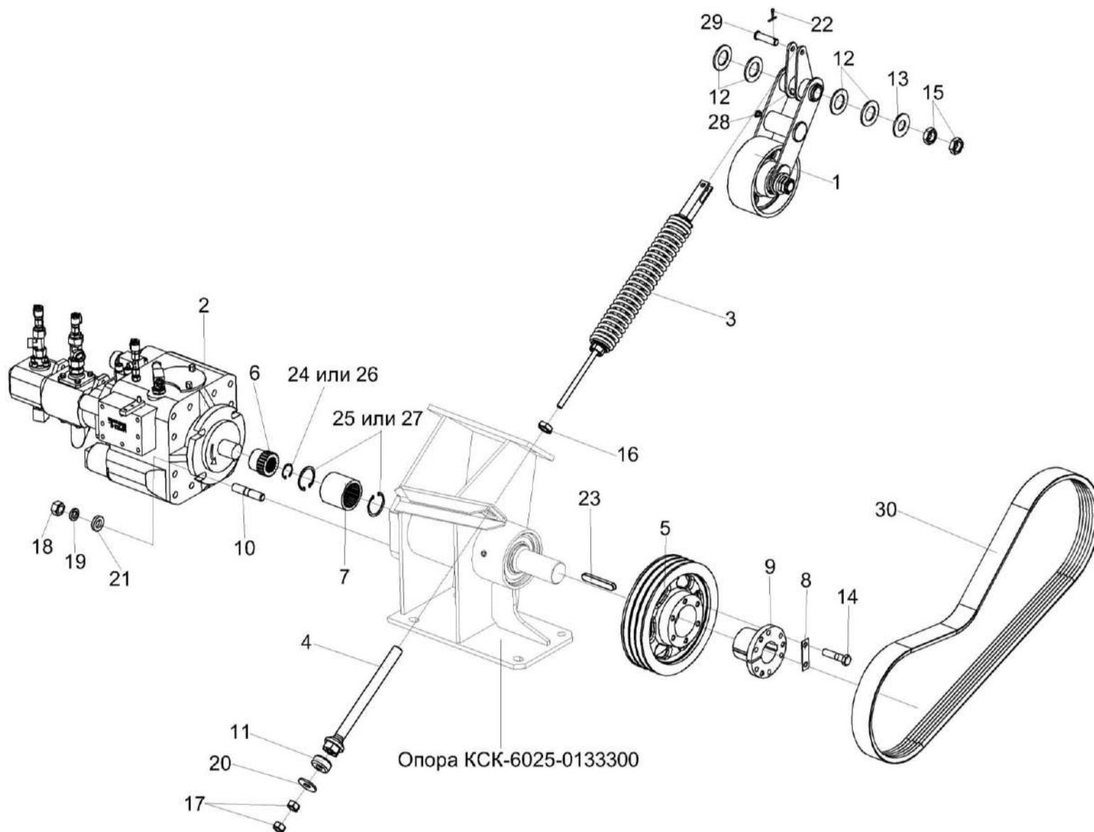
Рисунок 103 – Передача ременная КСК-6025-0133000
