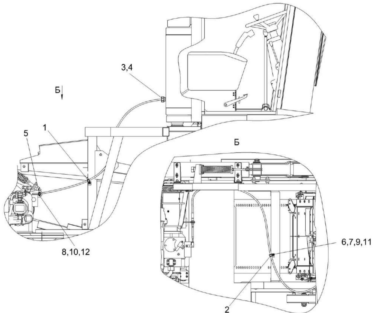
Рисунок 150 – Установка троссов гидростата КСК-6025-0119150
