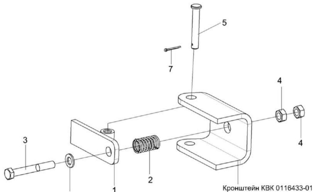
Рисунок 34 – Установка упора КВК 0116060
