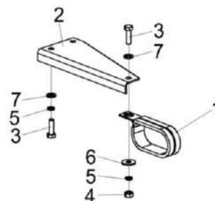
Рисунок 143 – Установка кронштейна КСК-6025-0121060
