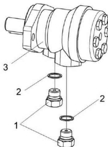
Рисунок 51 – Гидромотор силосопровода КСК-6025-0602100
