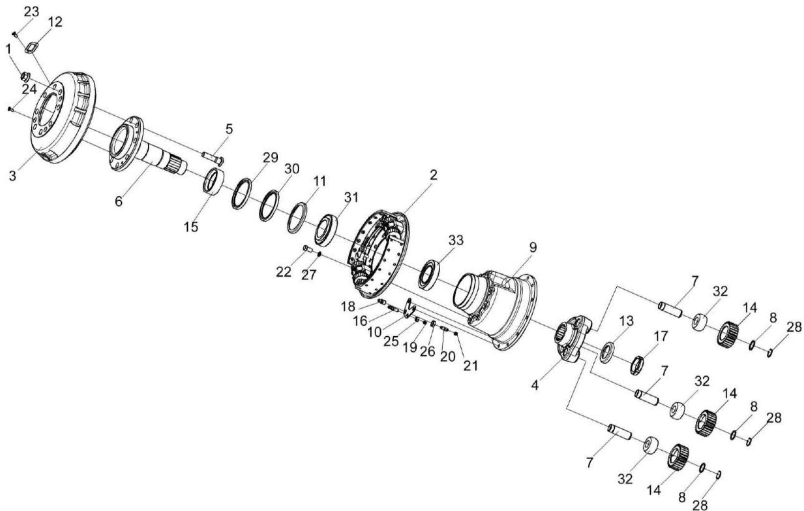
Рисунок 114 – Редуктор бортовой КЗК 0107070-01
