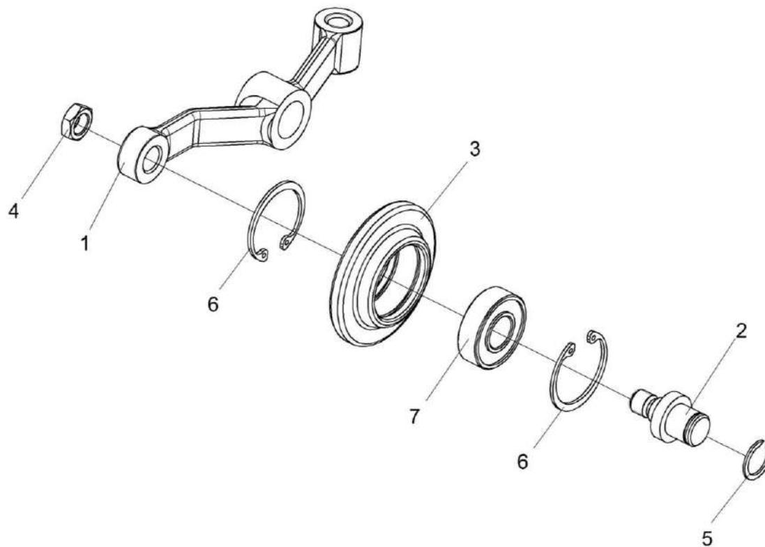
Рисунок 74 – Рычаг КВК 0149150
