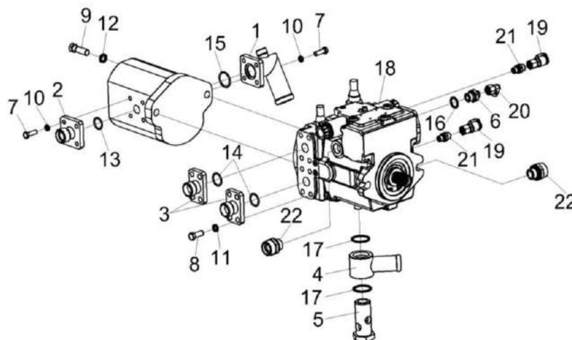
Рисунок 97 – Гидронасос двухсекционный КСК-6025-0604100
