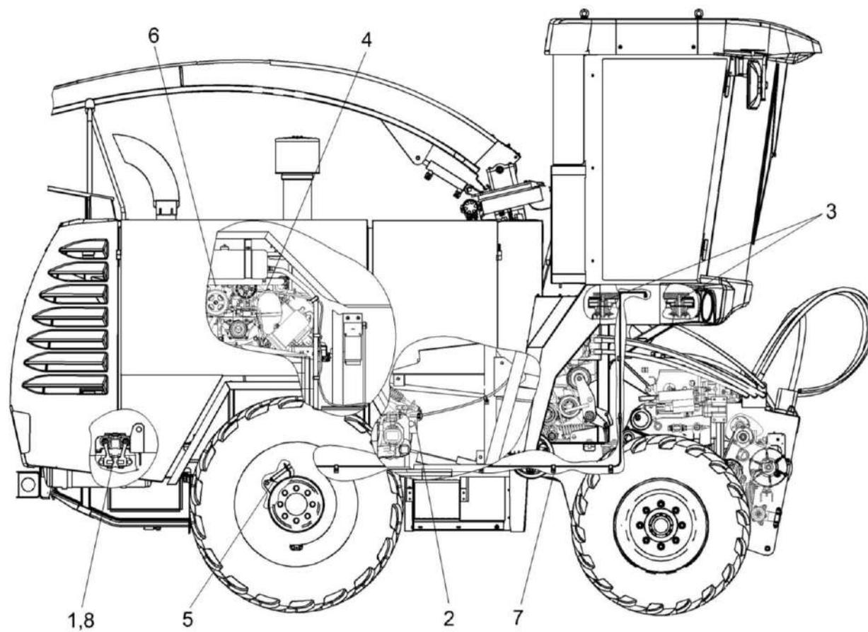
Рисунок 148 – Установка элементов управления КСК-6025-0119100
