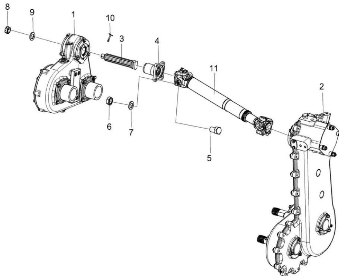
Рисунок 21 – Установка вала карданного 75491-2119010-01
