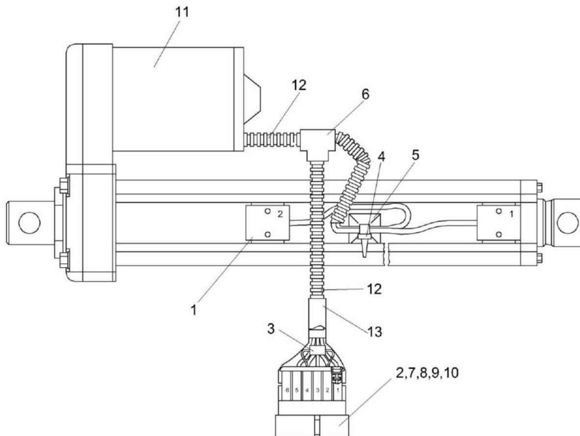
Рисунок 35 – Электромеханизм крышки заточного устройства КВК 0701610
