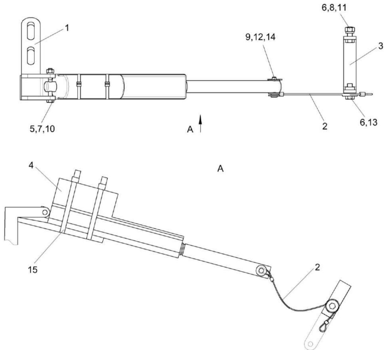
Рисунок 169 – Управление топливным насосом КСК-6025-0119600
