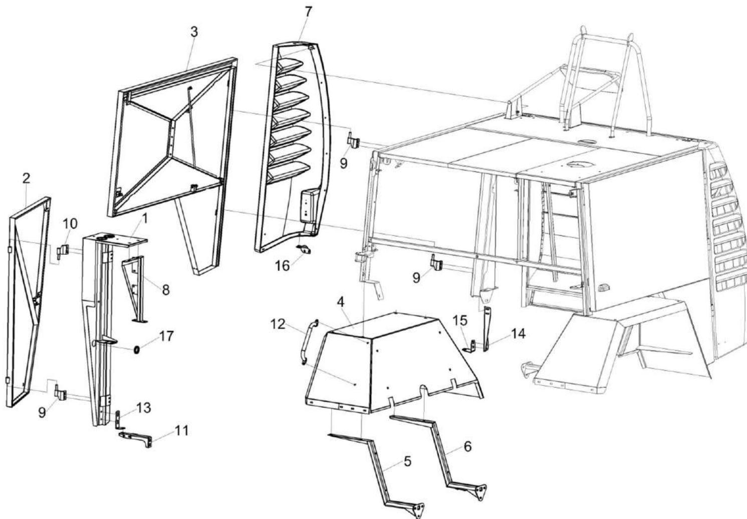
Рисунок 179 – Установка капотов КСК-6025-0128000 (лист 2)
