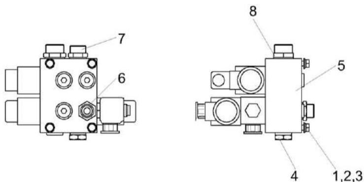
Рисунок 196 – Гидроблок навески КСК-6025-0602300
