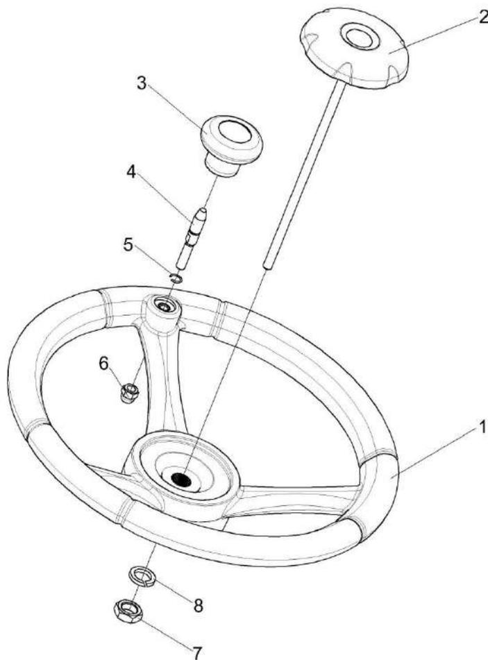
Рисунок 166 – Установка колеса рулевого КЗК-12-0122300
