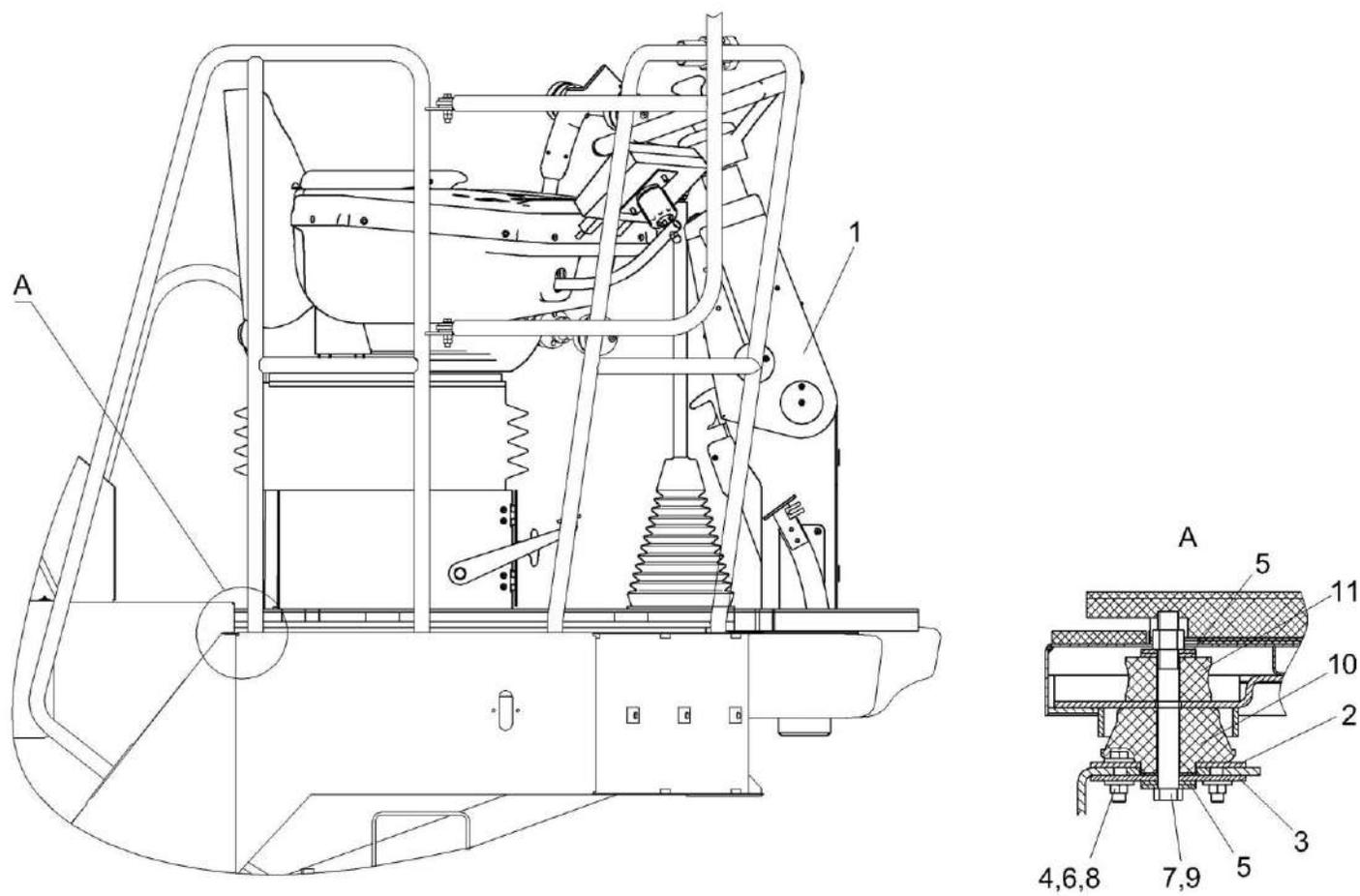
Рисунок 151 – Установка площадки управления КСК-6025-0119200
