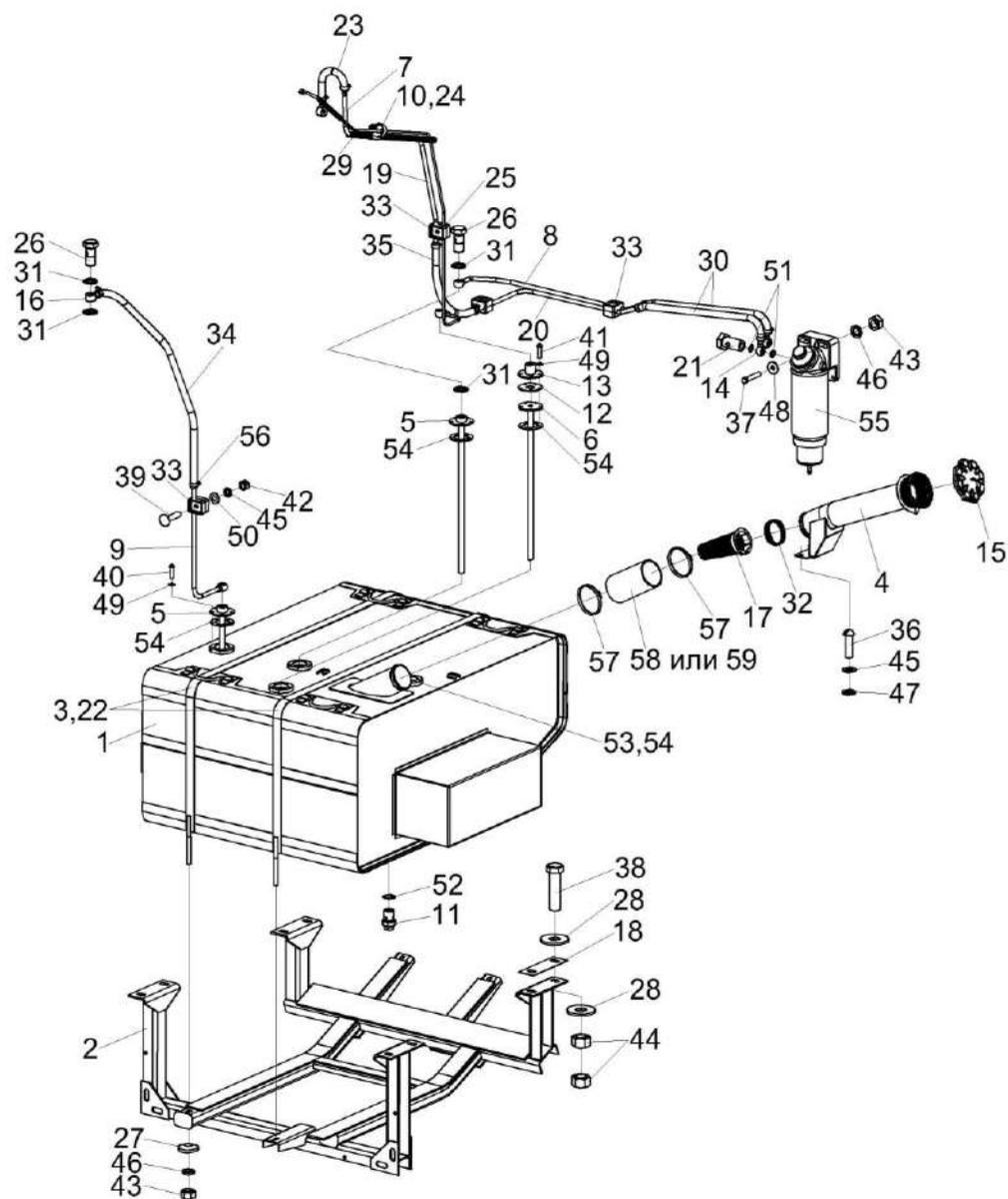
Рисунок 216 – Установка топливного оборудования КСК-6025-0123000
