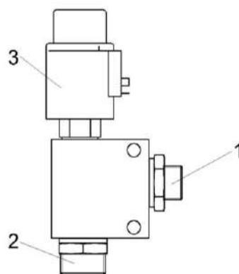
Рисунок 210 – Клапан электроуправляемый КСК-6025-0604370
