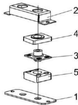
Рисунок 84 – Амортизатор КЗК-10-0106160
