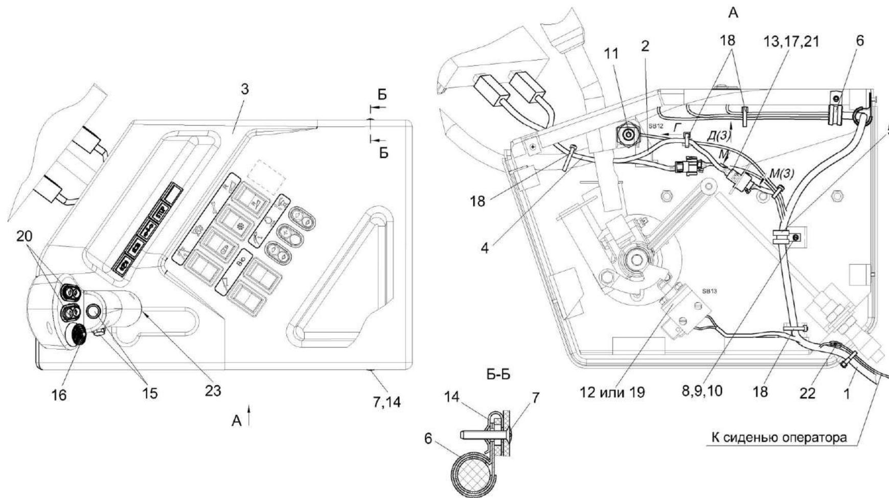
Рисунок 157 – Установка электрооборудования пульта управления КСК-6025-0725000
