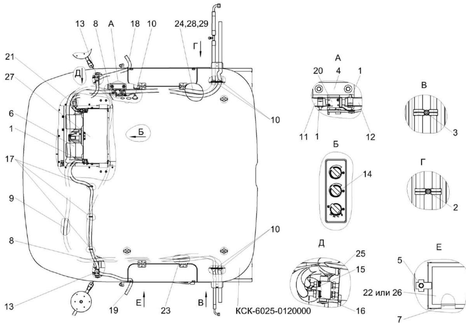
Рисунок 145 – Установка испарителя КСК-6025-0121020
