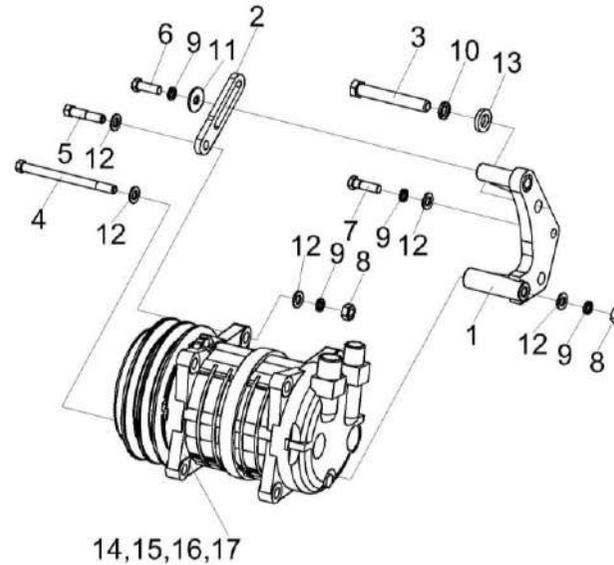
Рисунок 141 – Установка компрессора КСК-6025-0121030
