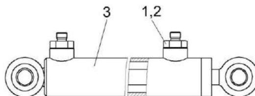
Рисунок 59 – Гидроцилиндр козырька силосопровода КВК 0602530А
