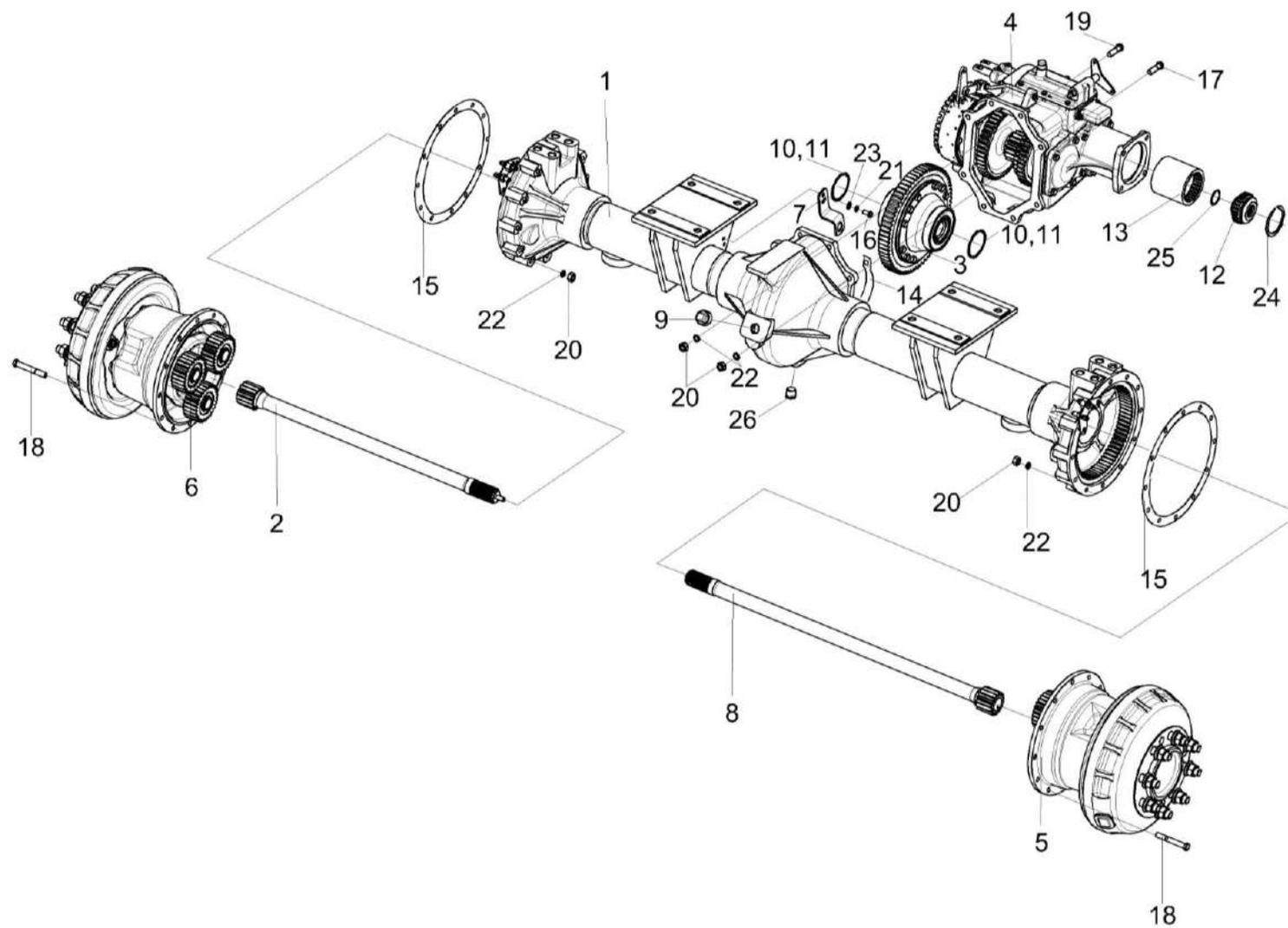
Рисунок 109 – Мост ведущих колес КСК-6025-0107000
