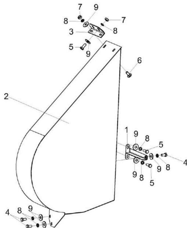
Рисунок 187 – Установка ограждения КСК-6025-0100300
