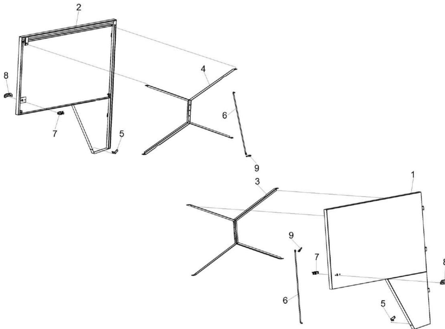
Рисунок 183 – Капот КСК-6025-0128190 и КСК-6025-0128190-01
