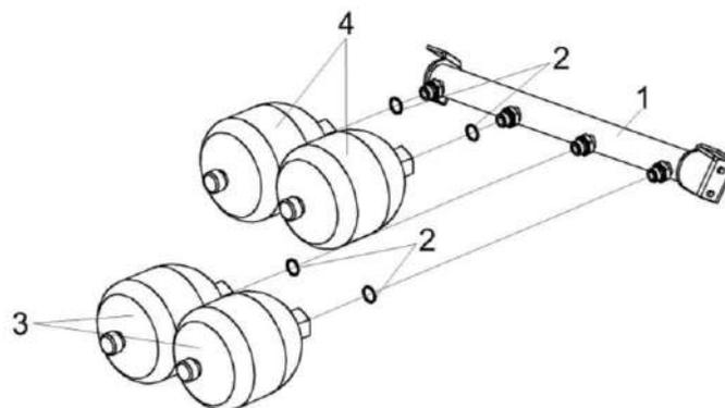
Рисунок 199 – Блок пневмогидроаккумуляторов КСК-6025-0602350
