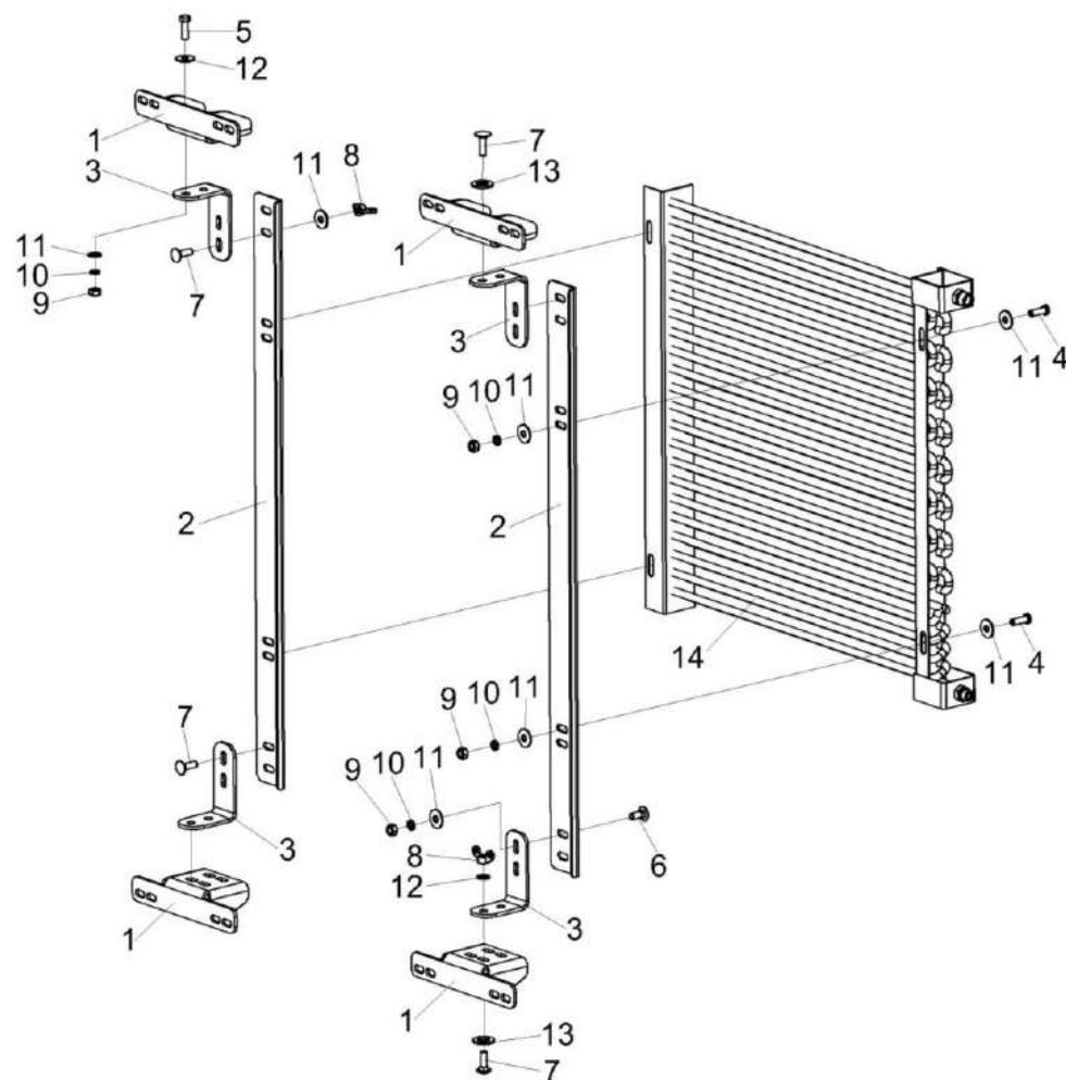
Рисунок 142 – Установка конденсатора КСК-6025-0121050
