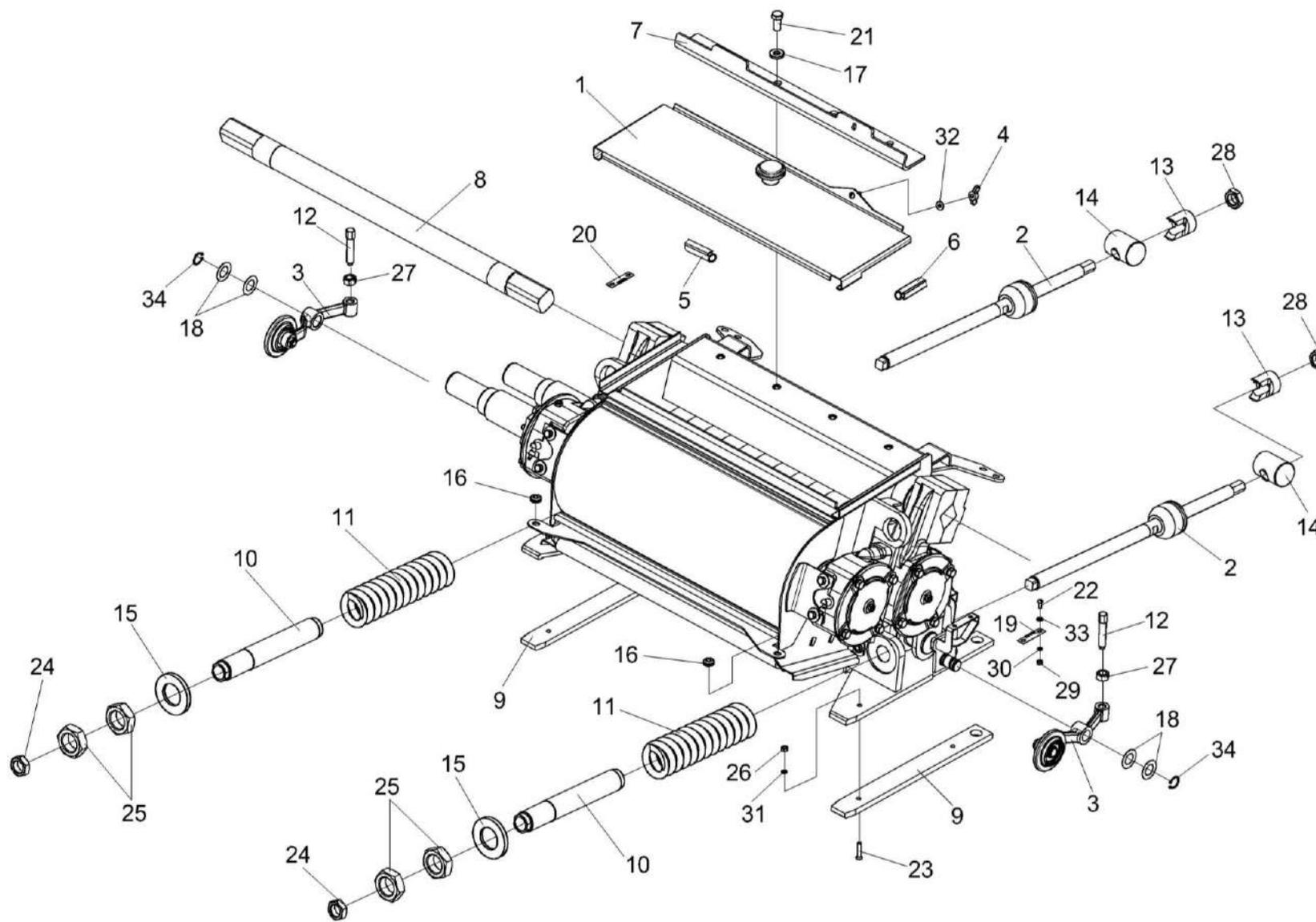
Рисунок 64 – Устройство доизмельчающее КСК-6025-0157010 (лист 1)
