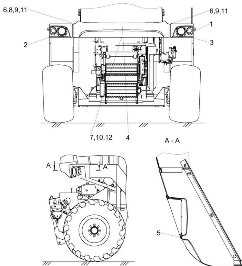
Рисунок 176 – Установка бампера КСК-6025-0100100
