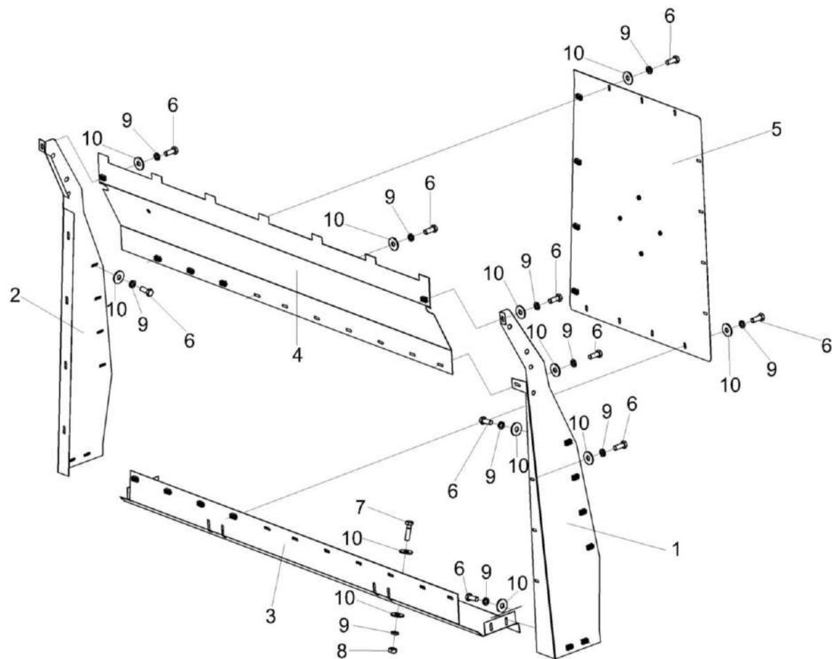
Рисунок 186 – Установка уплотнений КСК-6025-0118000
