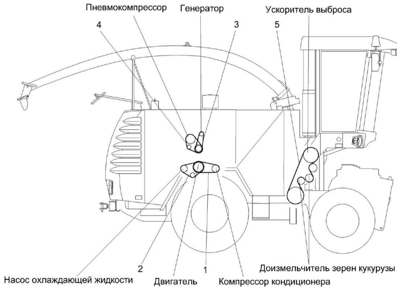
Рисунок 228 – Схема ременных передач самоходного измельчителя комбайна КВК-6025 (вид справа)
