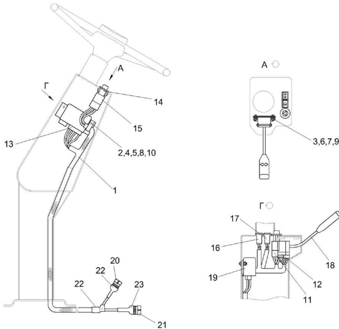
Рисунок 167 – Установка электрооборудования рулевой колонки КСК-6025-0723000
