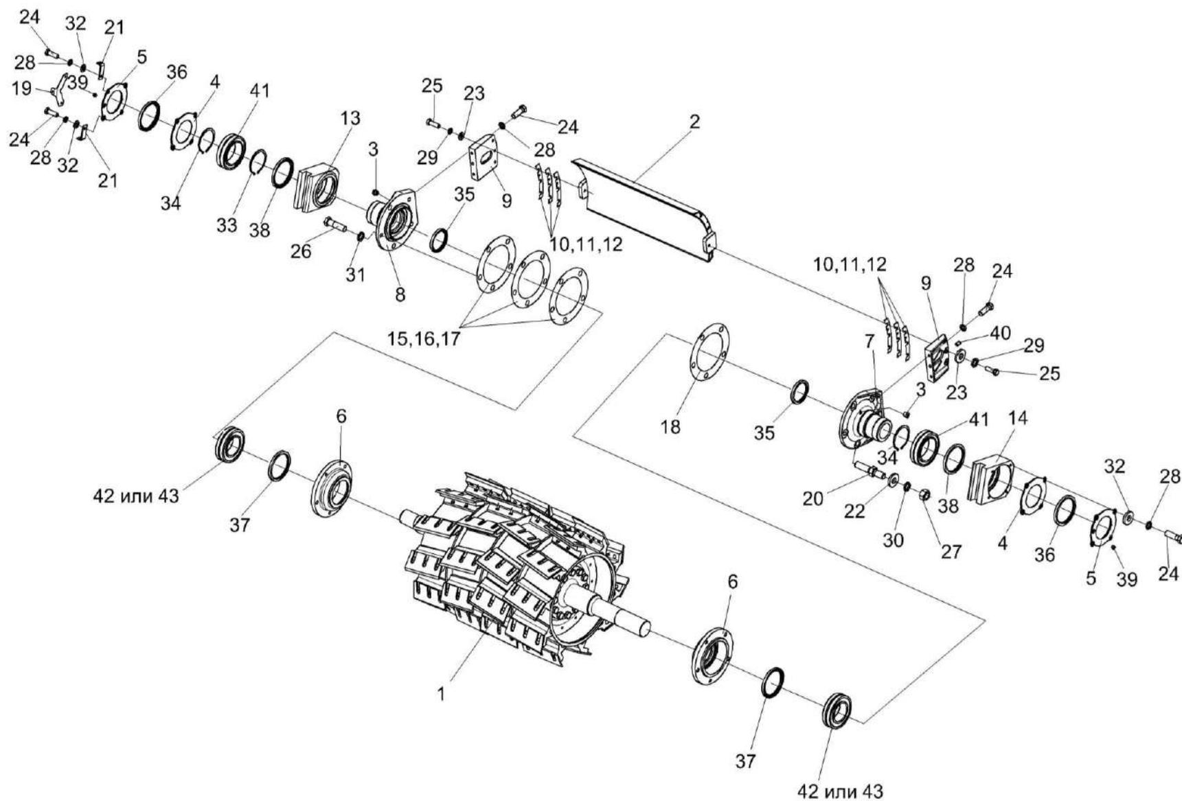
Рисунок 27 – Установка барабана КСК-6025-0153700
