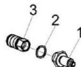
Рисунок 221 – Пневмовывод КВК 0800110
