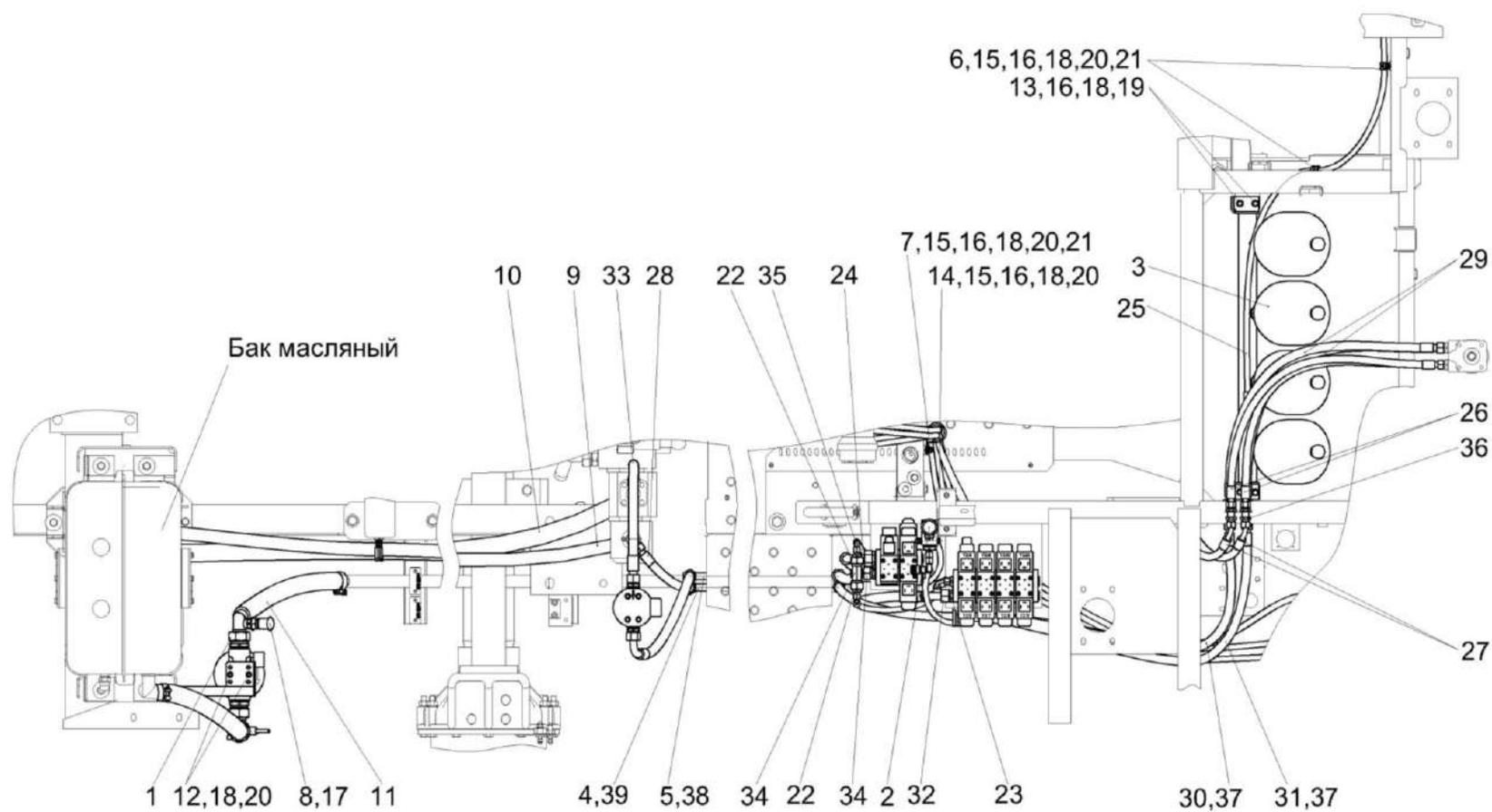
Рисунок 195 – Гидросистема рабочих органов и рулевого управления КСК-6025-0602000 (лист 3)
