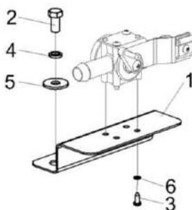
Рисунок 146 – Установка крана отопителя КЗК-8-3-0113070
