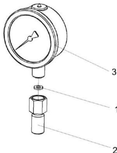
Рисунок 205 – Манометр УЭС-7-0602810
