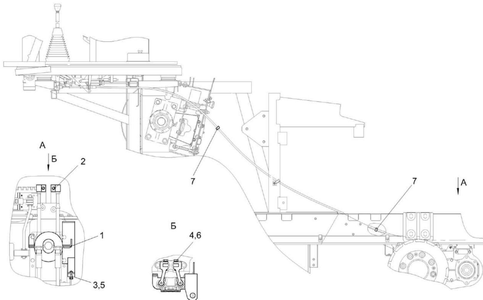
Рисунок 149 – Установка механизма переключения передач КСК-6025-0119060
