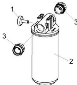
Рисунок 212 – Фильтр всасывающий КСК-6025-0604420
