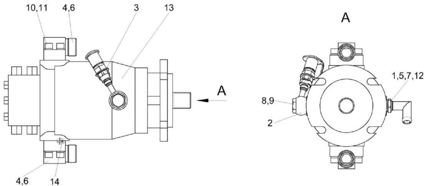
Рисунок 119 – Гидромотор КСК-6025-0601230
