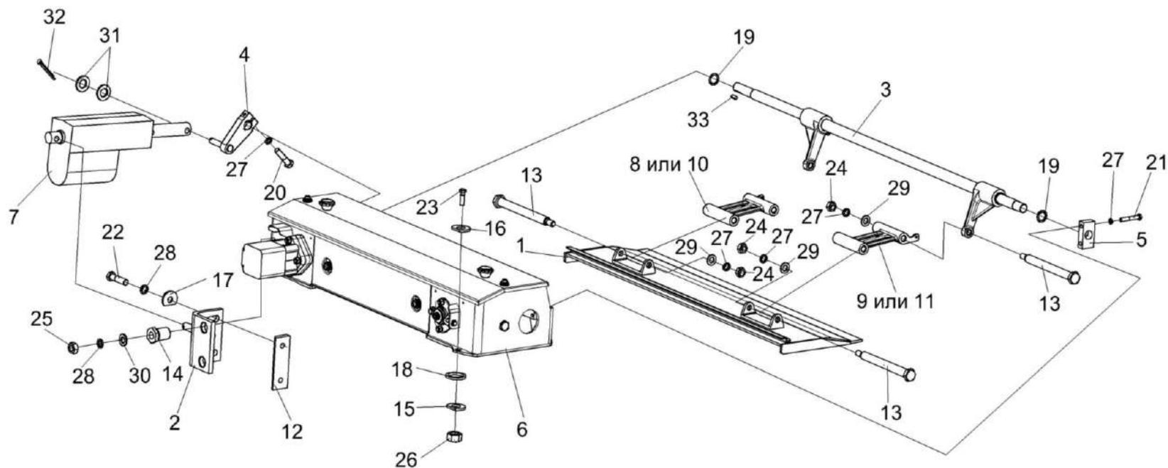
Рисунок 29 – Установка привода КСК-6025-0153220
