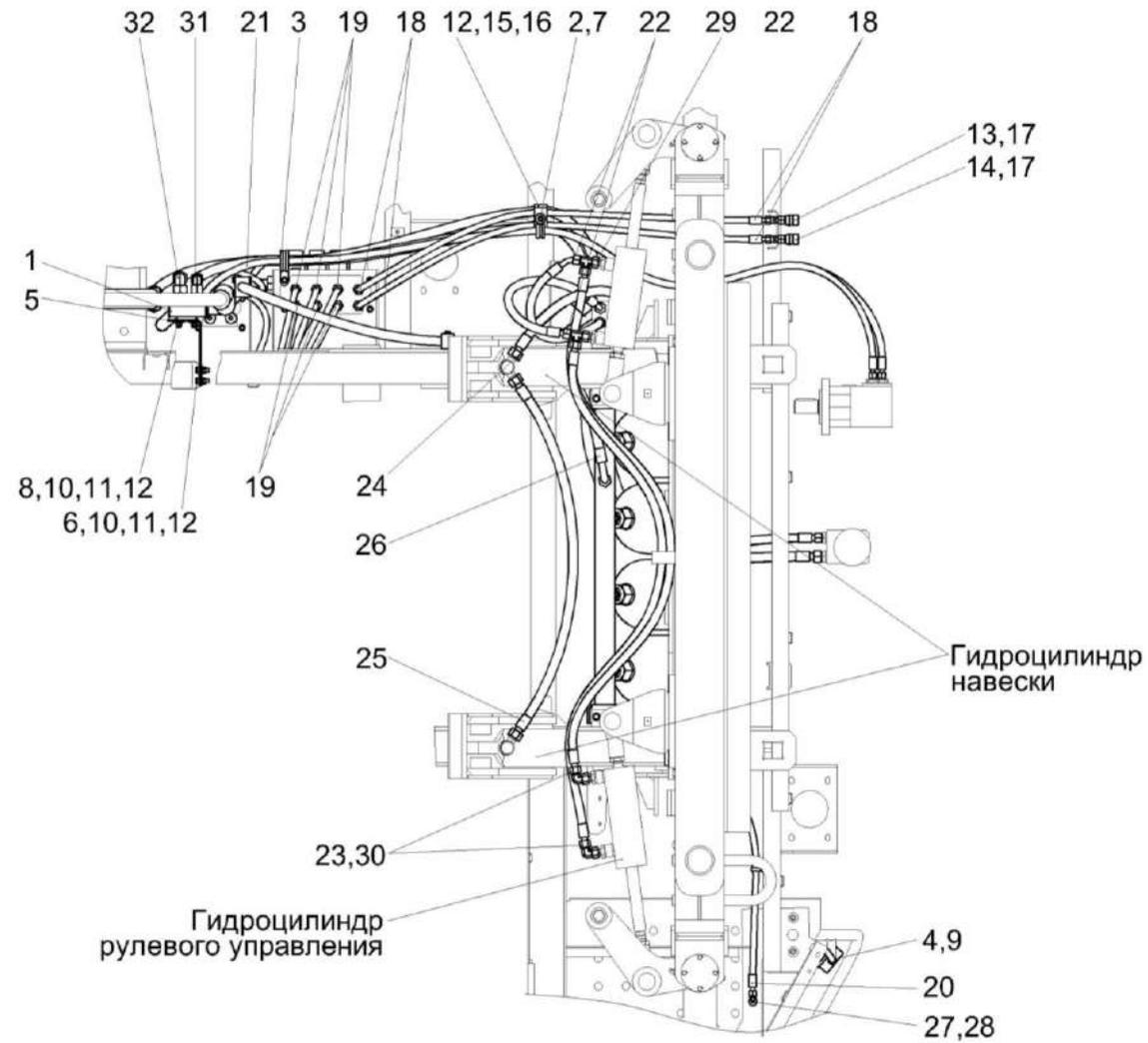
Рисунок 194 – Гидросистема рабочих органов и рулевого управления КСК-6025-0602000 (лист 2)
