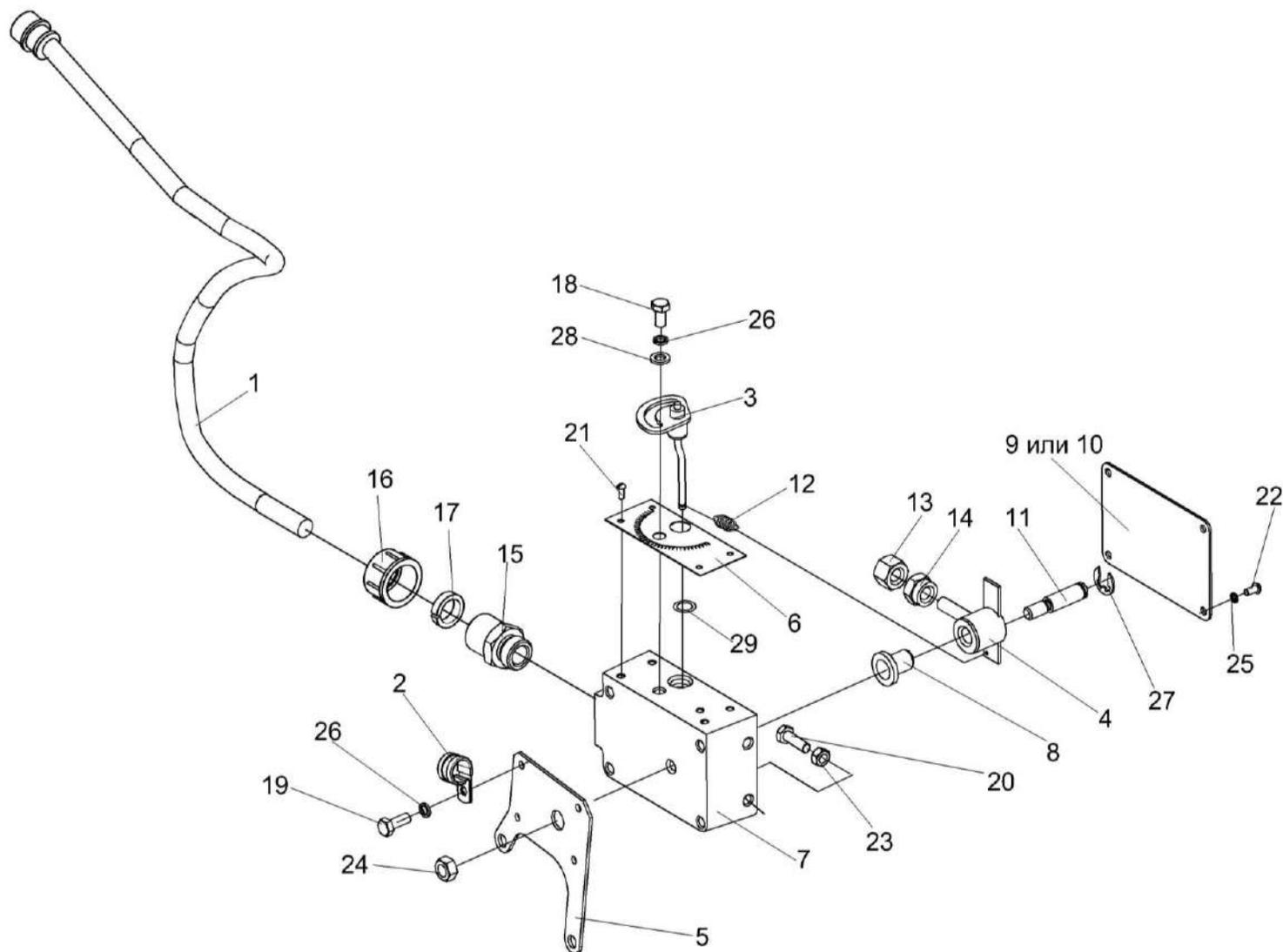
Рисунок 22 – Датчик камнедетектора КСК-6025-0151410
