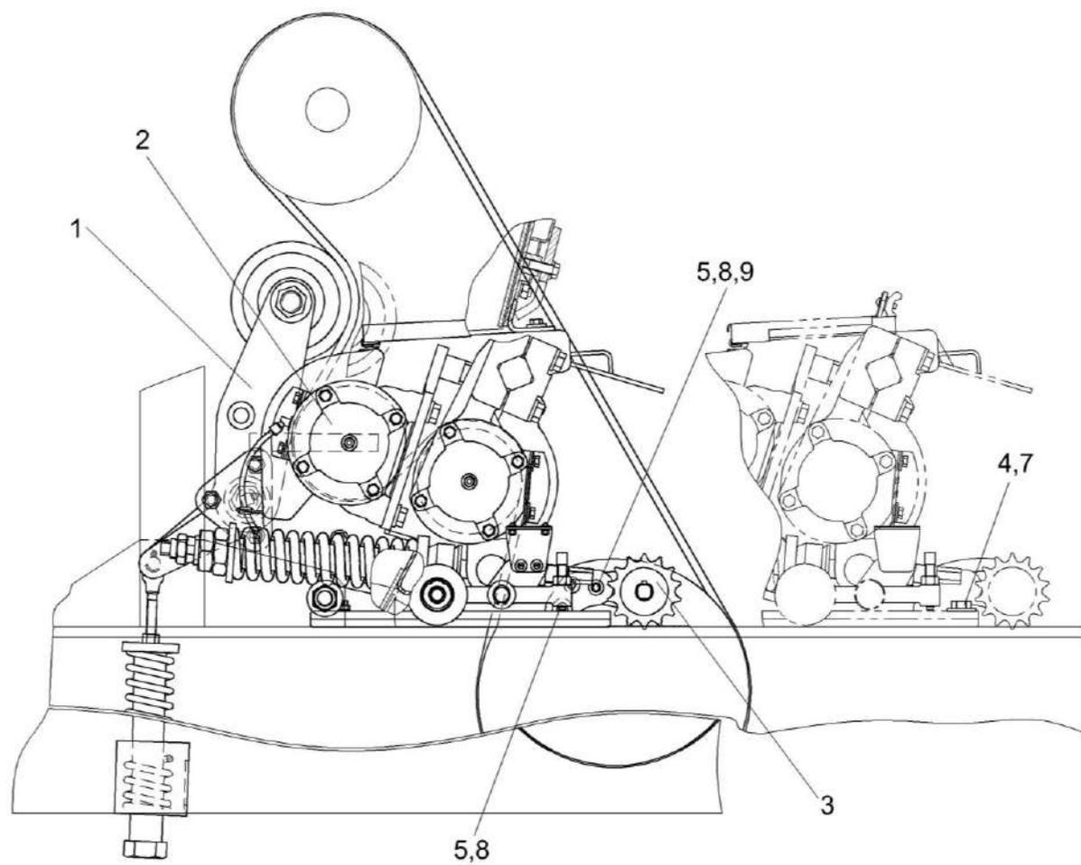
Рисунок 60 – Установка устройства доизмельчающего КСК-6025-0157000
