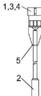
Рисунок 226 – Датчик оборотов КВК 0700770
