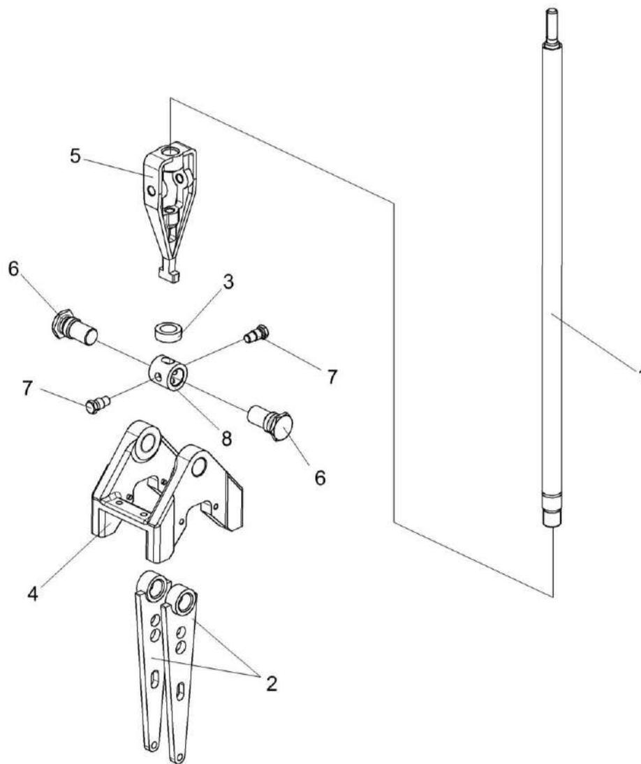
Рисунок 159 – Блок переключения КСК-6025-0119070
