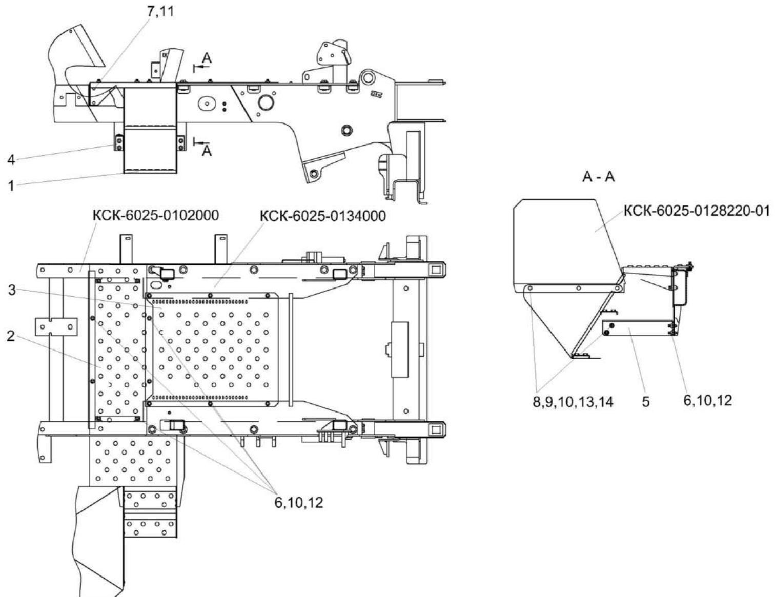
Рисунок 177 – Установка площадки обслуживания КСК-6025-0100400
