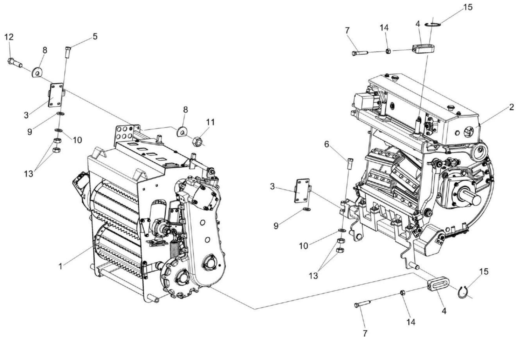
Рисунок 6 – Аппарат питающе-измельчающий КСК-6025-0150010
