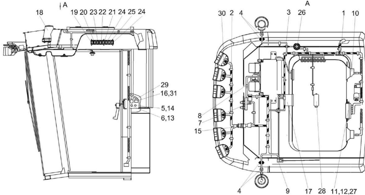
Рисунок 136 – Установка электрооборудования кабины КСК-6025-0722000
