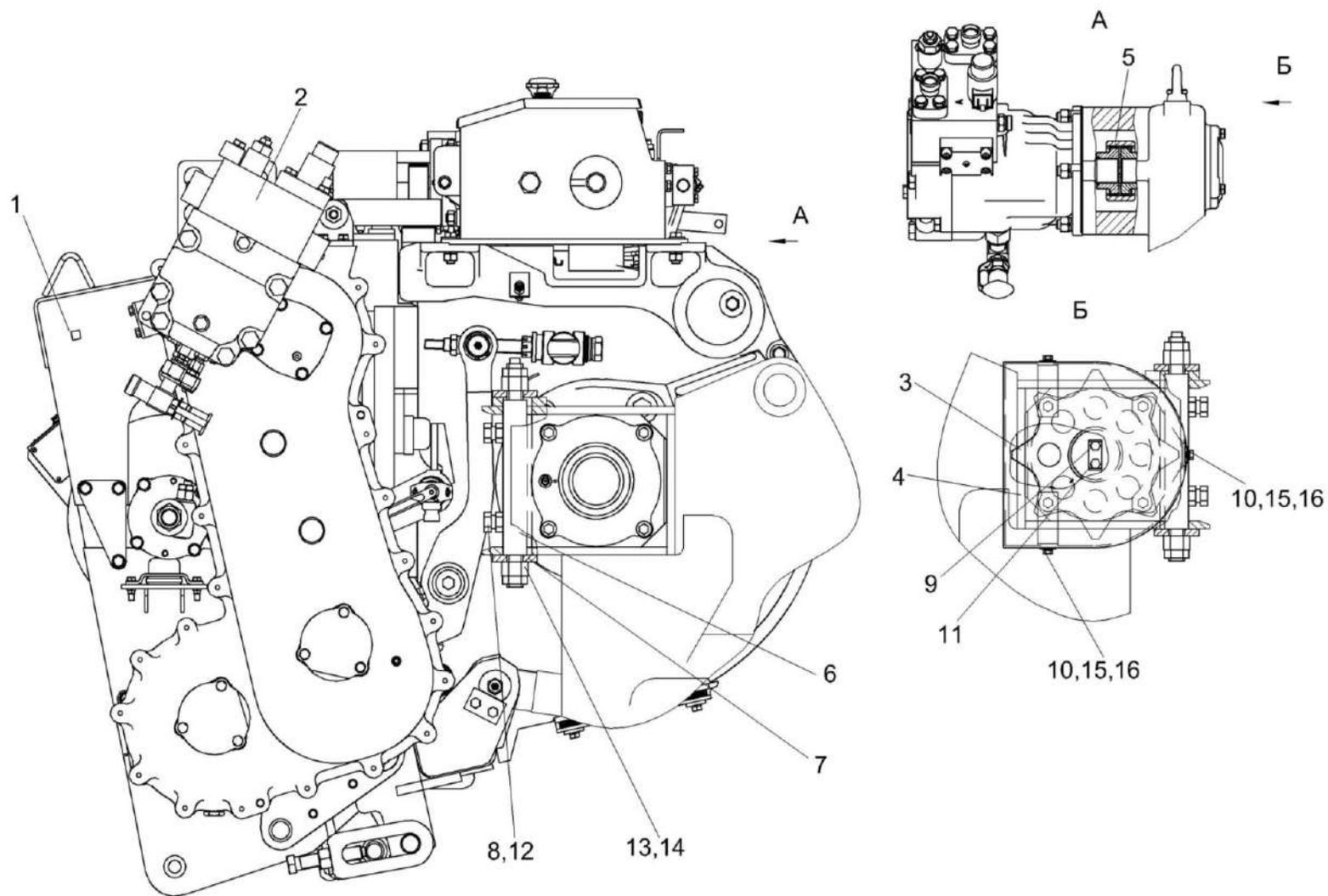
Рисунок 5 – Установка аппарата питающе-измельчающего КСК-6025-0150000
