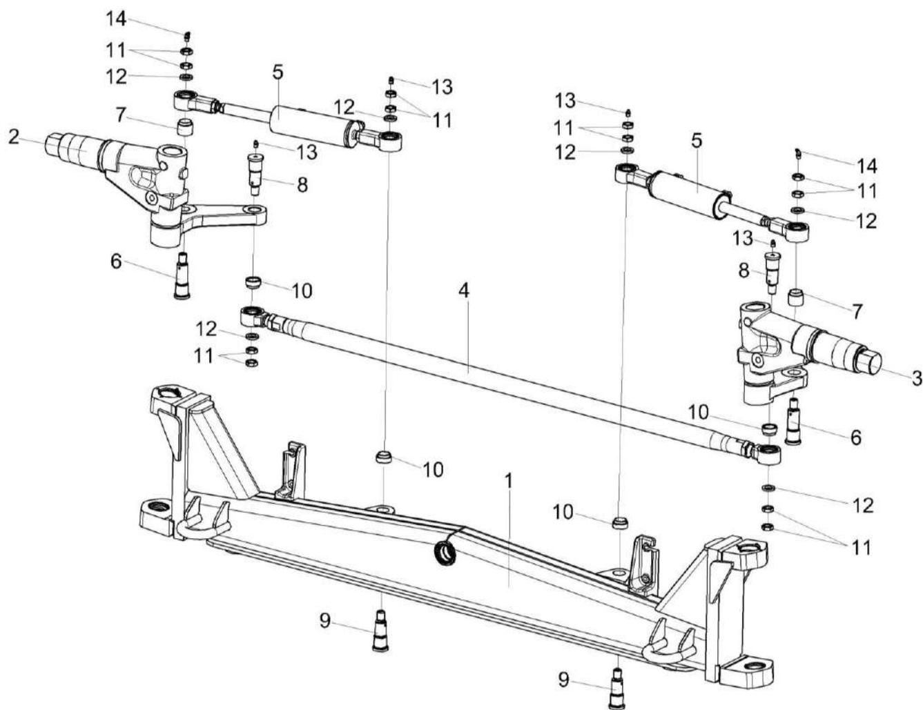
Рисунок 116 – Мост управляемых колес КСК-6025-0109000 (лист 2)
