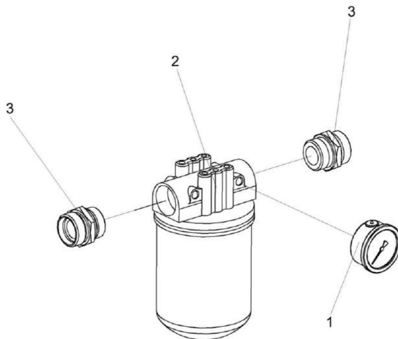
Рисунок 202 – Фильтр сливной КСК-6025-0602460
