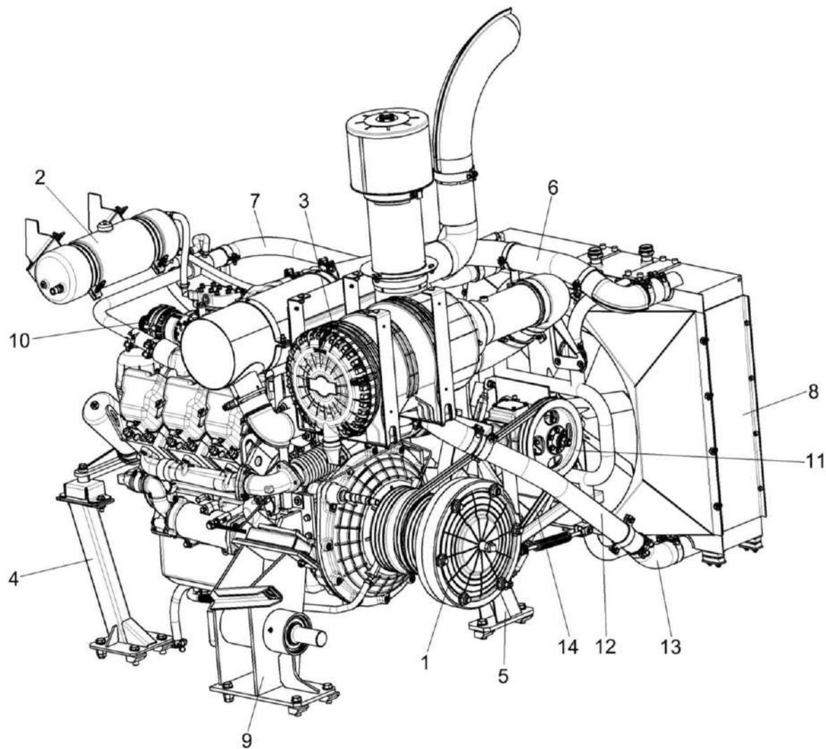
Рисунок 76 – Установка двигателя КСК-6025-0116000 (общий вид)
