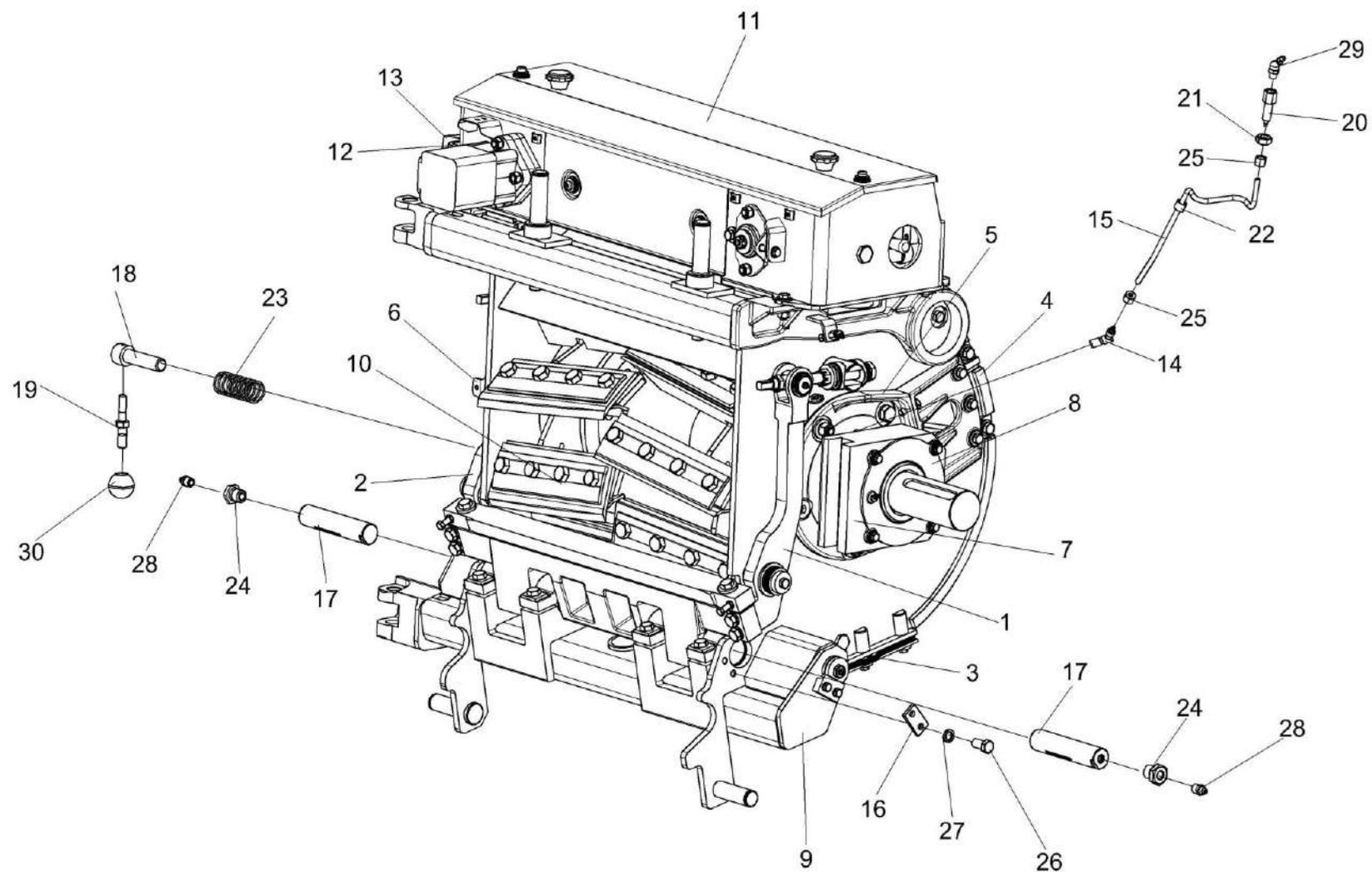
Рисунок 23 – Аппарат измельчающий КСК-6025-0153000
