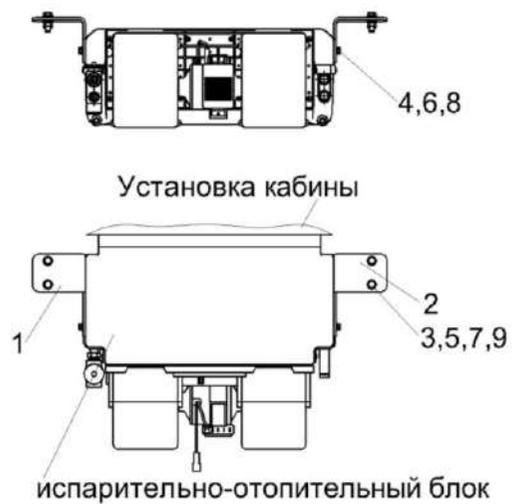
Рисунок 147 – Установка блока испарительно-отопительного КЗК-1420-0113060
