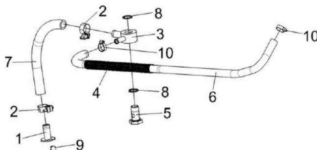
Рисунок 83 – Маслопровод сливной КСК-6025-0116350
