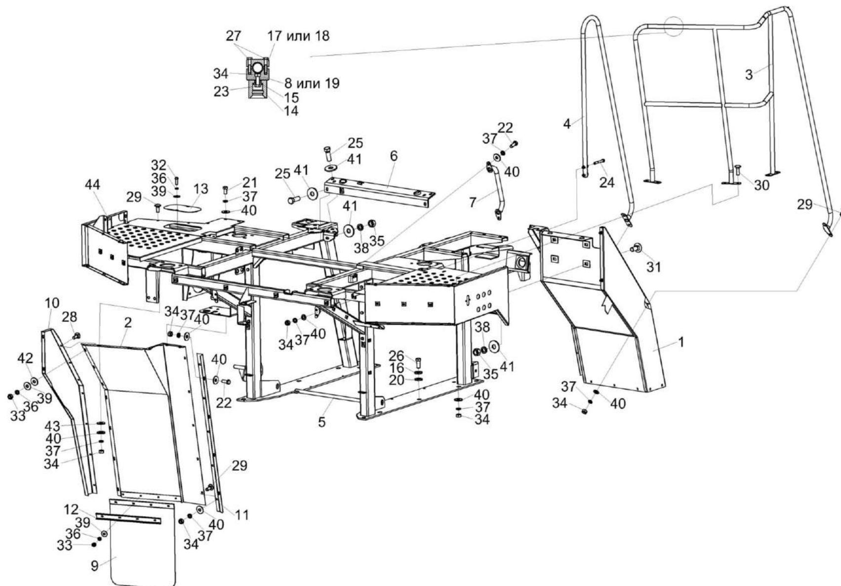
Рисунок 175 – Установка площадки входа КСК-6025-0134000
