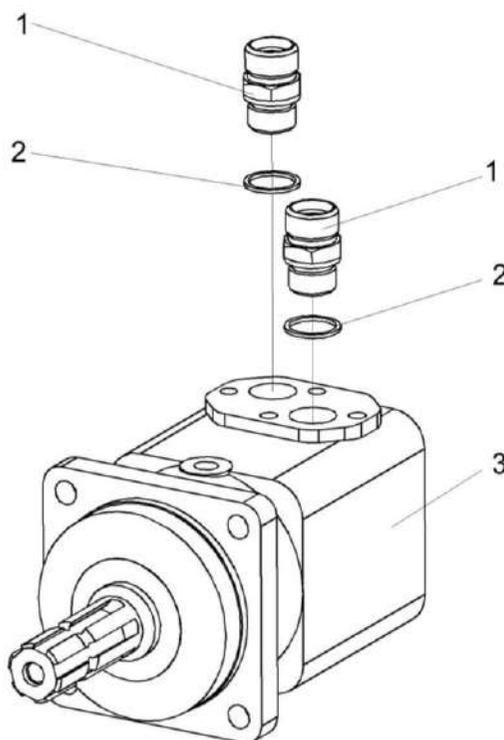
Рисунок 213 – Гидромотор привода адаптеров КГС 0115380
