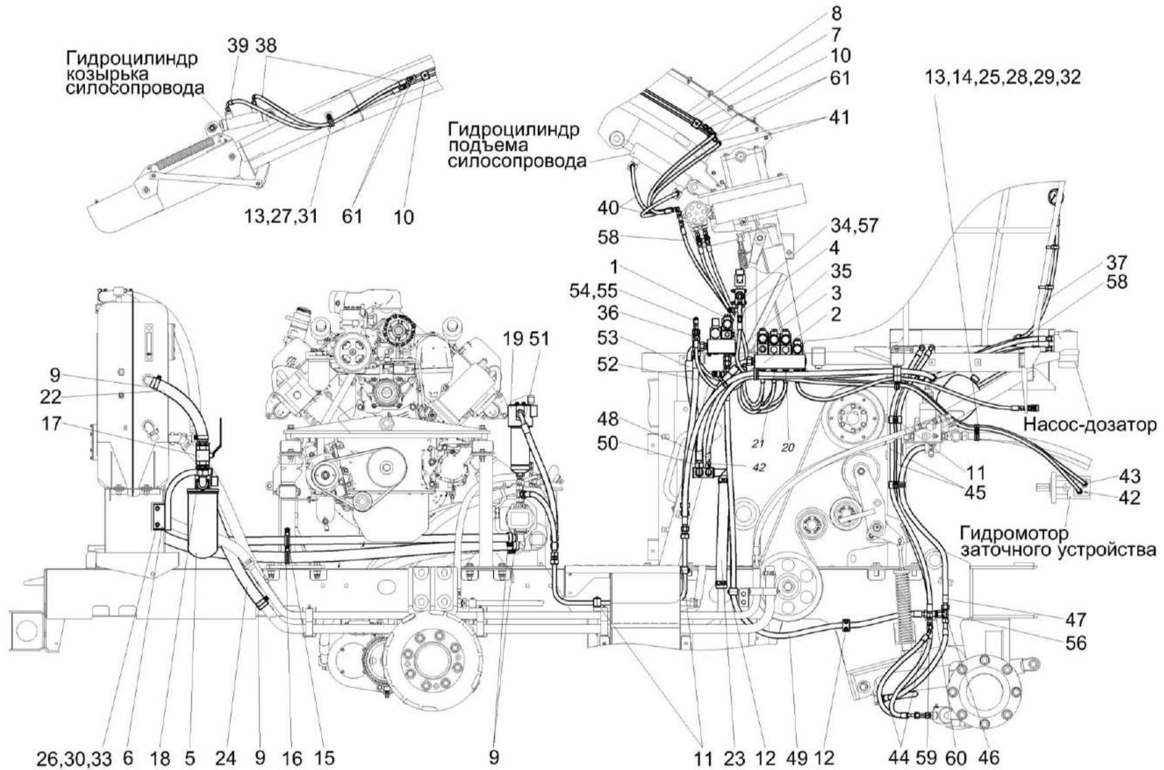
Рисунок 193 – Гидросистема рабочих органов и рулевого управления КСК-6025-0602000 (лист 1)
