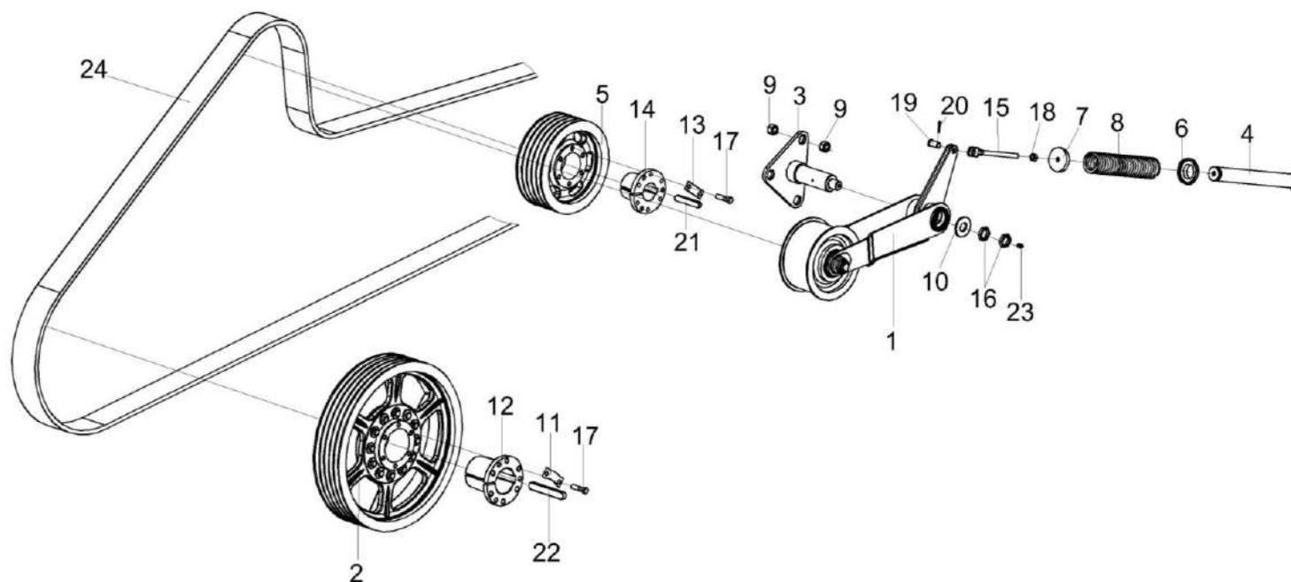
Рисунок 99 – Передача ременная КСК-6025-0131000 (лист 1)
