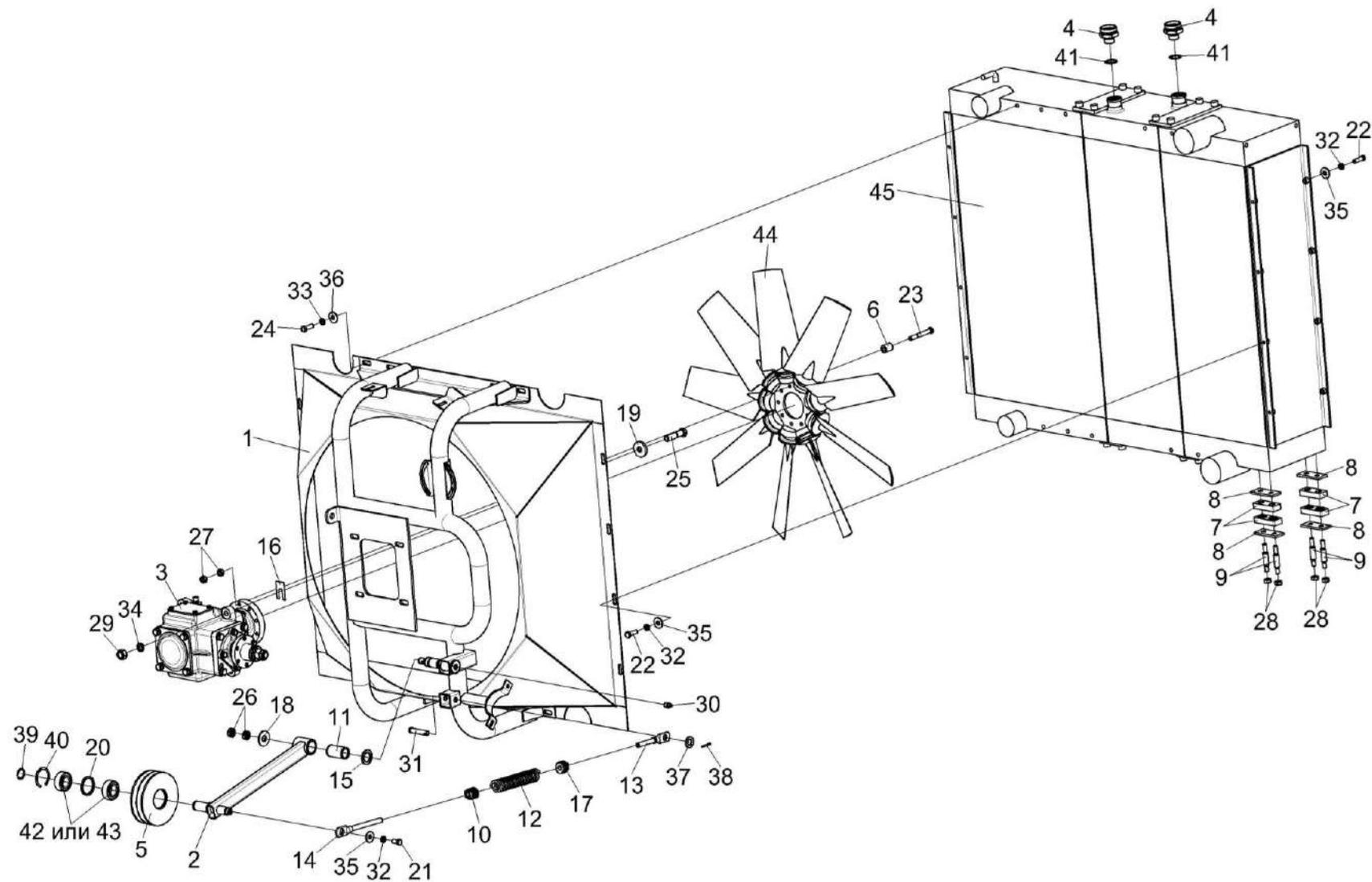
Рисунок 90 – Установка радиатора КСК-6025-0117000
