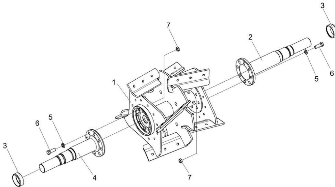
Рисунок 45 – Вал ускорителя выброса КСК-6025-0156220
