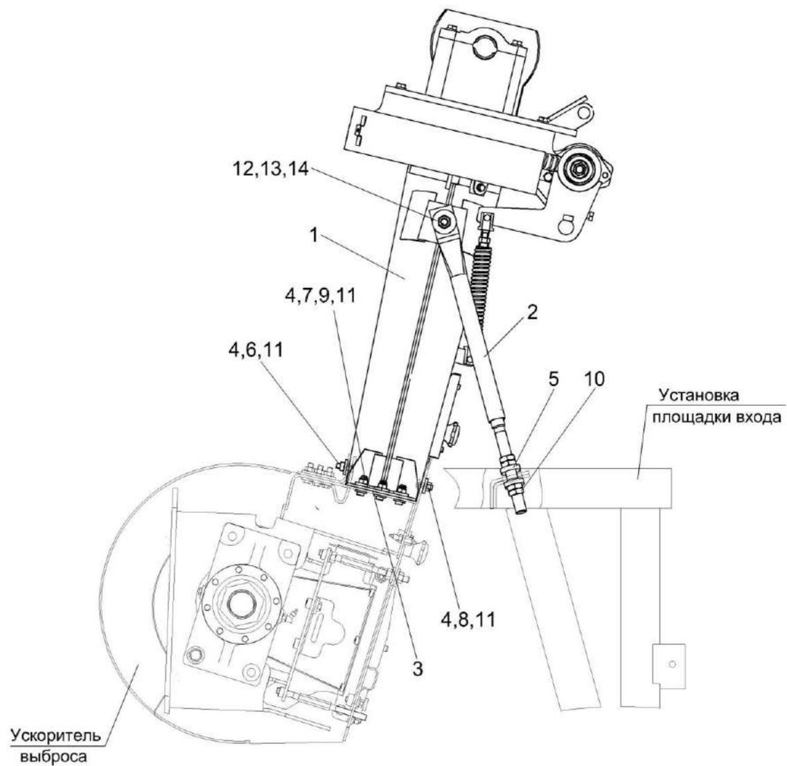
Рисунок 46 – Установка основания силосопровода КСК-6025-0158000
