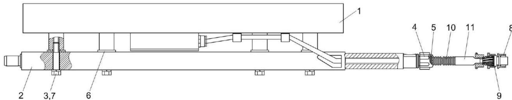
Рисунок 16 – Датчик металлодетектора КСК-6025-0701010
