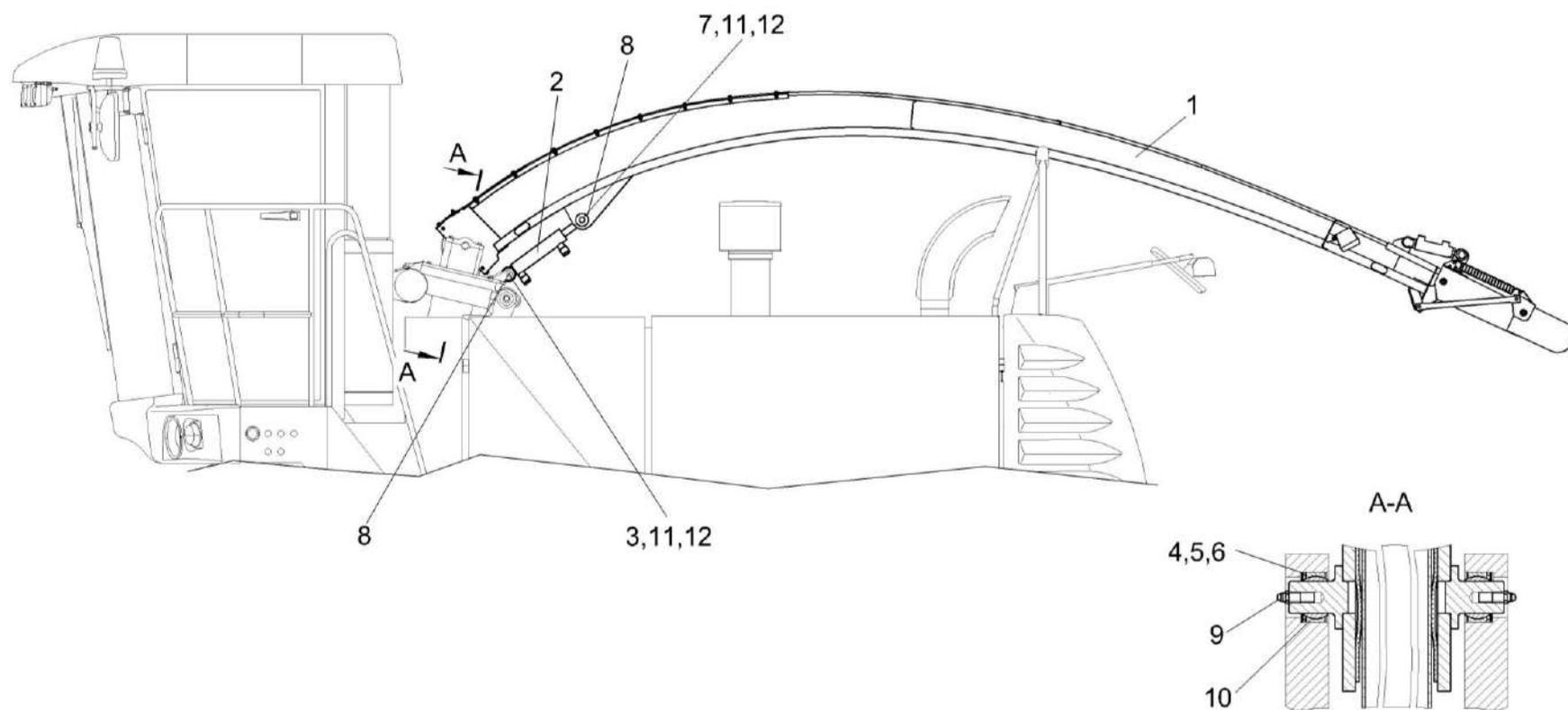
Рисунок 52 – Установка силосопровода КСК-6025-0169000
