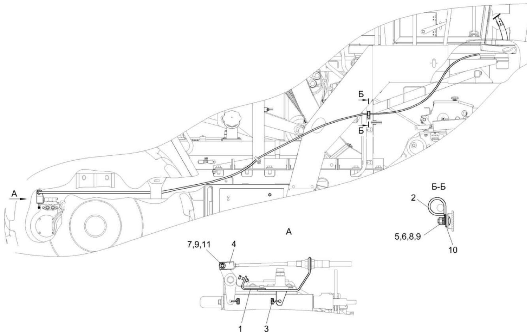
Рисунок 174 – Установка троса блокировки КСК-6025-0119660
