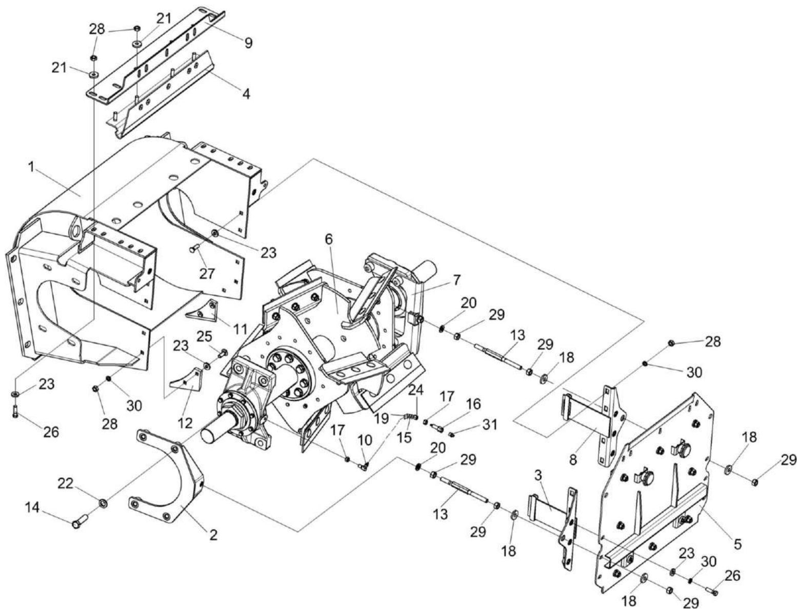
Рисунок 41 – Ускоритель выброса КСК-6025-01526000
