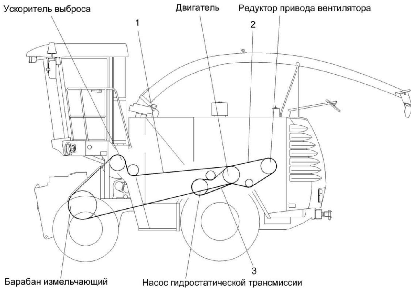
Рисунок 227 – Схема ременных передач самоходного измельчителя комбайна КВК-6025 (вид слева)
