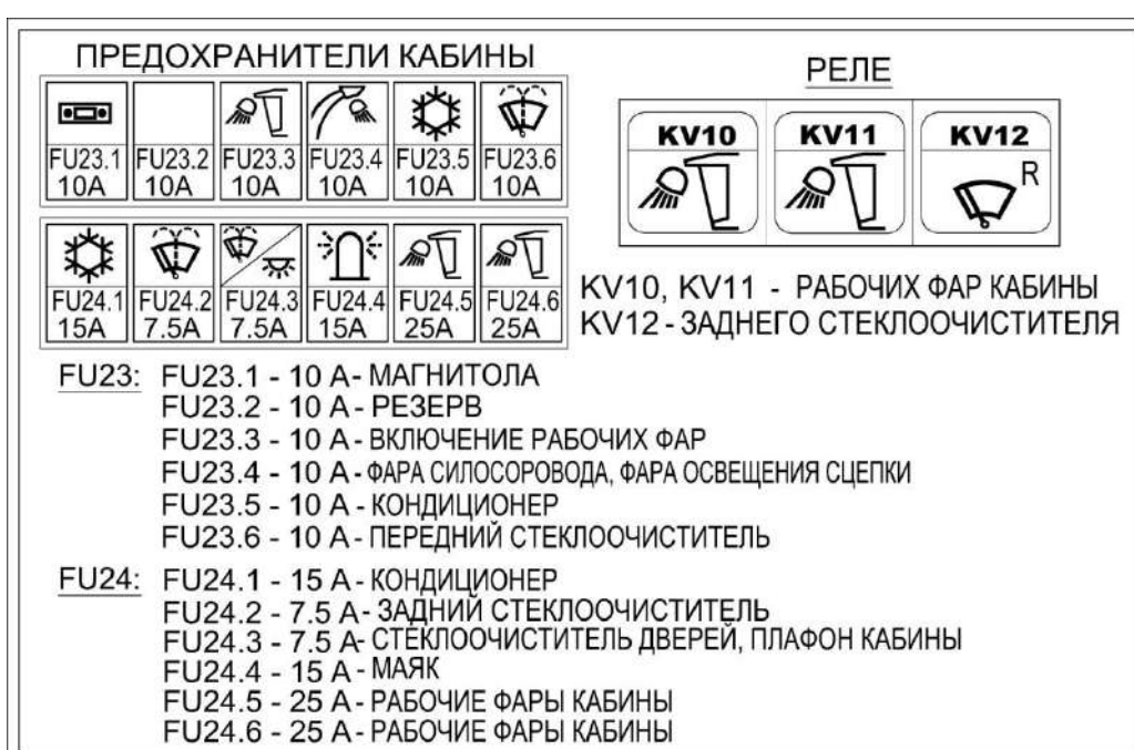
Рисунок 1.47 Блоки предохранителей
