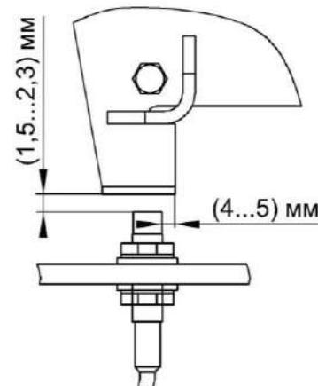
Рисунок 2.13– Установка датчика положения бруска абразивного
