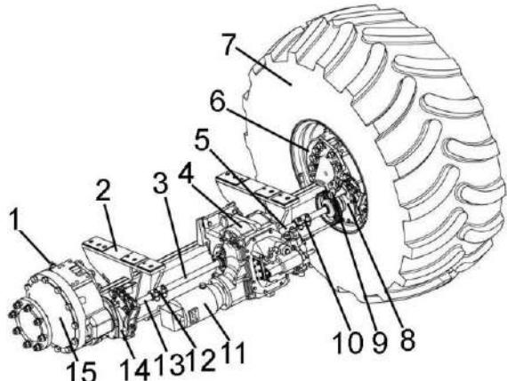
1 – сапун; 2 – балка моста; 3, 5, 13 – полуоси; 4 – коробка диапазонов; 6, 15 – бортовые редукторы; 7 – колесо; 8, 14 – муфты; 9 – датчик скорости измельчителя самоходного; 10, 12 – муфты соединительные; 11 – гидромотор
