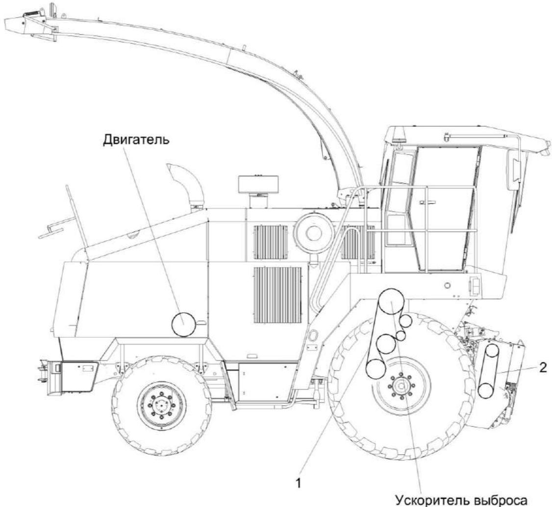
Рисунок Н.2 – Схема приводов измельчителя (вид справа)
