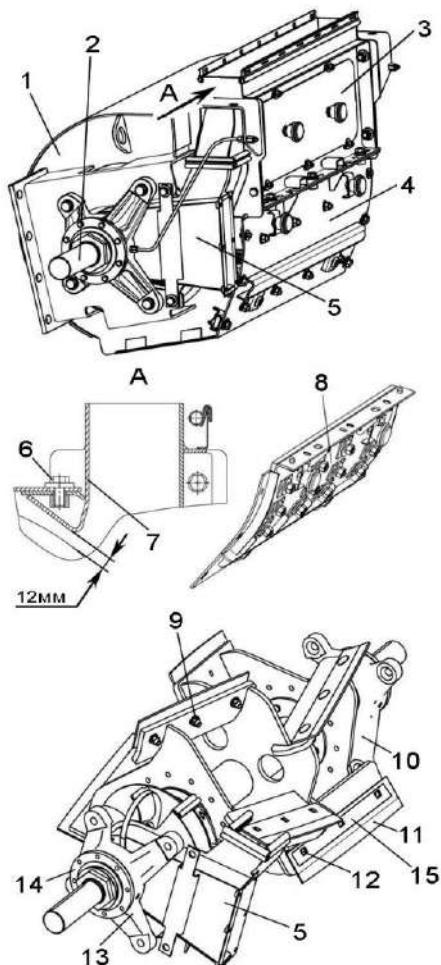
1 – корпус ускорителя; 2 – вал ускорителя выброса; 3 – стенка задняя; 4 – поддон; 5 – воздуховод; 6, 12 – болты; 7 – отсекатель; 8 – поддон бичевой; 9 – гайка; 10, 13 - корпуса; 11 – лопасть; 14 – крышка; 15 – накладка
