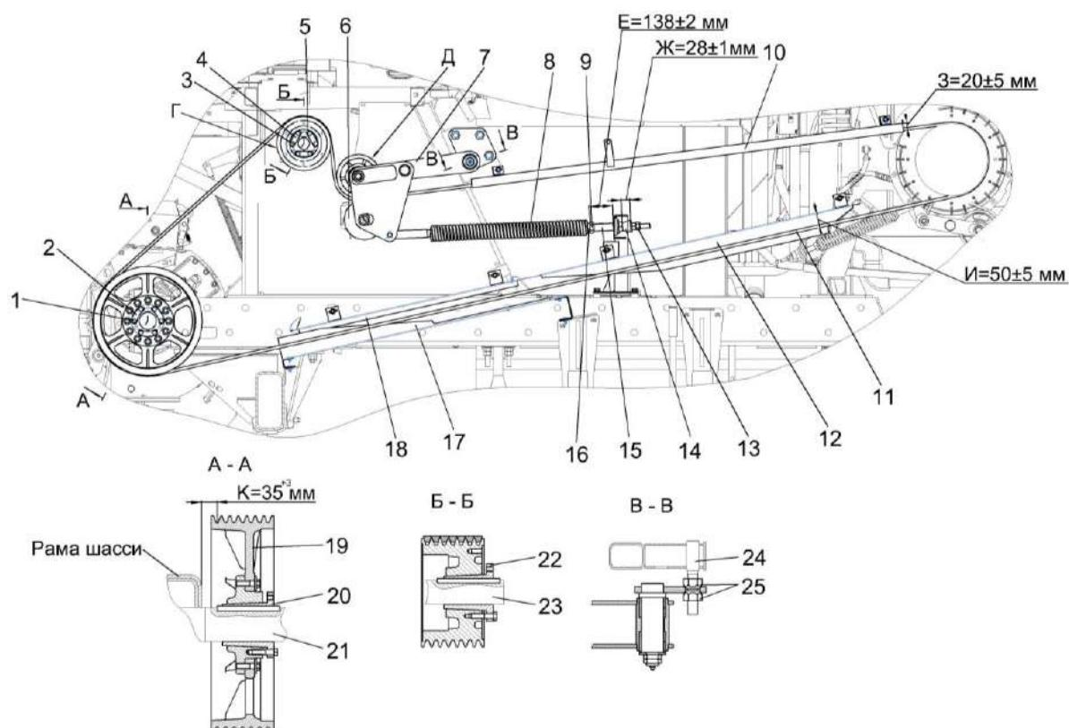
1,3 – болты; 2, 4 – пластины; 5,19 – шкивы; 6 – ролик; 7 – рычаг; 8 – пружина; 9, 13, 25 – гайки; 10, 12, 17, 18 – щитки; 11 – ремень; 14 – буфер; 15 – винт; 16 – пробка; 20, 22 – ступицы; 21,23 – валы; 24 – шпилька
