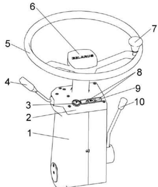
1 - кожух; 2, 6 – крышки; 3 – выключение аварийной сигнализации; 4 – подрулевой переключатель; 5 – колесо рулевое; 7 – ручка; 8 - контрольные лампы указателей поворотов; 9 - контрольная лампа дальнего света; 10 - рукоятка фиксации угла наклона колонки
