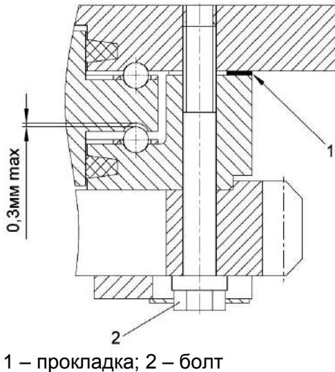
Рисунок 2.26 – Регулировка осевого люфта фланца
