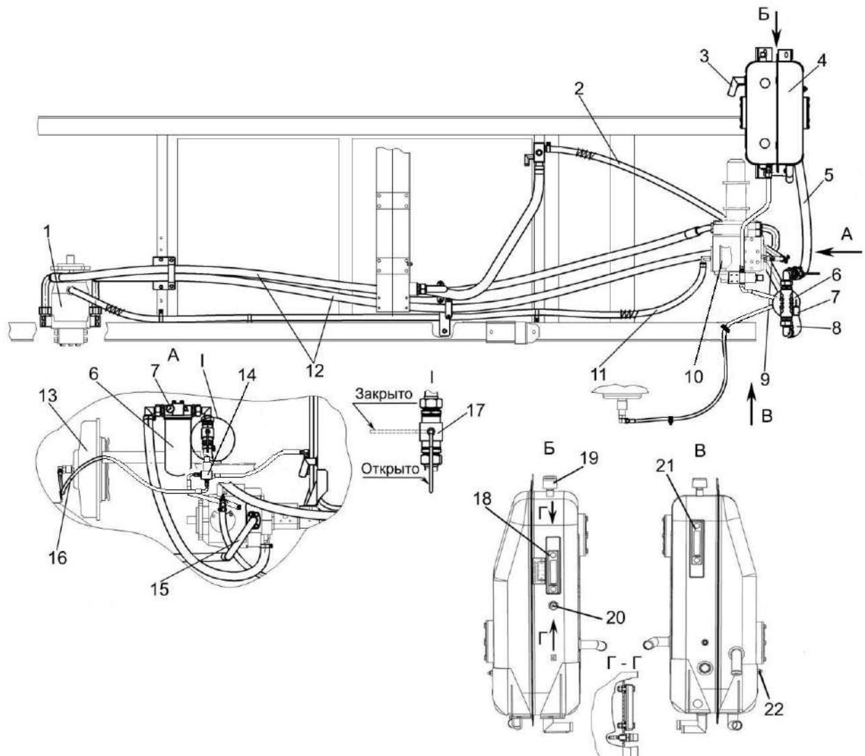
1 – гидромотор; 2, 11 – рукава; 3 – угольники; 4 - бак масляный; 5, 8 – рукава всасывающие; 6 – фильтр; 7 – вакуумметр; 9 - дроссель; 10 - гидронасос; 12, 15, 16 – рукава высокого давления; 13 – муфта включения главного привода; 14 – гидроблок включения главного привода; 17 – кран; 18 – маслоуказатель нижний; 19 – сапун; 20 – датчик аварийного уровня масла; 21 – маслоуказатель верхний; 22 – датчик аварийной температуры масла
