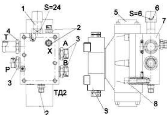
1 – клапан предохранительный; 2, 3, 4 – штуцера; 5, 9 – гидрораспределители; 6 – винт регулировочный предохранительного клапана; 7 – плита; 8 – винт
