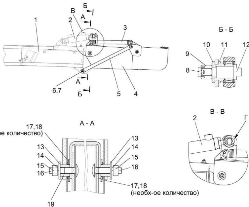
1 – силосопровод; 2 – гидроцилиндр; 3 – пружина; 4 – козырек; 5 – тяга; 6, 10, 13, 14, 17 – шайбы; 7, 8 – шплинты; 9, 15 – гайки; 11 – бонка; 12 – ось; 16 – болты; 18 – прокладки; 19 – втулки
