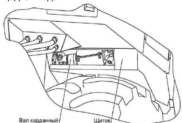
Рисунок 3.10 – Смазка шарниров карданного вала привода редуктора гидронасосов
