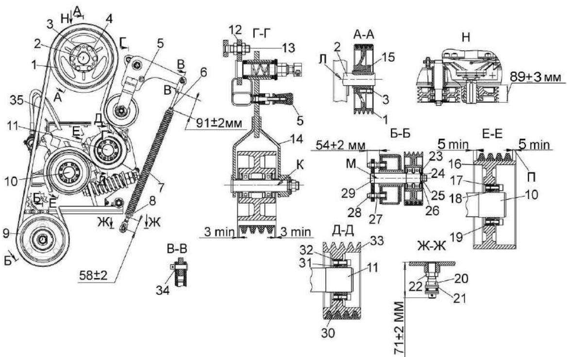
1, 33 – шкивы; 2 – вал ускорителя; 3 – болт; 4 – пластина; 5 – фиксатор; 6, 8, 13, 22, 28 – гайки; 7 – пружина; 9, 16 – ролики; 10 – вал вальца нижнего; 11 – вал вальца верхнего; 12, 29 – опоры; 14 – рычаг; 15, 18, 31 – ступицы; 17, 23, 32 – втулки; 19, 30 – винты; 20 – палец; 21, 26 – шайбы; 24 – гайка специальная; 25 – шайба специальная; 27 – шпилька; 34 – ось; 35 – ремень; К – ось рычага; Л – ось вала ускорителя; М – ось опоры
