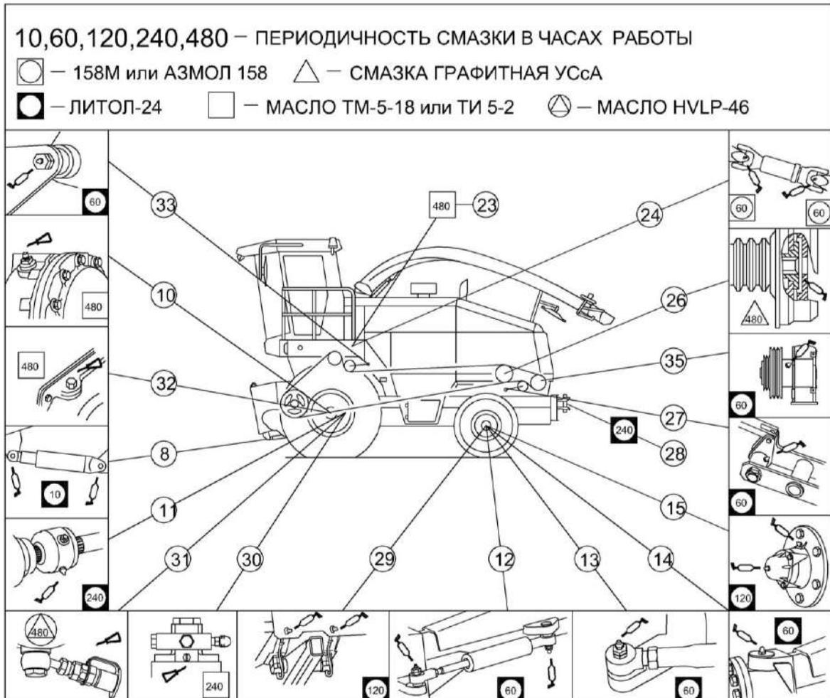
Рисунок 3.12 – Схема смазки измельчителя (вид слева)
