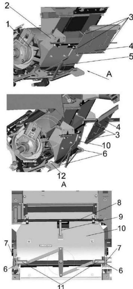
1 – барабан измельчающий; 2 – простоянка; 3 – фиксаторы быстросъемные; 4 – стенка съемная; 5 – механизм открытия приемной камеры; 6 – направляющие; 7 – фиксаторы; 8 – ось; 9 – рычаг; 10 – приемная камера; 11 – втулки; 12 – отверстия для фиксации
