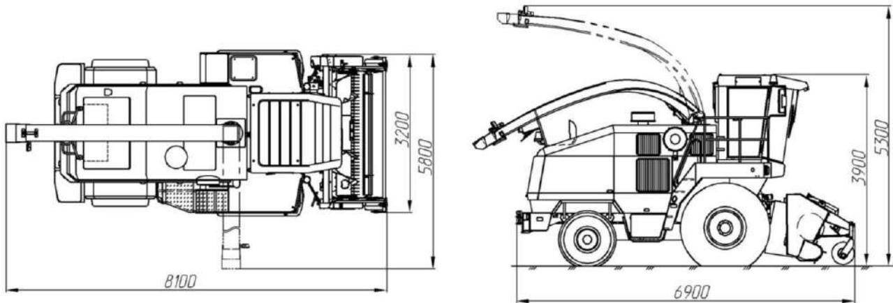
Рисунок 1.1 – Габаритные размеры комплекса с подборщиком
