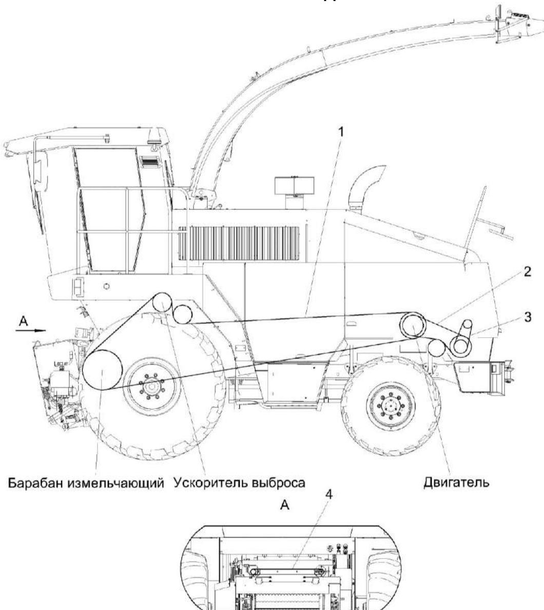
Рисунок Н.1 – Схема приводов измельчителя (вид слева)
