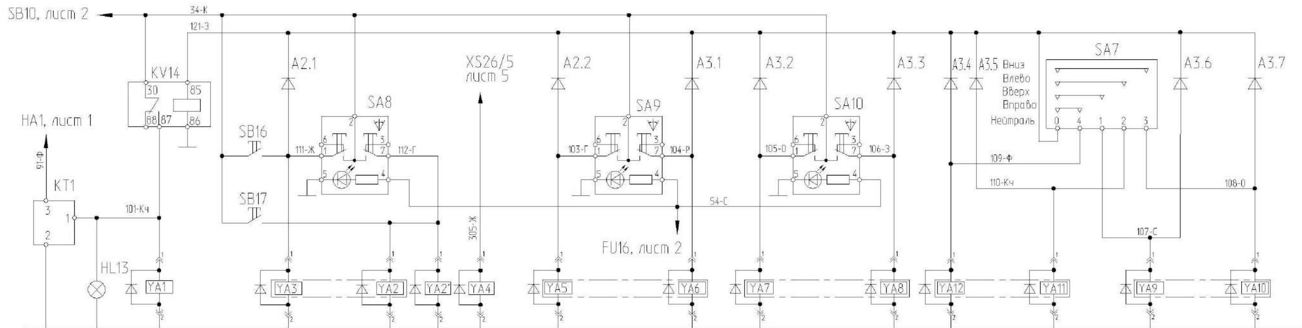
Порядок срабатывания электромагнитов гидроблоков ГБ1 и ГБ2
