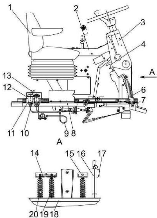
1 – сиденье; 2 – пульт управления; 3 – рулевая колонка; 4 – рукоятка стояночного тормоза; 6 – чехол; 7 – площадка; 8 – кронштейн сиденья; 9 – трубопровод; 10 – шпилька; 11 – бачок главного цилиндра тормоза; 12, 16, 17 – крышки; 13 – гайка; 14 – пластина; 15 – педаль управления блокировкой коробки диапазонов; 18 – коврик; 19, 20 – педали управления тормозами
