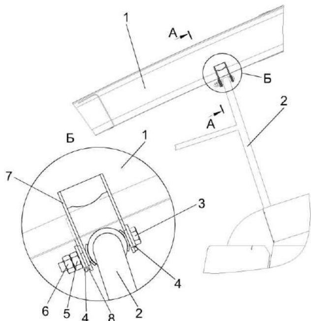
1 – силосопровод; 2 – стойка; 3 – болт; 4 – шайбы; 5 – гайки; 6 – контргайка; 7, 8 – кронштейны
