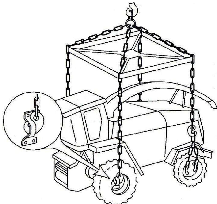
Рисунок 6.1 – Схема строповки
