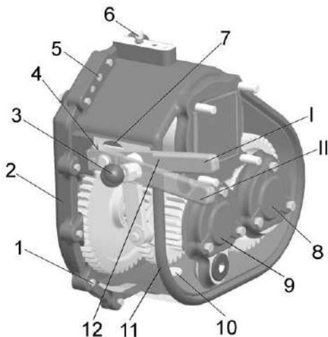
1 – болт; 2, 11 – корпуса; 3 – ручка шаровая; 4 - клеммовое соединение; 5 - штифт; 6 – сапун; 7 - пробка; 8- крышка вала привода нижних вальцев; 9 - крышка промежуточного вала; 10 – пробка сливная; 12 - рычаг переключения передач
