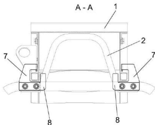
Рисунок 2.4 – Механизм фиксации силосопровода
