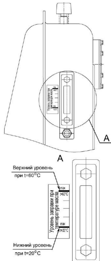
Рисунок 2.6 – Заправка гидросистем
