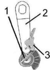
1 – замок зажигания; 2 – ключ специальный для открывания капотов; 3 – ключ зажигания
