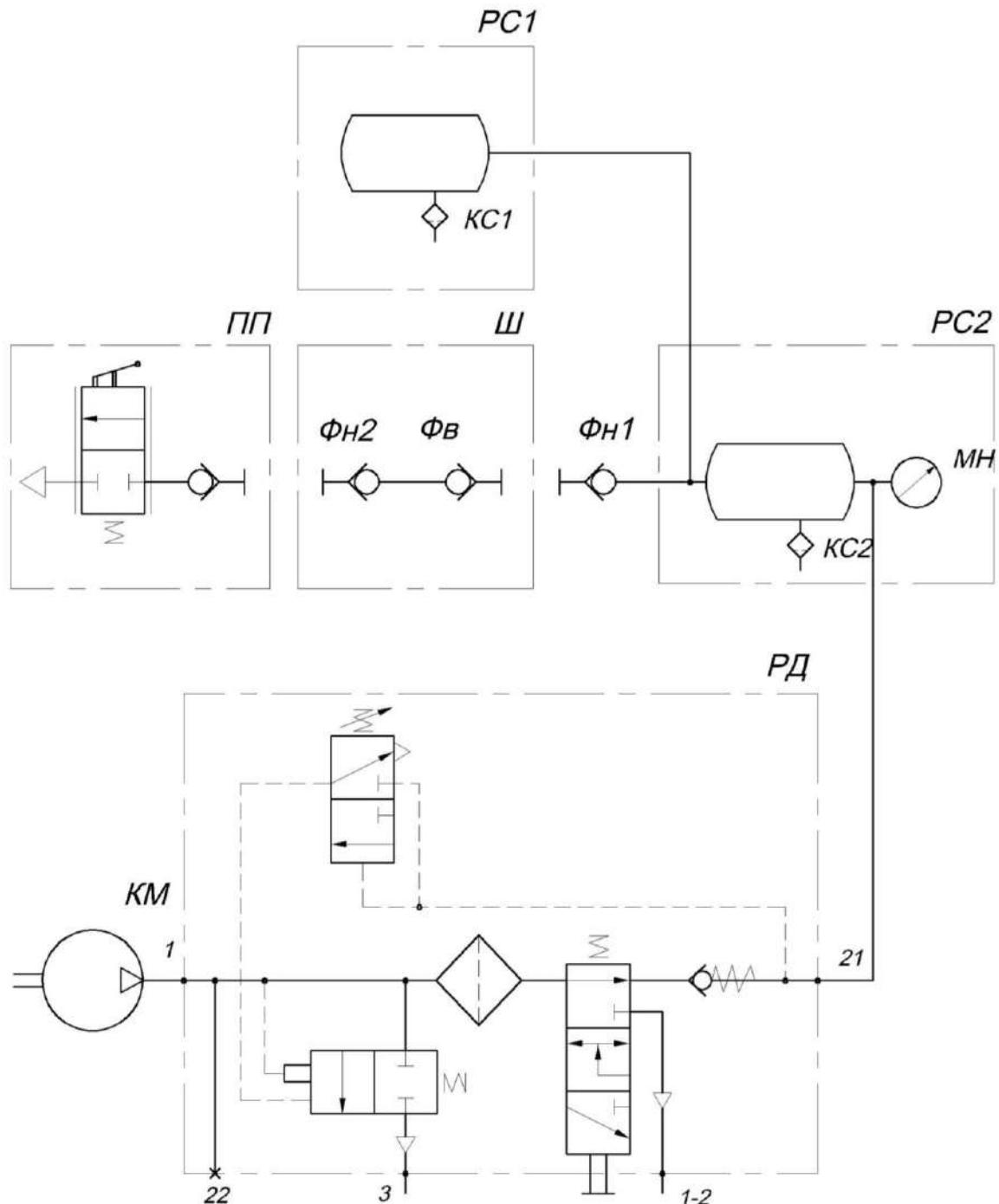
KM – компрессор; PC1, PC2 – ресиверы ( $V=40\text{дм}^3$ ); К – клапан; KC1, KC2 – кран слива конденсата; MH – манометр; Фн1, Фн2, Фв - фитинги; Ш – шланг; ПП – пневмопистолет обдувочный; РД – регулятор давления
