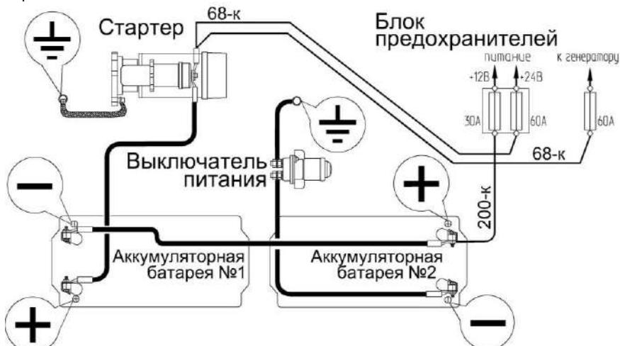
Рисунок 2.3 – Схема подключения аккумуляторных батарей
