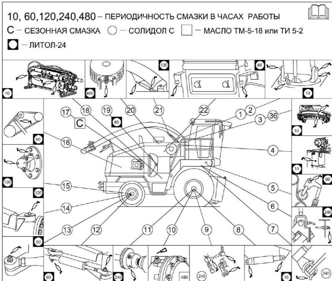
Рисунок 3.11 – Схема смазки измельчителя (вид справа)
