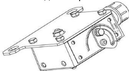
Рисунок 2.7 – Датчик камнедетектора
