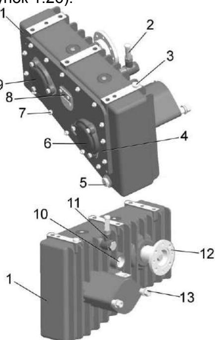
1 - корпус; 2 - сапун; 3 - маслоуказатель; 4, 6, 9 – крышки; 5 - пробка; 7 - болт; 8 – упор; 10 - ось; 11 – угольник; 12 - фланец; 13 - гайка
