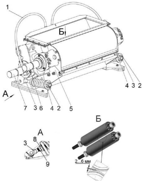
1 – гидросистема регулировки зазора; 2, 9 – гайки; 3 – тяга; 4 – гильза; 5 – корпус; 6 – валец верхний; 7 – валец нижний; 8 – упор
