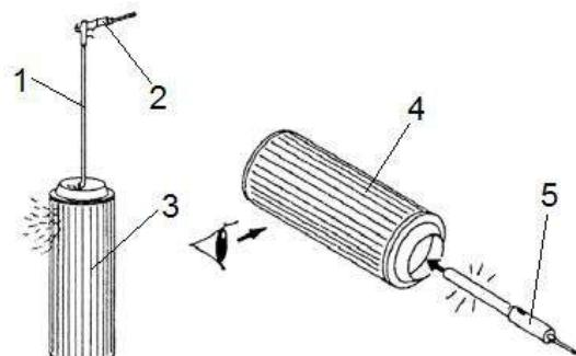
1 – трубка; 2 - пневмопистолет; 3,4 – основной фильтрующий элемент; 5 – лампа
