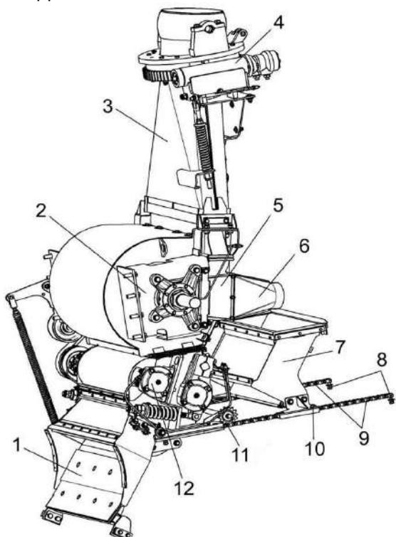
1 – камера приемная; 2 – ускоритель выброса; 3 – основание силосопровода; 4 – механизм поворота силосопровода; 5 – воздуховод; 6 – переходник; 7 – проставка; 8, 10 – болты; 9 – цепь; 11 – механизм перемещения; 12 - устройство доизмельчающее
