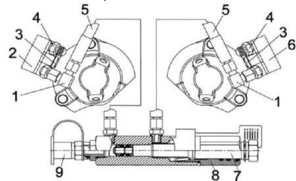
1 – угольник; 2, 6 – толкатели; 3 – поршень; 4 – клапан перепускной; 5 – рукав; 7 – шток; 8 – цилиндр; 9 - полумуфта
