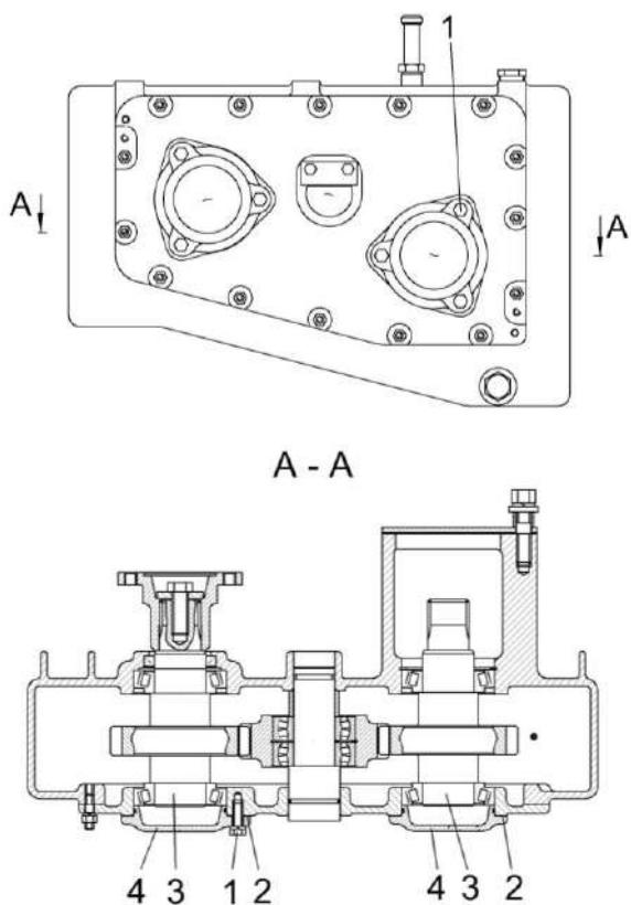
1 – болты; 2 - прокладки; 3 – вал-шестерня; 4 – крышка
