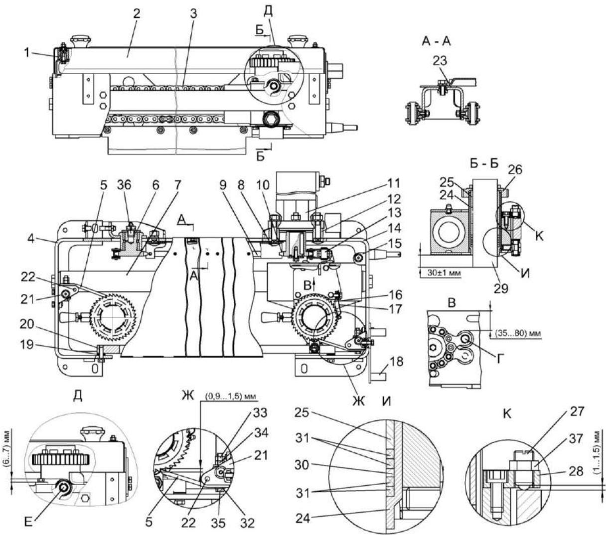
1 – обойма; 2 – крышка; 3, 13 – цепь; 4, 8, 14, 15, 18 – кронштейны; 5 – упор; 6, 10 – звездочки; 7, 9, 20 – направляющие; 11 – гидромотор заточного устройства; 12 – фланец; 16 – каретка; 17 – прижим; 19 – пластина стопорная; 21 – опора; 22 – ось; 23 – ограждение; 24 – втулка резьбовая; 25 – втулки; 26 – колесо храповое; 27 – устройство стопорное; 28 – планка; 29 – бруск абразивный; 30 – кольцо; 31 – кольца резиновые; 32 – шайба; 33, 37 – контргайки; 34 – гайка; 35 – болт; 36 – штуцер
