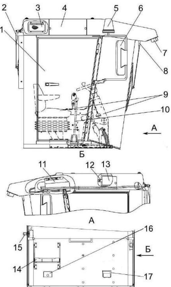
1 – дверь; 2 – задний стеклоочиститель; 3 – клапан; 4 – крышка; 5 – маяк проблесковый; 6 – зеркало; 7 – рабочие фары; 8 – передний стеклоочиститель; 9 – площадка управления; 10 – рычаг переключения передач; 11 – испаритель; 12 – прижим; 13 – фильтр; 14 – дополнительное сиденье; 15 – ручка дверная; 16 – аптечка; 17 – место для документации
