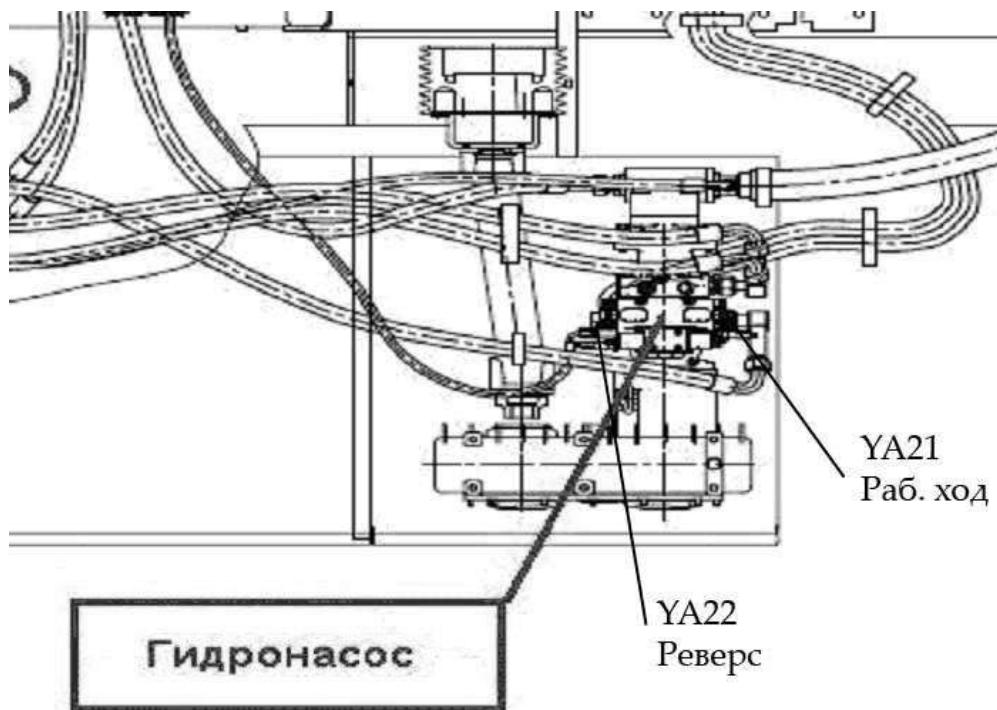
Рисунок М.2 - Расположение магнитов гидронасоса
