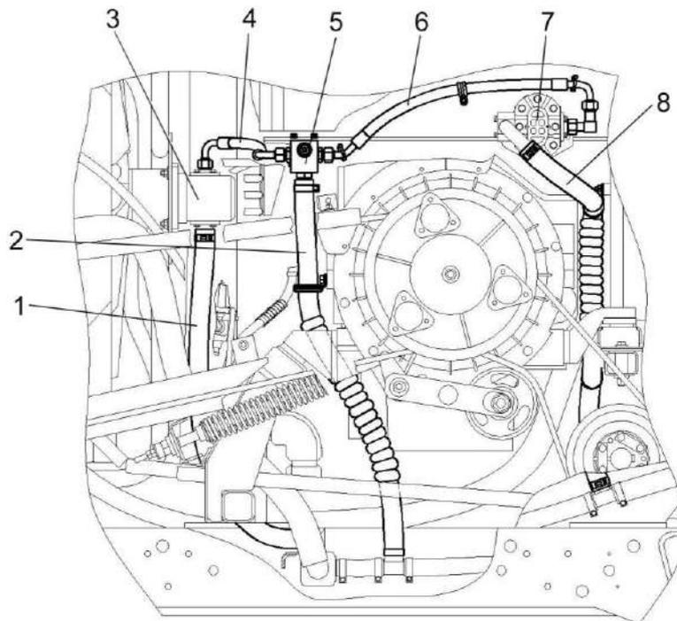
1, 2, 4, 6, 8 - рукава; 3 – гидромотор привода вентилятора; 5 - гидроблок привода вентилятора; 7 - гидронасос привода вентилятора.
