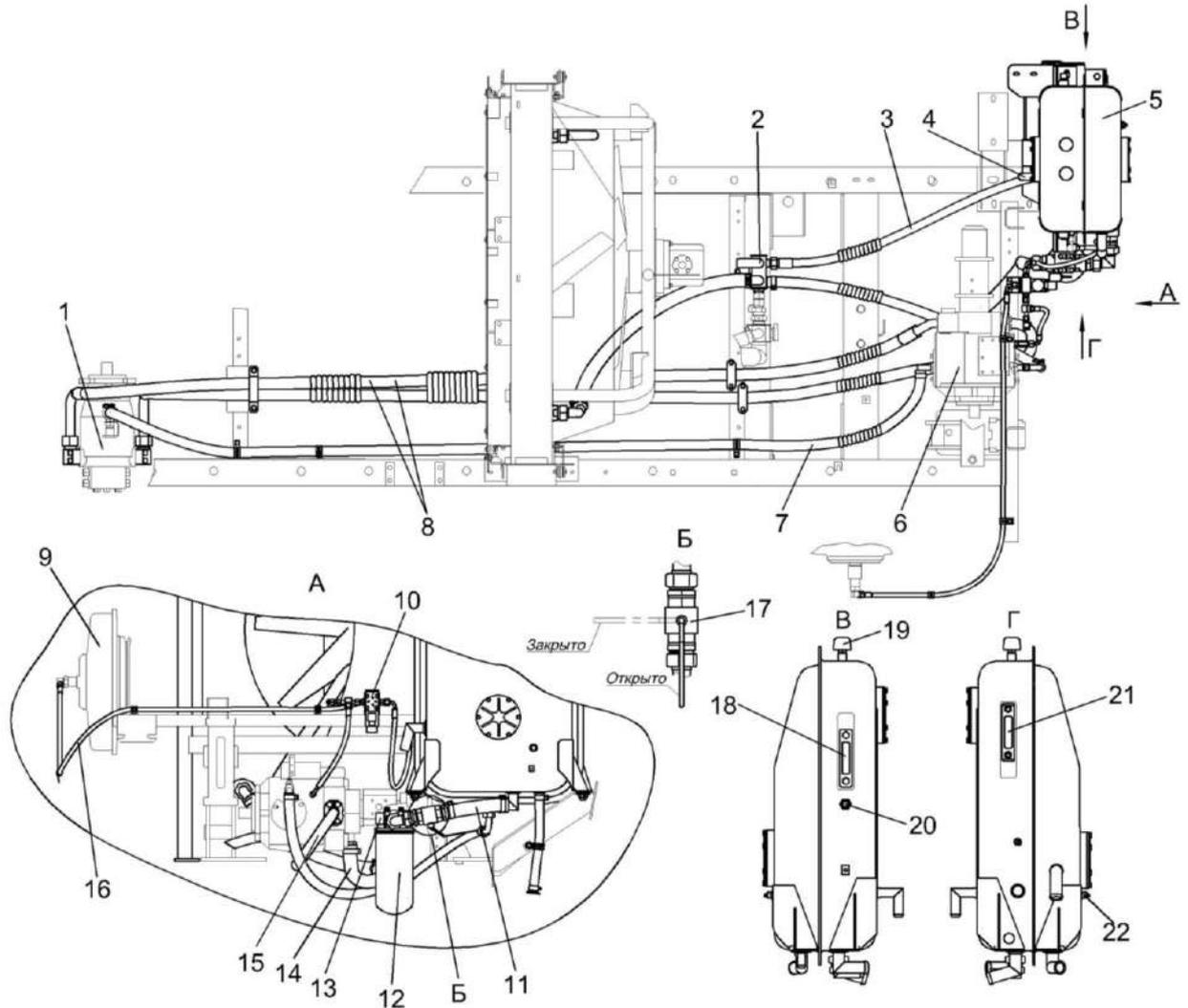
1 – гидромотор; 2 – коллектор; 3, 7 – рукава; 4 – угольник; 5 - бак масляный; 6 – гидронасос; 8 15, 16 – рукава высокого давления; 9 – муфта включения главного привода; 10 – гидроблок включения главного привода; 11, 14 – рукава всасывающие; 12 – фильтр; 13 – вакуумметр; 17 – кран; 18 – маслоуказатель нижний; 19 – сапун; 20 – датчик аварийного уровня масла; 21 – маслоуказатель верхний; 22 – датчик аварийной температуры масла
