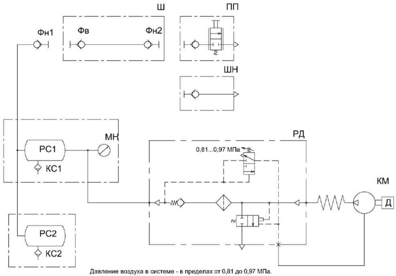
КМ – компрессор; КС1, КС2 – кран слива конденсата; МН – манометр; ПП – пневмопистолет обдувочный; РД – регулятор давления; РС1, РС2 – ресиверы ( $V=40\text{дм}^3$ ); ФН1, ФН2, ФВ - фитинги; Ш – шланг; ШН – шланг для накачивания шин
