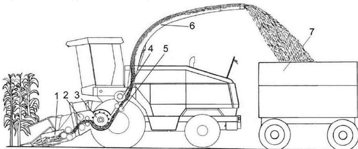
1 – жатка для грубостебельных культур; 2 – аппарат питающий; 3 – аппарат измельчающий; 4 – ускоритель выброса массы; 5 – устройство доизмельчающее; 6 – силосопровод; 7 – транспортное средство
