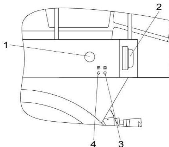
1 – боковой повторитель указателя поворотов; 2 – фара транспортная; 3 – кнопка опускания адаптеров; 4 – кнопка подъема адаптеров
