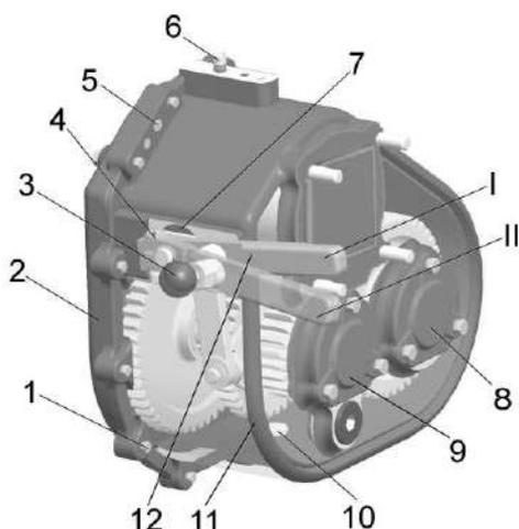
1 – болт; 2, 11 – корпуса; 3 – ручка шаровая; 4 - клеммовое соединение; 5 - штифт; 6 – сапун; 7 - пробка; 8- крышка вала привода нижних валцов; 9 - крышка промежуточного вала; 10 – пробка сливная; 12 - рычаг переключения передач
