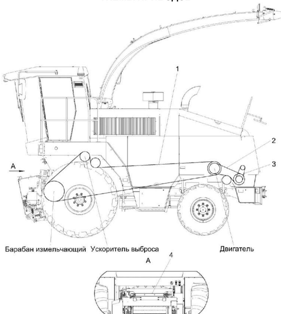
Рисунок М.1 – Схема приводов комбайна (вид слева)
