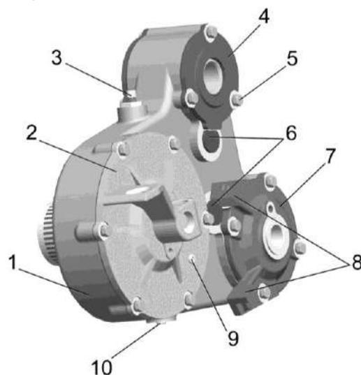
1- корпус; 2, 4, 7 – крышки; 3 – сапун; 5 - болт; 6 - оси; 8 - ограничители угла поворота рычага верхних валцов; 9 – пробка контрольная; 10 – пробка сливная
