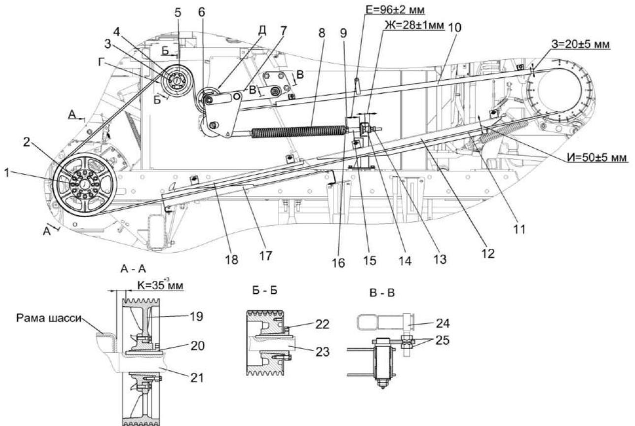
1, 3 – болты; 2, 4 – пластины; 5, 19 – шкивы; 6 – ролик; 7 – рычаг; 8 – пружина; 9, 13, 25 – гайки; 10, 12, 17, 18 – шитки; 11 – ремень; 14 – буфер; 15 – винт; 16 – пробка; 20, 22 – ступицы; 21, 23 – валы; 24 – шпилька
