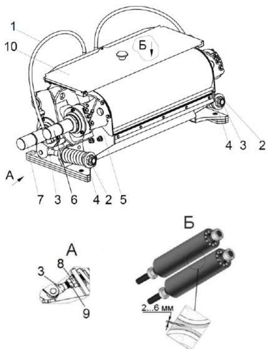
1 – гидросистема регулировки зазора;
