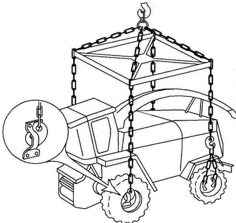
Рисунок 6.1 – Схема строповки
