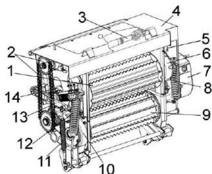
1 – валец верхний передний; 2 – передача цепная; 3 – вал карданный; 4 – корпус; 5 – датчик камнедетектора; 6 – редуктор верхних валцов; 7 – коробка передач; 8, 11, 12 – пружины; 9 – валцы нижние; 10 – редуктор нижних валцов; 14 - валец верхний задний
