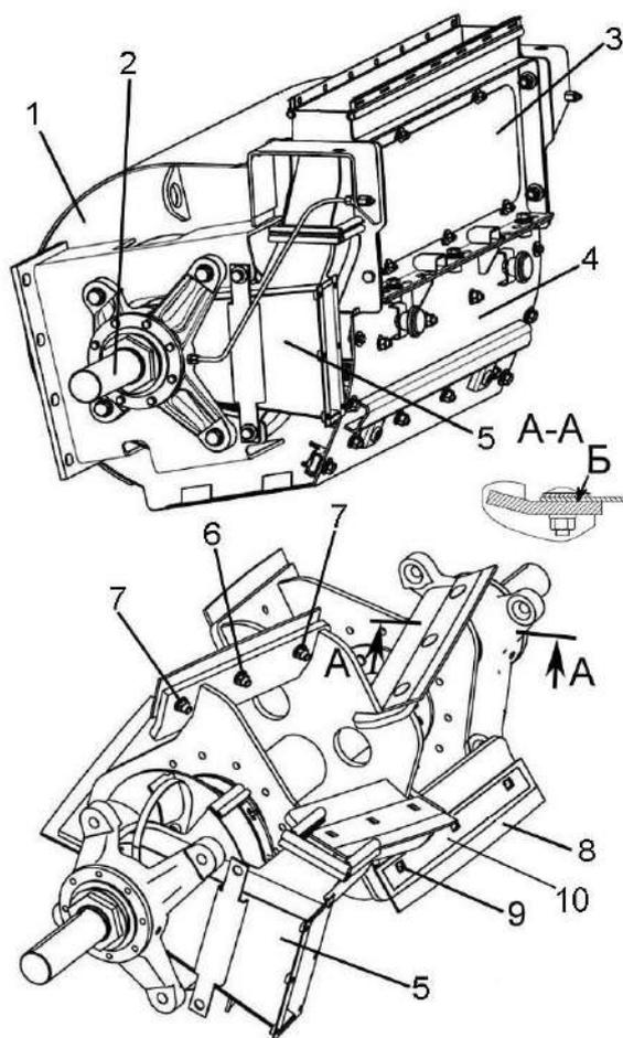
1 – корпус ускорителя; 2 – вал ускорителя;
