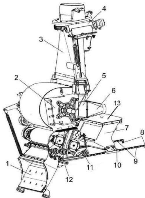
1 – камера приемная; 2 – ускоритель выброса; 3 – основание силосопровода; 4 – механизм поворота силосопровода; 5 – воздухопровод; 6 – переходник; 7 – проставка; 8, 10 – болты; 9 – цепь; 11 – механизм перемещения; 12 – устройство доизмельчающее; 13 – крышка с доизмельчающим устройством
