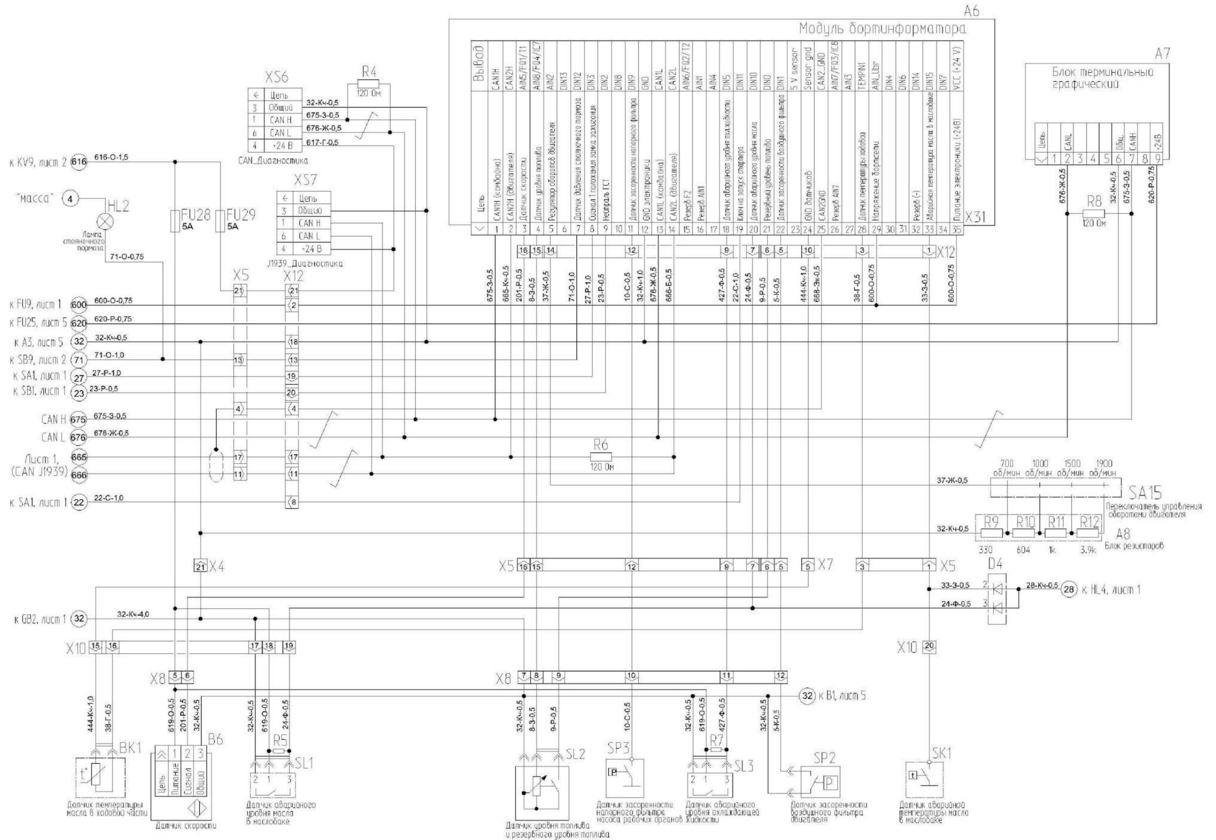
Рисунок Б.6 - Схема электрическая принципиальная комбайна
