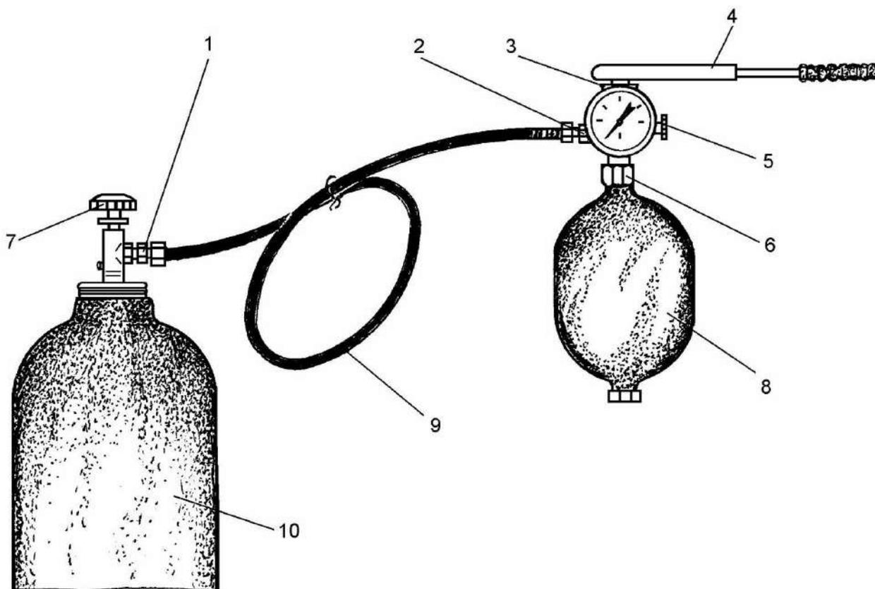
1 – переходник; 2 – обратный клапан зарядного устройства; 3 – зарядное устройство с манометром; 4 – динамометрический ключ с квадратной головкой  $\frac{1}{2}$ ”; 5 – маховичок клапана для удаления газа; 6 – накидная гайка; 7 – маховичок запорного вентиля; 8 – пневмогидроаккумулятор; 9 – шланг; 10 – баллон с азотом
