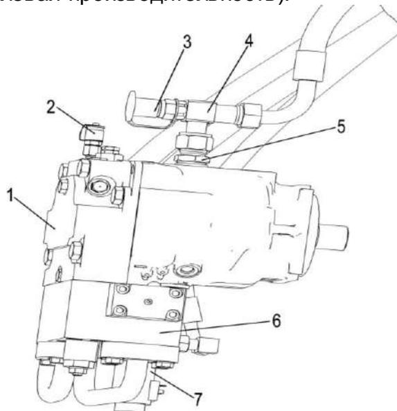
1 – гидромотор привода питающего аппарата; 2 – точка диагностики; 3 – полумуфта заправочная; 4 – тройник; 5 – штуцер; 6 – гидроблок экстренного останова
