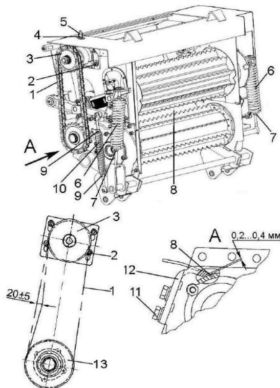
1 – цепь; 2, 4 – гайки; 3, 13 – звездочка контрпривода; 5, 7, 9 – контргайки; 6, 10 – пружины; 8 – валец гладкий; 11 – болт; 12 – чистик
