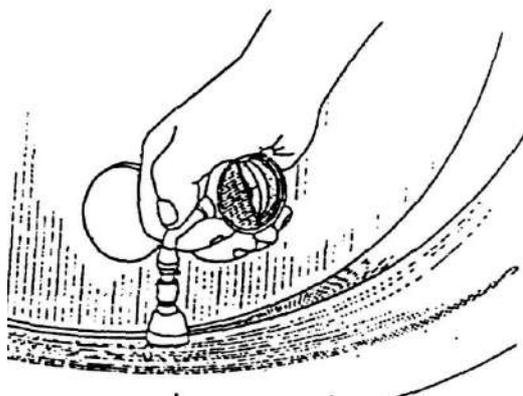
Рисунок 3.5 – Контроль давления воздуха в шинах
