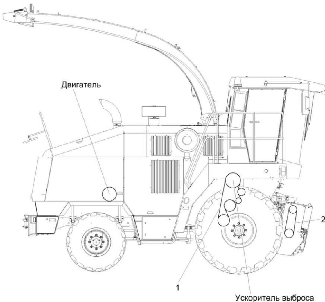
Рисунок М.2 – Схема приводов комбайна (вид справа)
