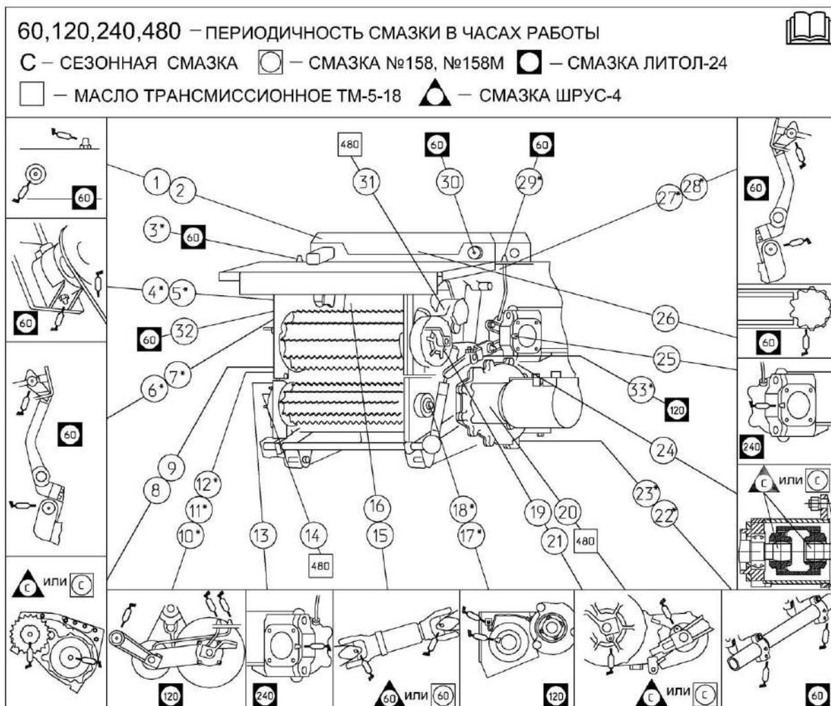
Рисунок 3.15 – Схема смазки питающе - измельчающего аппарата комбайна
