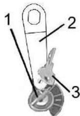
1 – замок зажигания; 2 – ключ специальный для открывания капотов; 3 – ключ от замка зажигания
