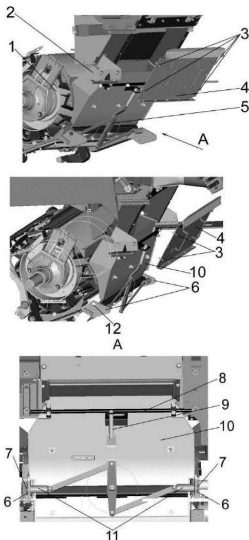
1 – барабан измельчающий; 2 – проставка; 3 – фиксаторы быстросъемные; 4 – стенка съемная; 5 – механизм открытия приемной камеры; 6 – направляющие; 7 – фиксаторы; 8 – ось; 9 – рычаг; 10 – приемная камера; 11 – втулки; 12 – отверстия для фиксации
