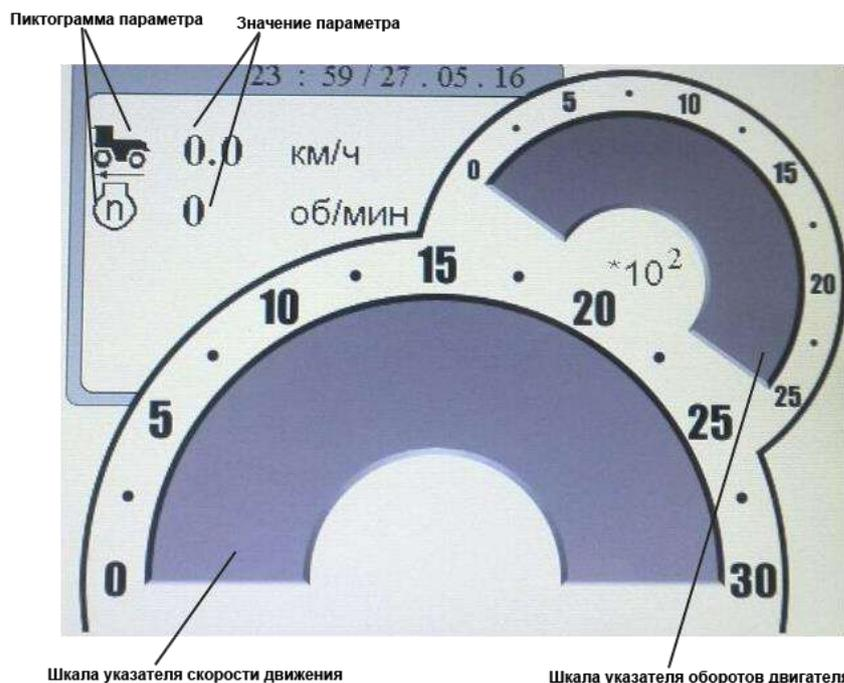
Рисунок Н.5 – Индикатор приборной панели
