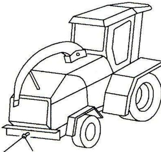
Рисунок 6.2 – Схема буксировки
