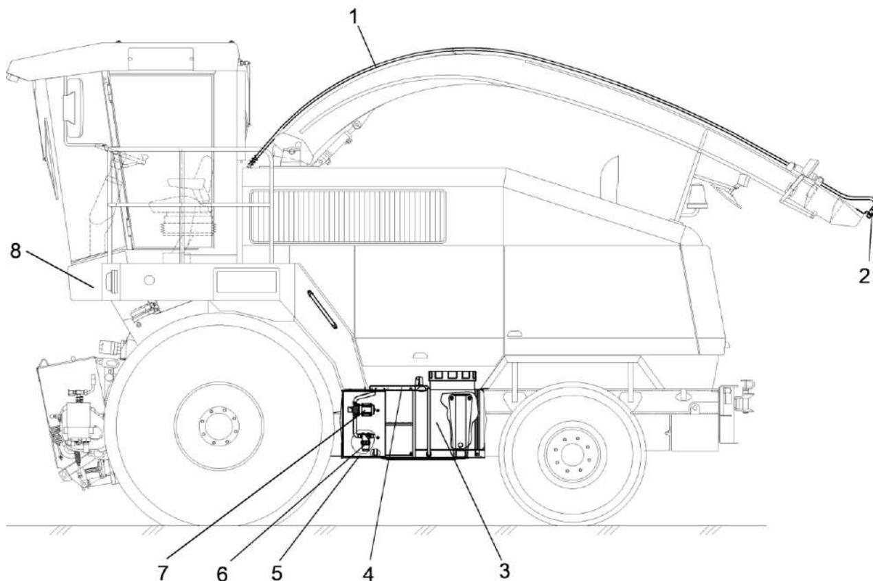
1 – электрожгут датчика наличия массы; 2 – датчик наличия массы; 3 – емкость для консерванта; 4 – площадка; 5 – рамка с ящиком для насоса; 6 – фильтр всасывающий; 7 – насос дозатор; 8 – комбайна
