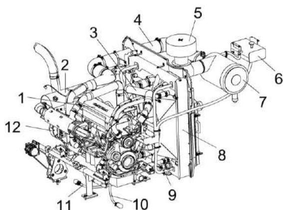
1 – двигатель; 2 – глушитель; 3, 9 – трубы водяные; 4 – труба воздушная; 5 – воздухозаборник вращающийся; 6 – бачок расширительный; 7 – воздухоочиститель; 8 – блок радиаторов; 10 – сливной рукав охлаждающей жидкости; 11 – сливной рукав отработанного масла; 12 – главный привод
