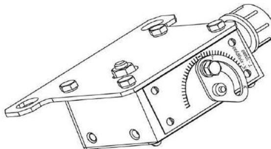
Рисунок 2.7 – Датчик камнедетектора
