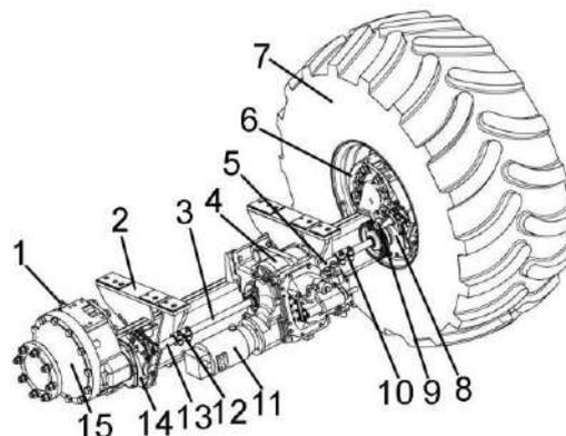
1 – сапун; 2 – балка моста; 3, 5, 13 – полуоси; 4 – коробка диапазонов; 6, 15 – бортовые редукторы; 7 – колесо; 8, 14 – муфты; 9 – датчик скорости; 10, 12 – муфты соединительные; 11 – гидромотор
