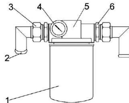
1 – стакан с фильтроэлементом; 2 – угольник; 3 – гайка; 4 – вакуумметр; 5 – корпус; 6 – штуцер
