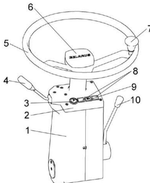
1 - кожух; 2, 6 – крышки; 3 – выключение аварийной сигнализации; 4 – подрулевой переключатель; 5 – колесо рулевое; 7 – ручка; 8 - контрольные лампы указателей поворотов; 9 - контрольная лампа дальнего света; 10 - рукоятка фиксации угла наклона колонки
