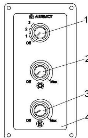
1 – ручка управления вентилятором; 2 – ручка управления термостатом кондиционера; 3 – ручка управления термостатом отопителя; 4 – блок управления
