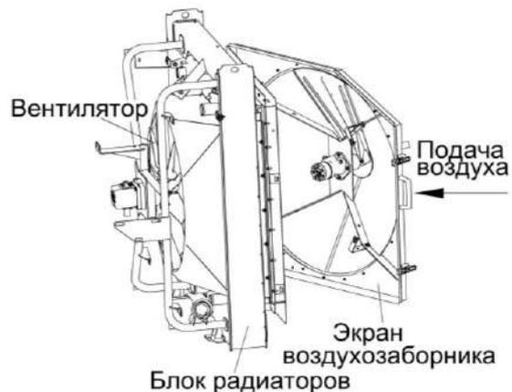
Рисунок 3.1 - Обдувка сжатым воздухом блока радиаторов
