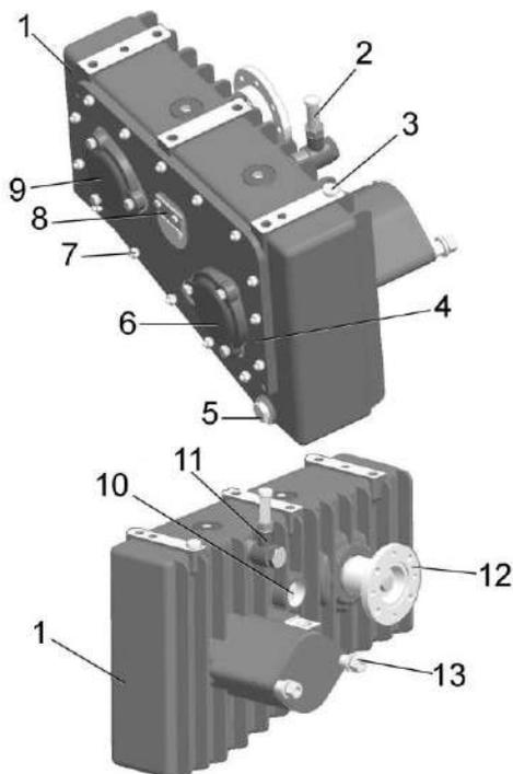
1 - корпус; 2 - сапун; 3 - маслоуказатель; 4, 6, 9 – крышки; 5 - пробка; 7 - болт; 8 – упор; 10 - ось; 11 – угольник; 12 - фланец; 13 - гайка
