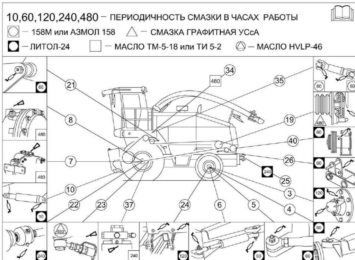
Рисунок 3.14 – Схема смазки комбайна (вид слева)
