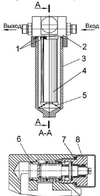
1,6,7, - кольца уплотнительные; 2 – головка фильтра; 3 – стакан; 4 - фильтроэлемент; 5 – пружина; 8 – клапан - сигнализатор
