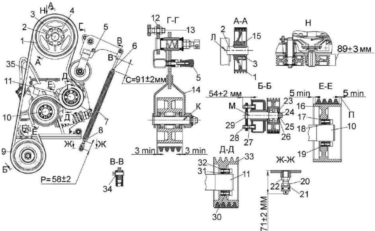
1, 33 – шкивы; 2 – вал ускорителя; 3 – болт; 4 – пластина; 5 – фиксатор; 6, 8, 13, 22, 28 – гайки; 7 – пружина; 9, 16 – ролики; 10 – вал вальца нижнего; 11 – вал вальца верхнего; 12, 29 – опоры; 14 – рычаг; 15, 18, 31 – ступицы; 17, 23, 32 – втулки; 19, 30 – винты; 20 – палец; 21, 26 – шайбы; 24 – гайка специальная; 25 – шайба специальная; 27 – шпилька; 34 – ось; 35 – ремень
