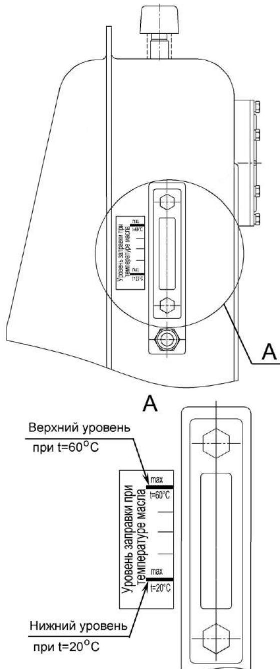
Рисунок 2.6 – Заправка гидросистем
