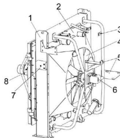
1 – рамка; 2 – блок радиаторов; 3, 5, 7 – кронштейны; 4 – вентилятор; 6 – гидромотор привода вентилятора; 8 – воздухозаборник
