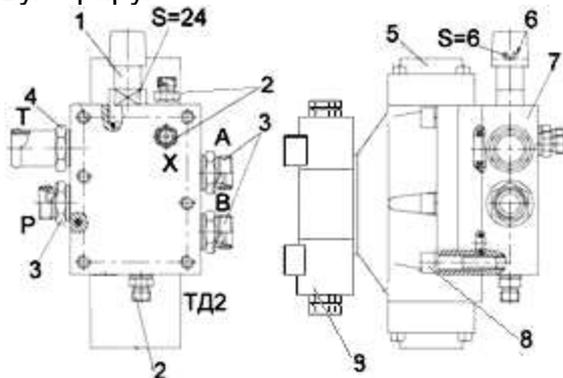
1 – клапан предохранительный; 2, 3, 4 – штуцера; 5, 9 – гидрораспределители; 6 – винт регулировочный предохранительного клапана; 7 – плита; 8 – винт
