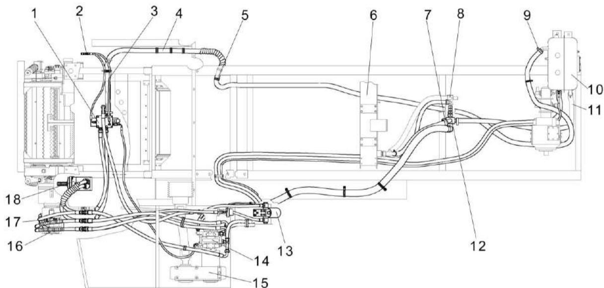
1 – гидроблок адаптеров; 2 – точки диагностики; 3, 4, 11 – рукава; 5, 7, 9 – хомуты; 6 – радиатор масляный; 8, 12 – коллекторы; 10 - бак масляный; 13– фильтр напорный; 14– гидронасос двухсекционный; 15 – редуктор привода гидронасосов; 16 – гидромотор привода питающего аппарата с гидроблоком экстренного останова; 17 - полумуфта заправочная; 18 – гидромотор привода режущего аппарата
