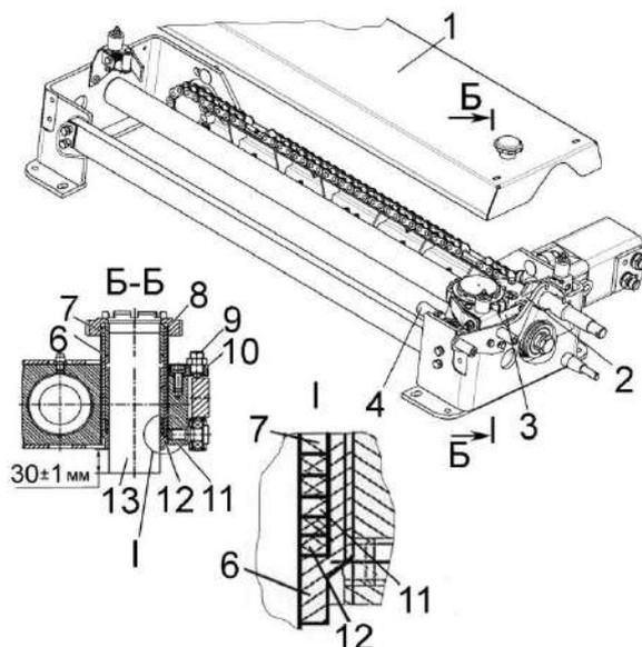
1 – крышка; 2 – каретка; 3 – прижим; 4 – фиксатор; 6 – втулка резьбовая; 7 – втулка; 8 – колесо храповое; 9 – устройство стопорное; 10 – планка; 11 – кольцо; 12 – кольца резиновые (4 шт); 13 – брусок абразивный
