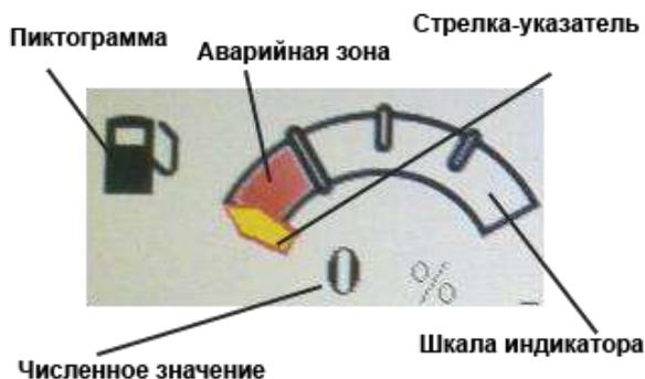
Рисунок Н.3– Пример стрелочного индикатора
