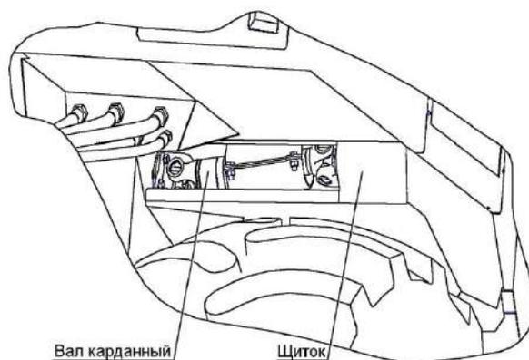
Рисунок 3.12 – Смазка шарниров карданного вала привода редуктора гидронасосов
