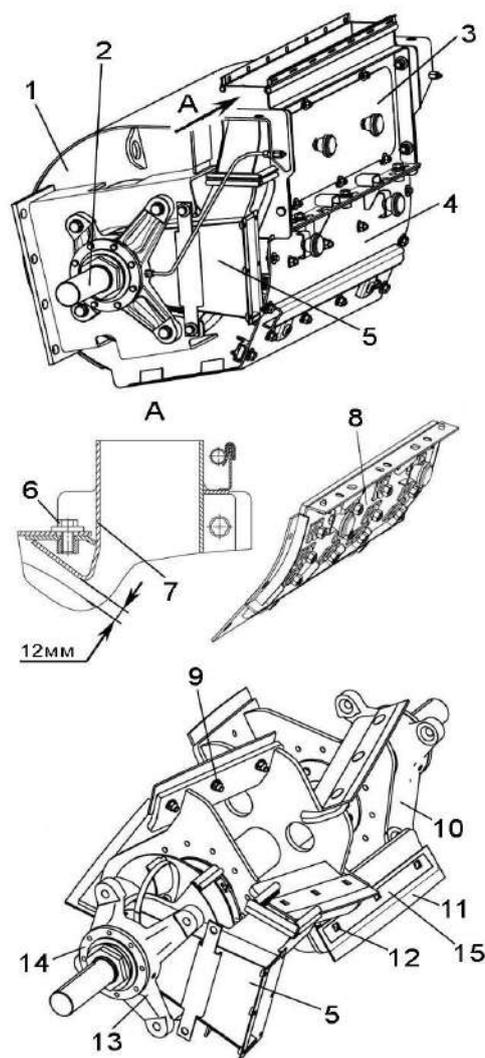
1 – корпус ускорителя; 2 – вал ускорителя выброса; 3 – стенка задняя; 4 – поддон; 5 – воздуховод; 6, 12 – болты; 7 – отсекаль; 8 – поддон бичевой; 9 – гайка; 10, 13 – корпуса; 11 – лопасть; 14 – крышка; 15 – накладка
