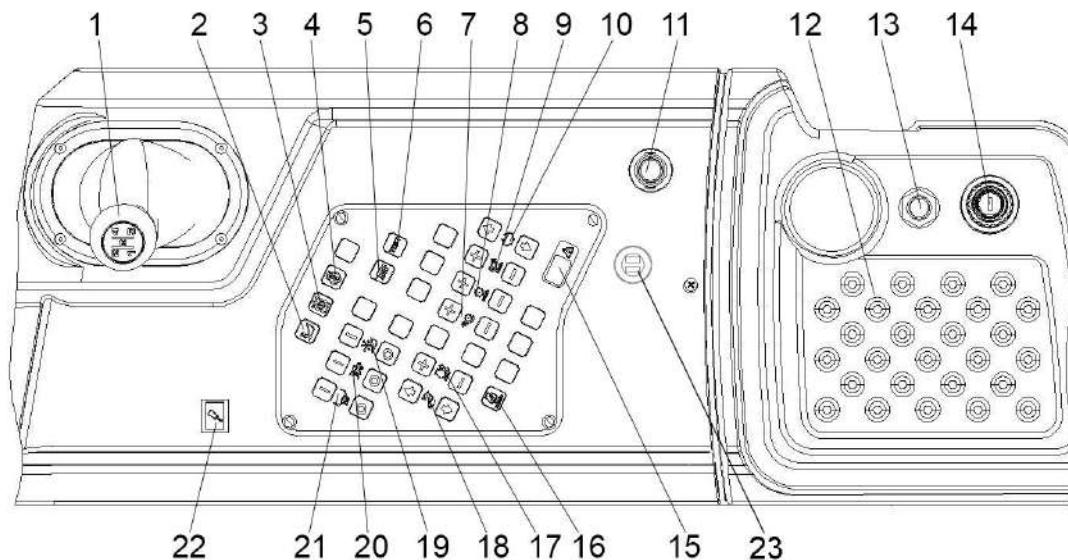
Рисунок 1.31 – Пульт управления комбайна
