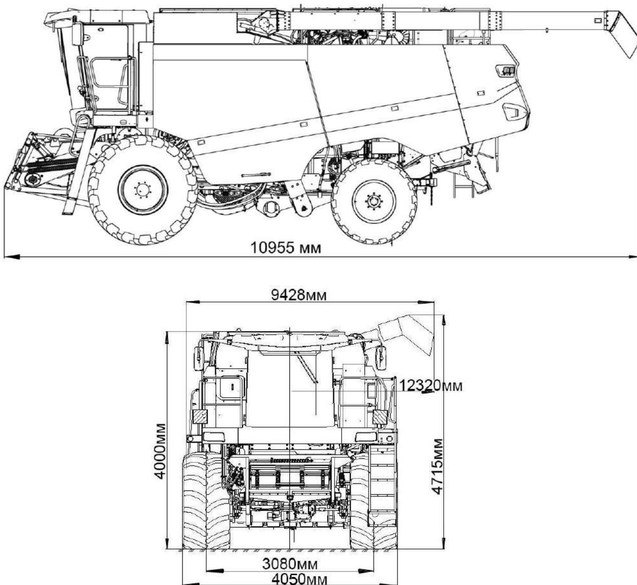
Рисунок 1.1 – Габаритные размеры комбайна
