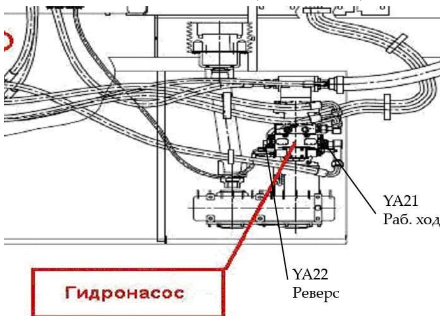
Рисунок М.2 - Расположение магнитов гидронасоса
