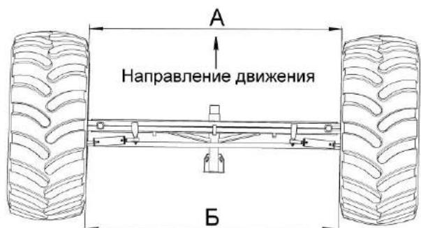
Рисунок 2.16 - Регулировка сходимости колес
