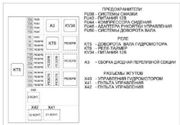
Рисунок 1.30 – Реле и предохранители пульта управления
