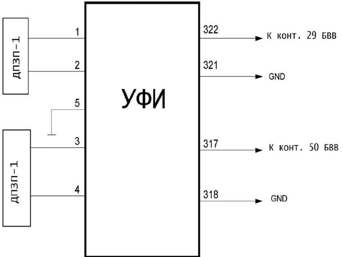
ДПЗП-1 – датчик потерь зерна пьезоэлектрический
