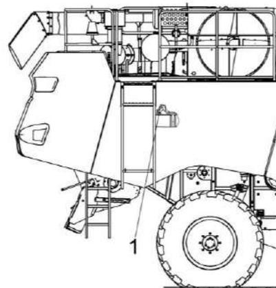
1 – крышка заливной горловины топливного бака
