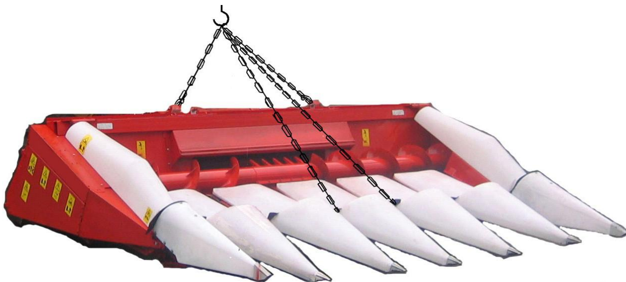
Рисунок 6.1 – Схема строповки жатки
