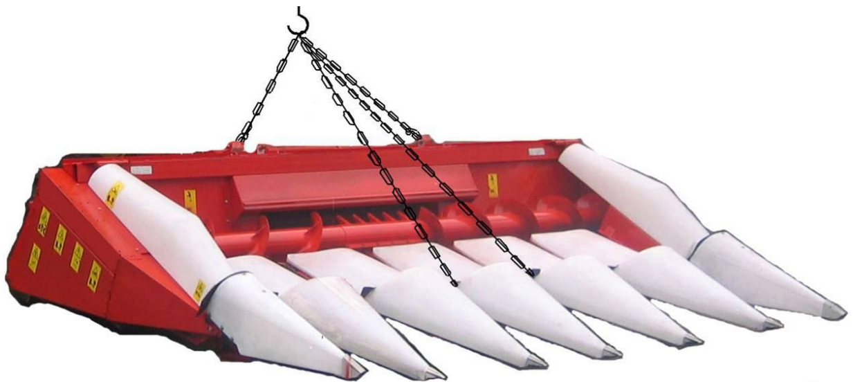
Рисунок 6.1 – Схема строповки жатки
