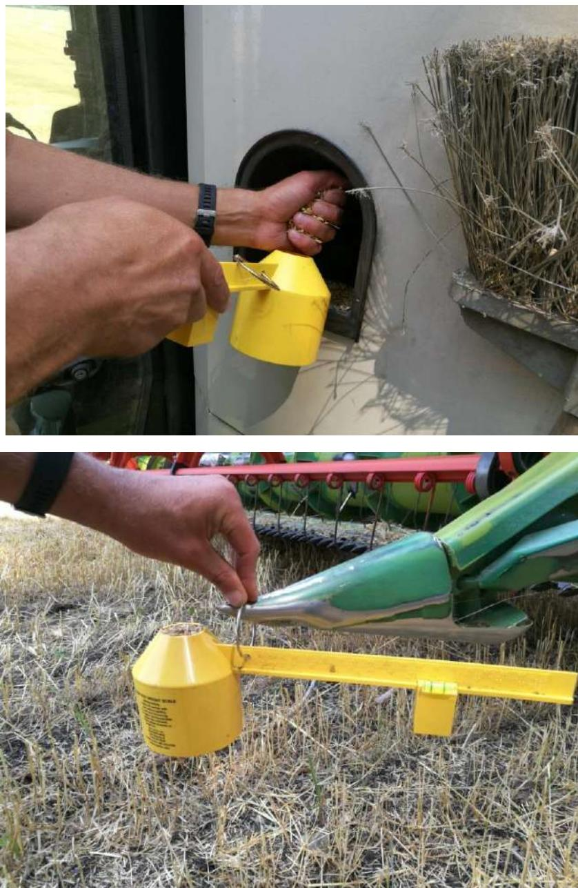
Рисунок М16 - Определение удельного веса зерна
