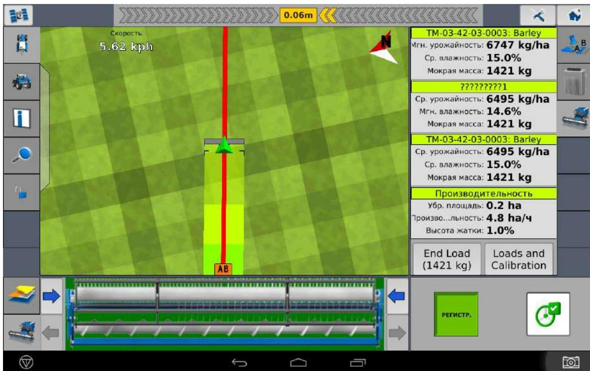
Рисунок М14 - Параметры работы сисемы мониторинга урожайности
