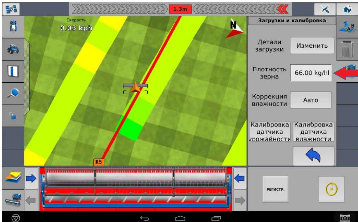
Рисунок M19 - Плотность зерна
