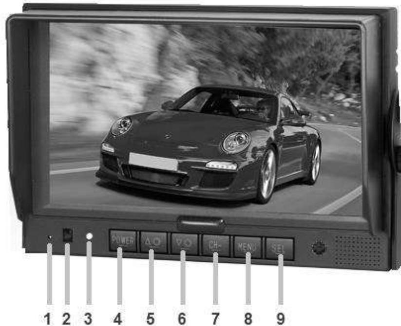
1 - датчик освещенности; 2 - ИК приемник пульта ДУ (не используется);
