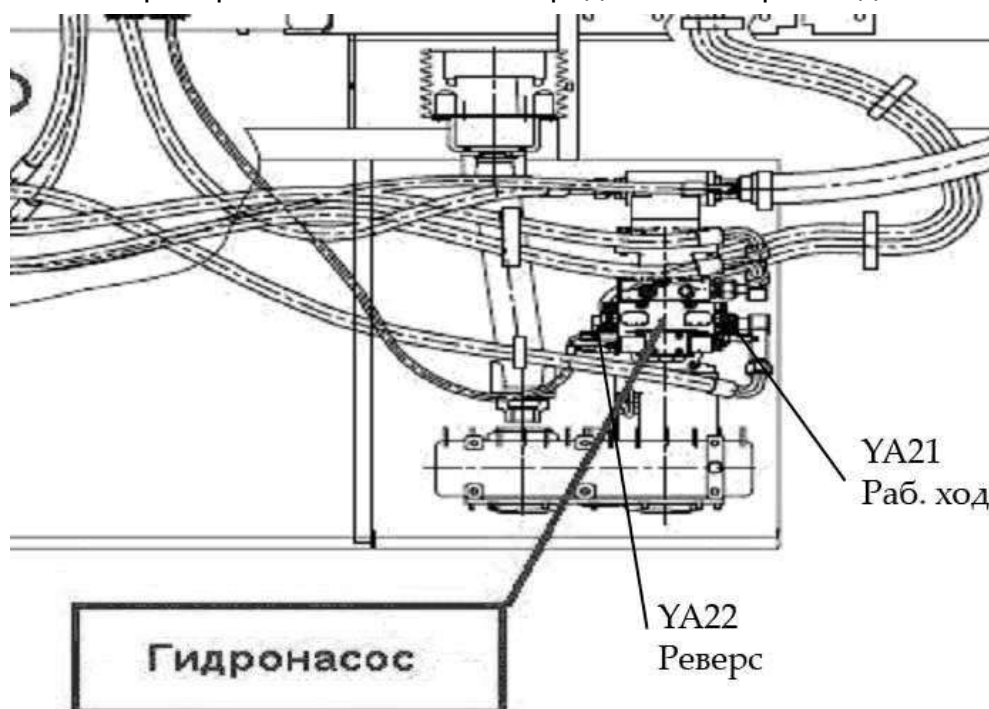
Рисунок М.2 - Расположение магнитов гидронасоса
