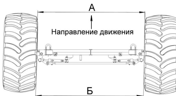
Рисунок 2.39 – Схема регулировки сходимости колес-
