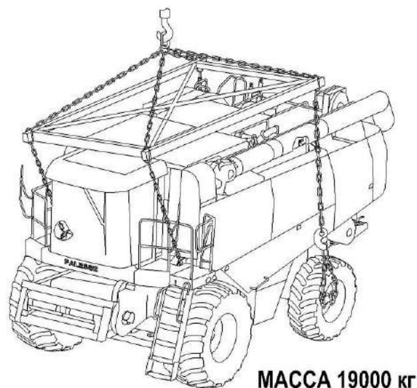
Рисунок 6.1 – Схема строповки молотилки самоходной
