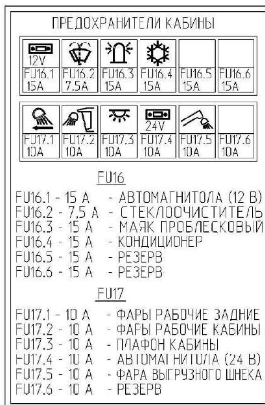
Рисунок 1.43 – Схема расположения предохранителей
