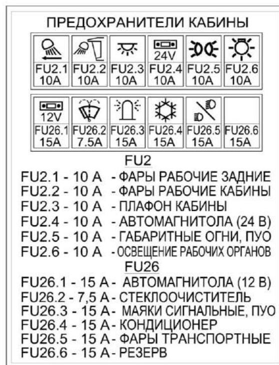
Рисунок 1.37 – Схема расположения предохранителей
