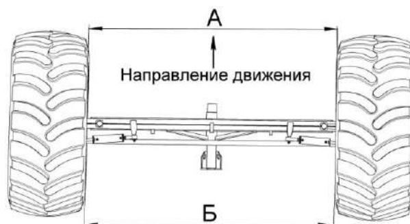
Рисунок 2.9 - Регулировка сходимости колес
