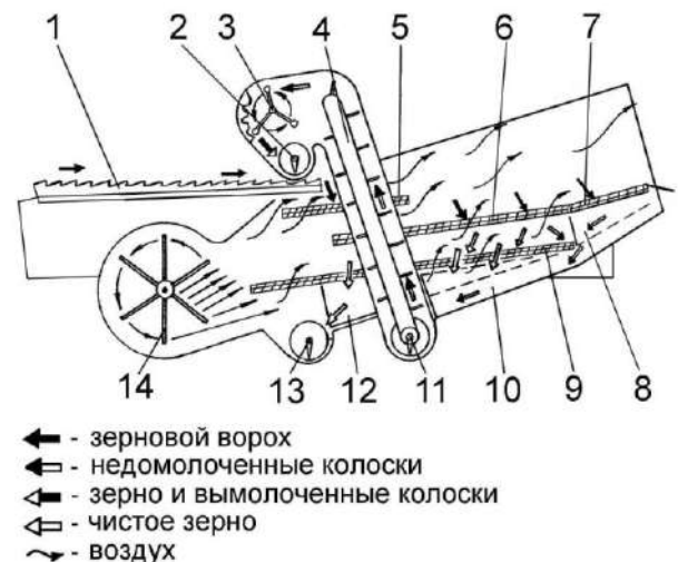
1 – стрясная доска; 2 – шнек распределительный; 3 – устройство домолачивающее; 4 – элеватор колосовой; 5 – дополнительное решето; 6 – решето верхнее; 7 - удлинитель; 8 – поддон удлинителя; 9 – решето нижнее; 10 – поддон колосовой; 11 – шнек колосовой; 12 – поддон зерновой; 13 – шнек зерновой; 14 – вентилятор
