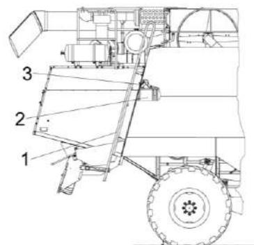
1 – лестница; 2 - топливный бак; 3 - заливная горловина
