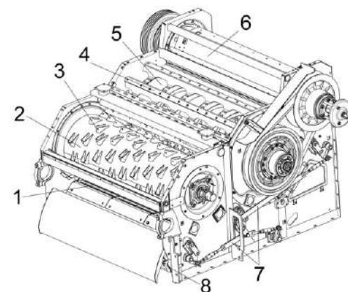
1 – подбарабанье; 2 – барабан ускоряющий; 3 – колпак; 4 – бич; 5 – барабан молотильный; 6 – отбойный битер; 7 – механизм подъема подбарабаний; 8 – камнеуловитель
