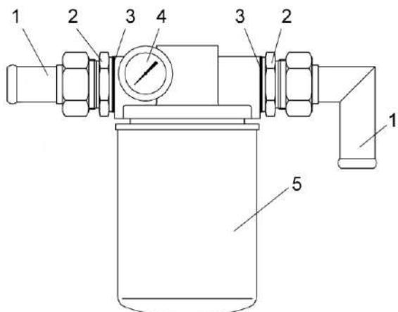
1 – хомут стяжной; 2 – штуцера; 3 – прокладки; 4 – вакуумметр; 5 – фильтр
