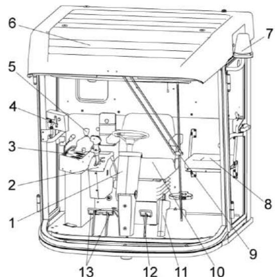
1 – колонка рулевая; 2 – блок управления; 3 – пульт управления; 4 – бортовой компьютер; 5 – рычаг переключения передач; 6 – крыша кабины; 7 – маяк пролесковый; 8 - дополнительное сиденье; 9 – стеклоочиститель; 10 - сиденье; 11 – рукоятка стояночного тормоза; 12 – педаль блокировки коробки передач; 13 - тормозные педали
