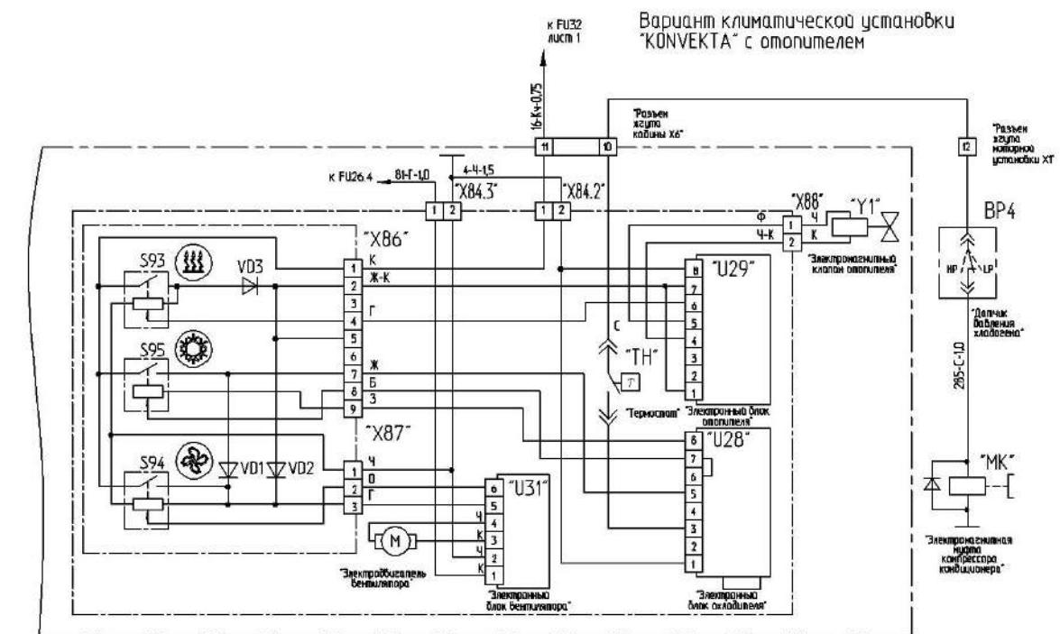
Рисунок Б.3 – Схема электрическая принципиальная комбайна (лист 3)
