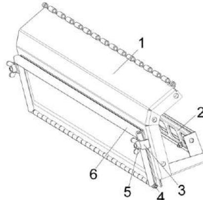
1 – основание; 2 – щит; 3 – прижим; 4 – ось; 5 – гайка-барашк; 6 – крышка
