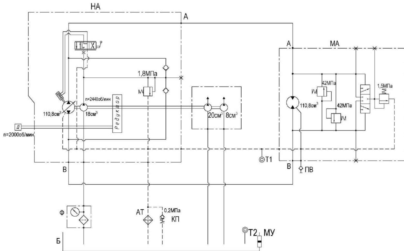
Рисунок А.2 – Схема гидравлическая принципиальная гидросистемы привода ходовой части
