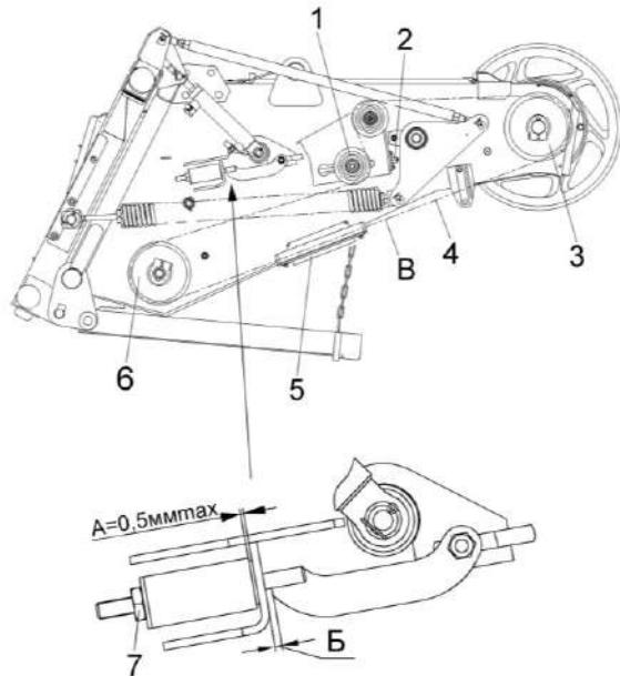
1, 3, 6 – звездочки; 2 – винт; 4 – цепная передача; 5 – успокоитель; 7 - гайка
