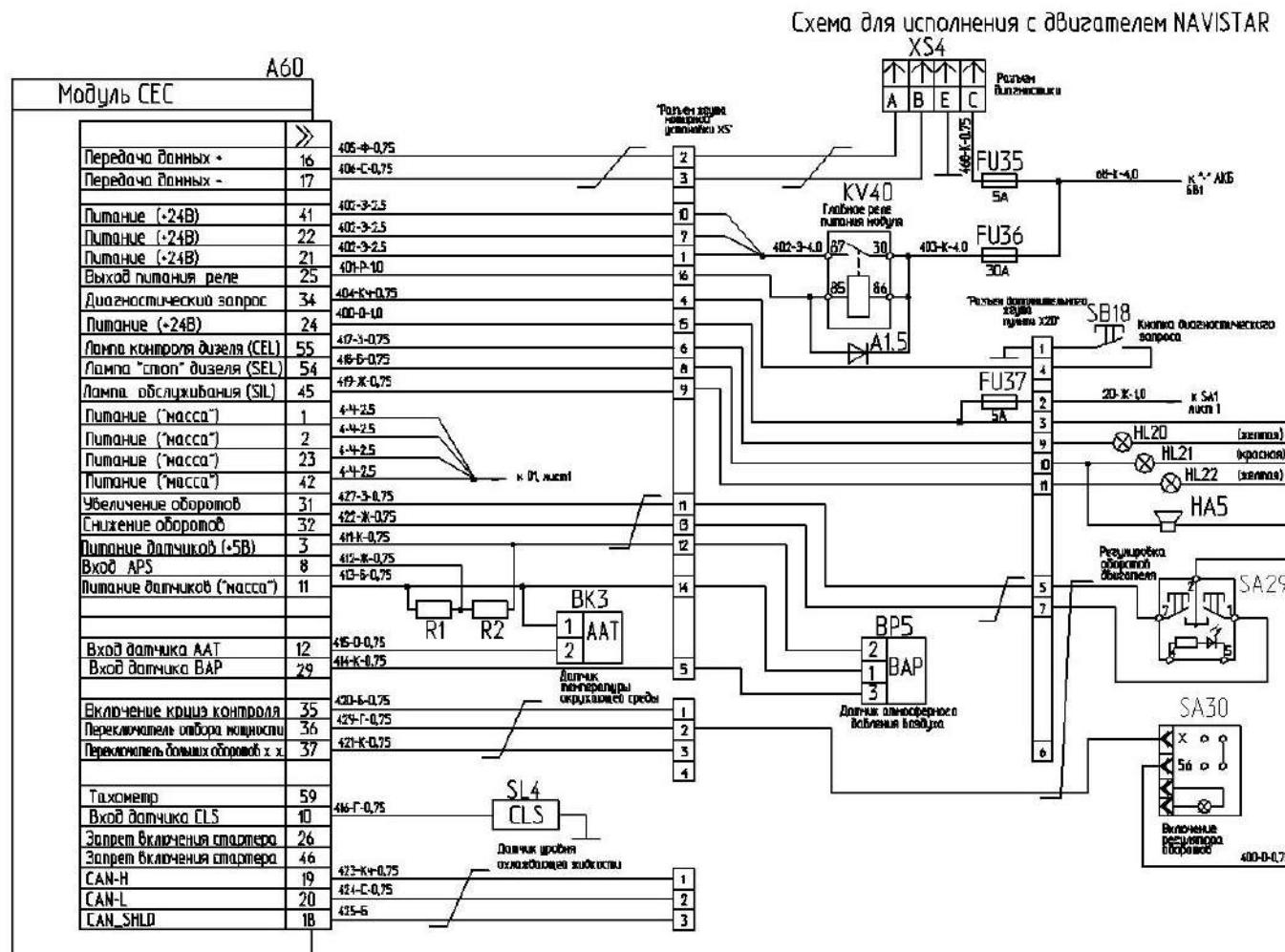
Рисунок Б.8 – Схема электрическая принципиальная комбайна (лист 8)
