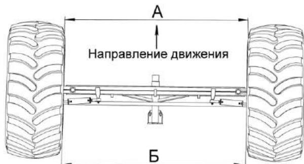
Рисунок 2.26 - Регулировка сходимости колес
