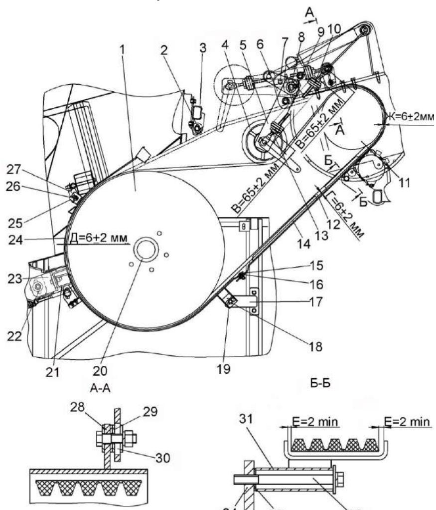
1, 11 – шкивы; 2, 4 – ролики; 3 – успокоитель; 5 – рычаг; 6 – опора; 7, 8, 13 – гайки; 9 – масленка; 10 – пружина; 12 – ремень; 14, 24 – щитки; 15, 32 – болты; 16, 18, 20, 22, 26, 29, 33 – шайбы; 17, 19, 21, 23, 27, 28, 30, 34 – кронштейны; 25 – уголок; 31 – втулка
