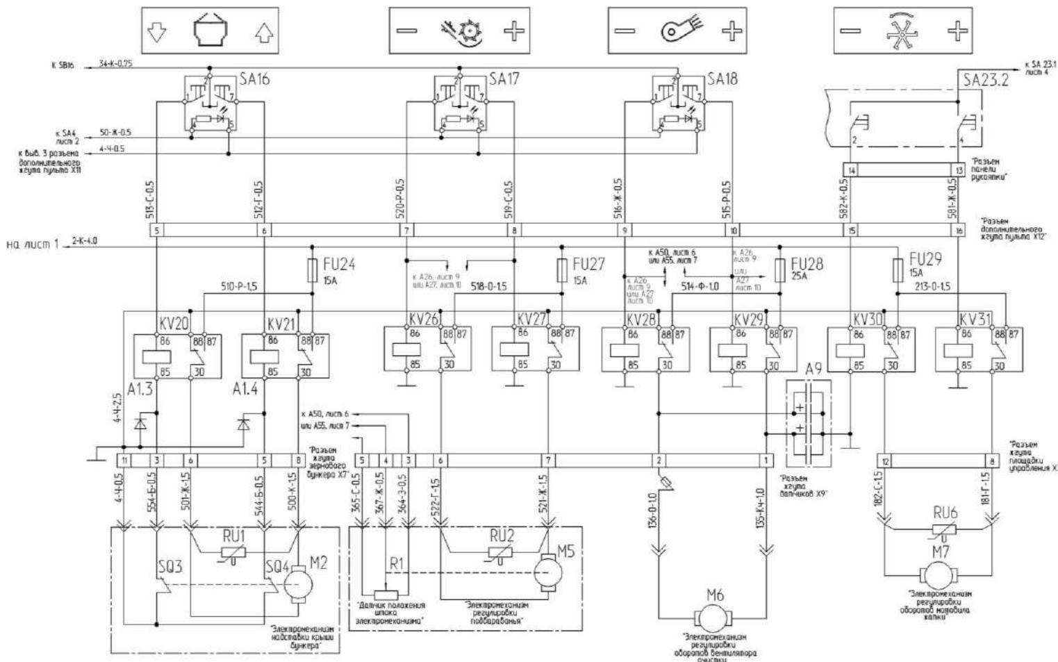
Рисунок Б.5 – Схема электрическая принципиальная комбайна (лист 5)
