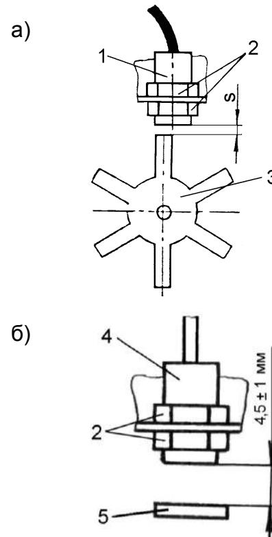
1 – датчик ПРП-1М; 2 – регулировочные гайки; 3 – звездочка; 4 – датчик; 5 – пластина
