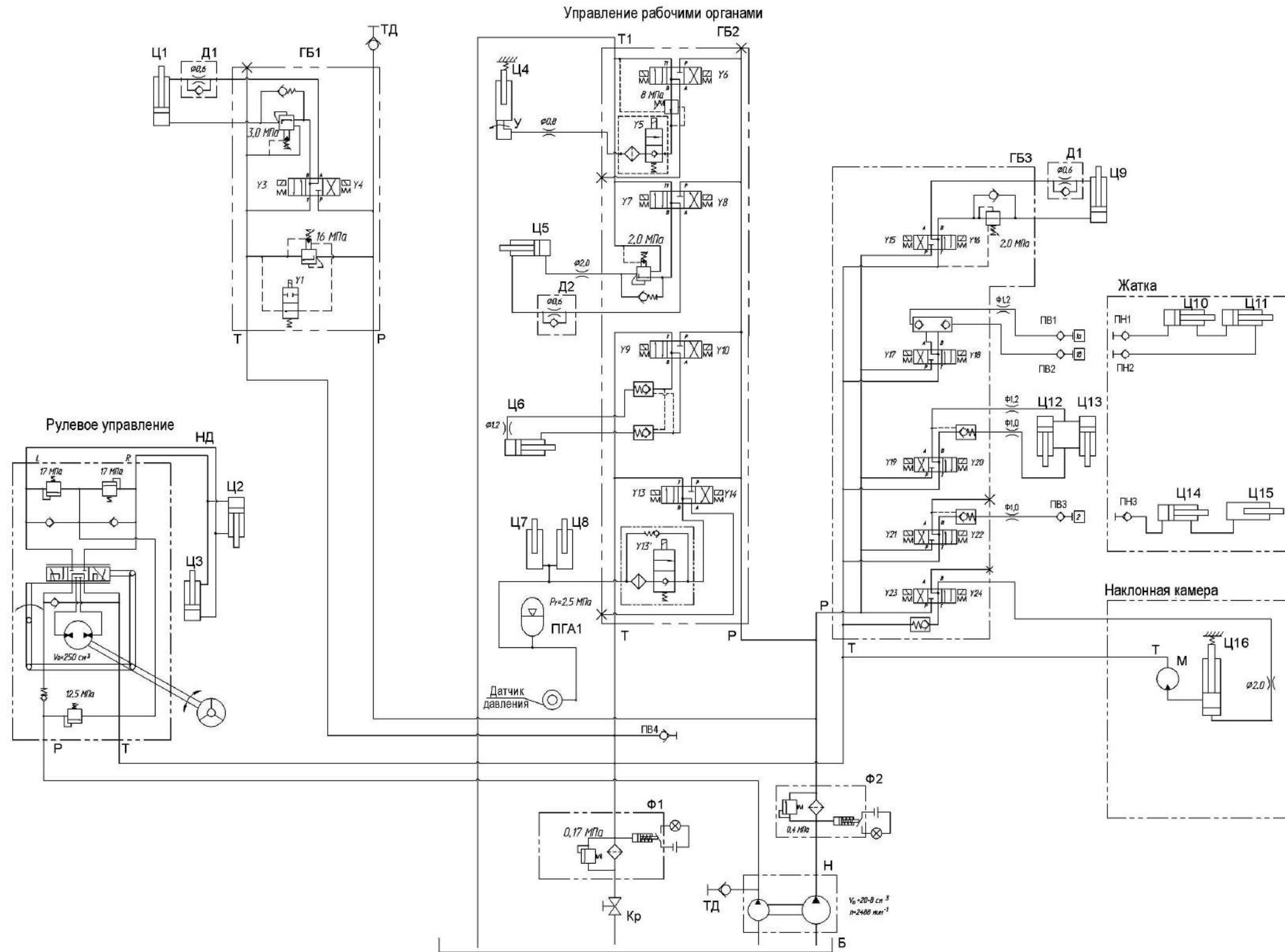
Б – бак масляный; ГБ1, ГБ2, ГБ3 – гидроблоки; Д1, Д2 – дроссели с обратным клапаном; Кр – кран шаровой ММ рычажный Du 32; М - гидромотор; НД – насос-дозатор; Н – насос двухсекционный; ПВ1...ПВ3 – штекер; ПВ4 - полумуфта внутренняя; ПГА1 – пневмогидроаккумулятор; ПН1...ПН3 – муфта; Ф1 – фильтр; Ф2 – фильтр напорный ФСК-20 М; ТД – точки диагностические
