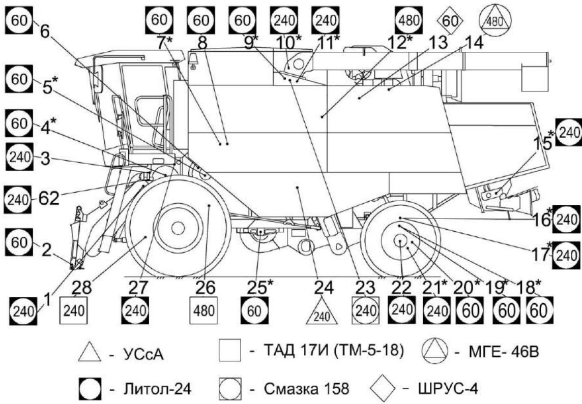
Рисунок 3.2 – Смазка молотилки (вид слева)
