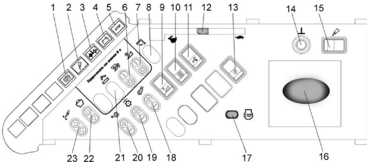
Рисунок 1.33 – Пульт управления комбайна с двигателем ЯМЗ
