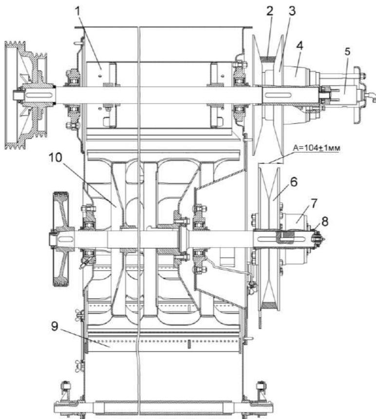
1 – битер отбойный; 2 – ремень; 3 – ведущий шкив; 4, 7 – вариаторы барабана; 5 - гидроцилиндр; 6 – ведомый шкив; 8 - прокладки регулировочные; 9 – подбарабанье; 10 - барабан молотильный
