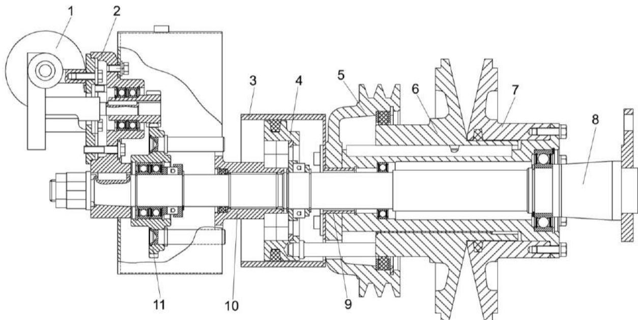
1, 2 – привод; 3 - кожух; 4 – упор; 5, 6, 7 – шкивы; 8 – ось; 9, 10 – втулки; 11 – колесо
