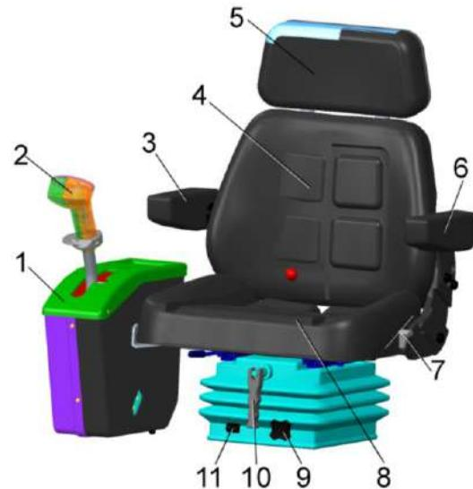
1 – блок управления; 2 – рукоятка управления скоростью движения; 3, 6 – подлокотники; 4 – спинка; 5 – подголовник; 7 – рычаг фиксации наклона спинки; 8 – подушка; 9 – кнопка регулировки системы подпрессоривания сиденья; 10 – рычаг фиксации продольного перемещения сиденья; 11 – указатель веса;
