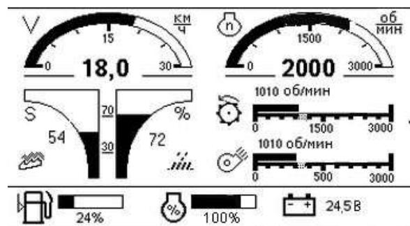
Рисунок 1.92 – Экран технологического режима уборки (комбайнирования)
