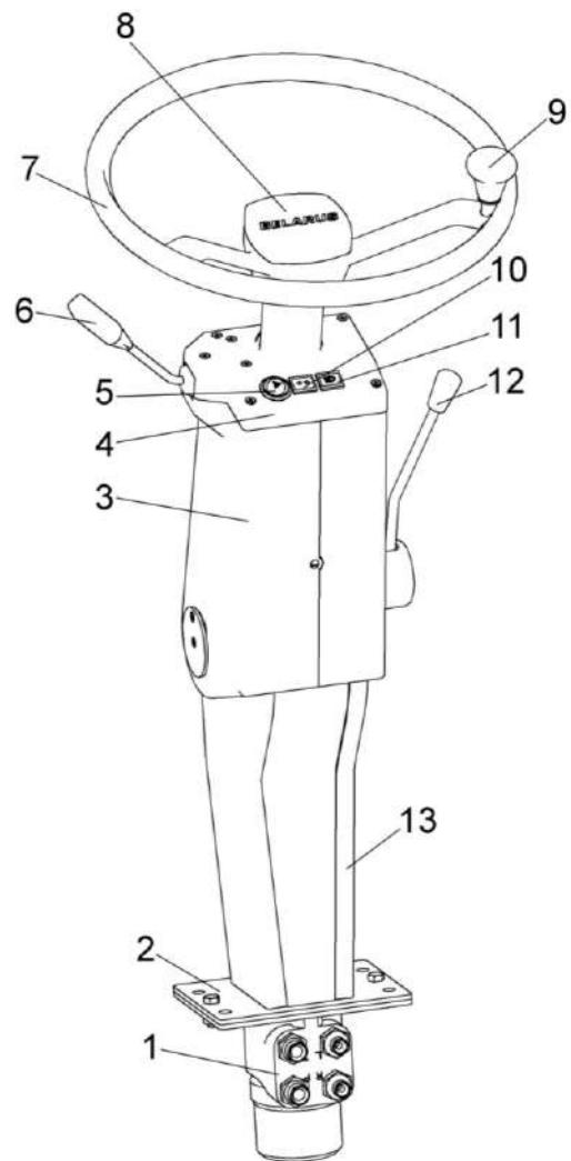
1 - насос дозатор; 2 – кронштейн; 3 - кожух; 4, 8 – крышки; 5 – выключение аварийной сигнализации; 6 – подрулевой переключатель; 7 – колесо рулевое; 9 – ручка; 10 - контрольная лампа указателей поворотов; 11 - контрольная лампа дальнего света; 12 - рукоятка фиксации угла наклона колонки; 13 – стойка
