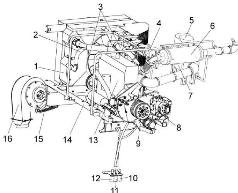
1 – радиатор; 2 – трубы водяная верхняя; 3 – трубы воздушные; 4 - бачок расширительный; 5 – воздухозаборник вращающийся; 6 – глушитель; 7 – воздухозаборник; 8 – установка гидронасосов; 9 – главный привод; 10 – сливной рукав охлаждающей жидкости; 11 – сливной рукав масла из редуктора; 12 – сливной рукав масла из картера двигателя; 13 – двигатель; 14 – рама подмоторная; 15 – устройство натяжное; 16 – вентилятор
