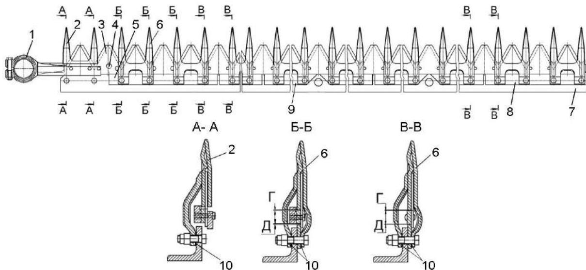
1 – головка ножа; 2 – палец направляющий; 3 – сегмент; 4 – полоса ножевая; 5, 8, 9 – пластины трения; 6 – сдвоенные пальцы; 7 – бруск пальцевый; 10 - регулировочные прокладки
