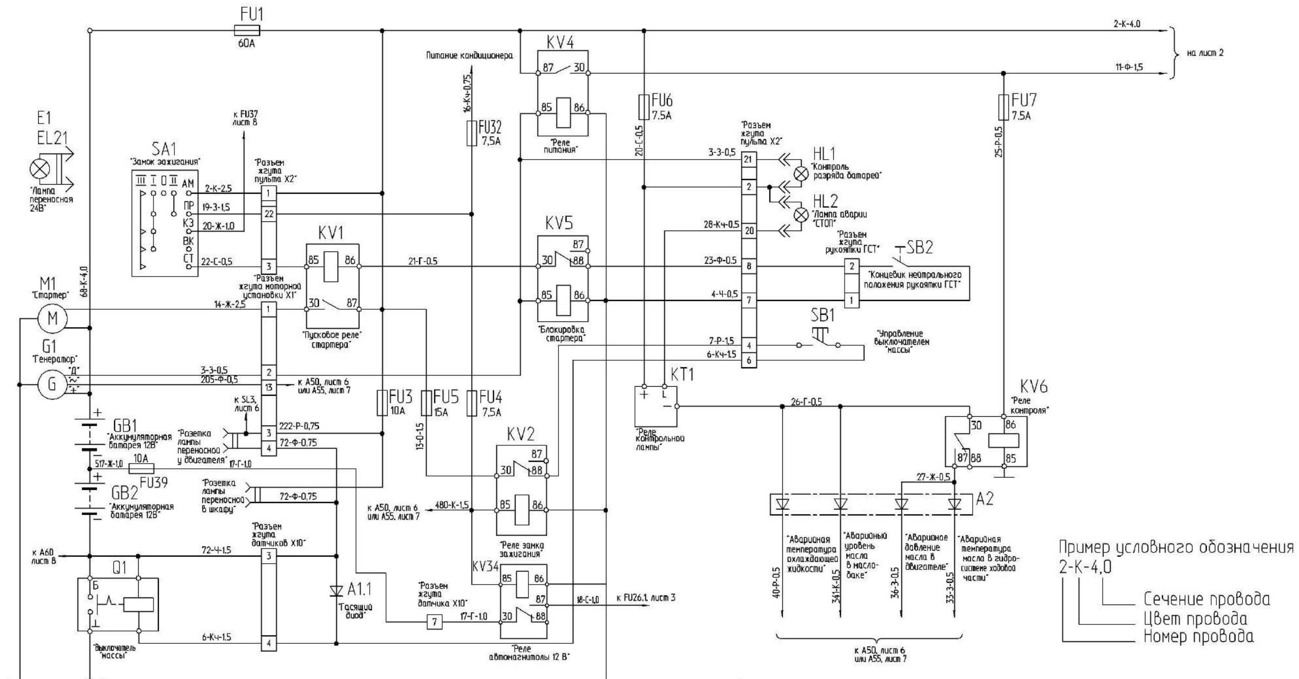
Рисунок Б.1 – Схема электрическая принципиальная комбайна (лист 1)
