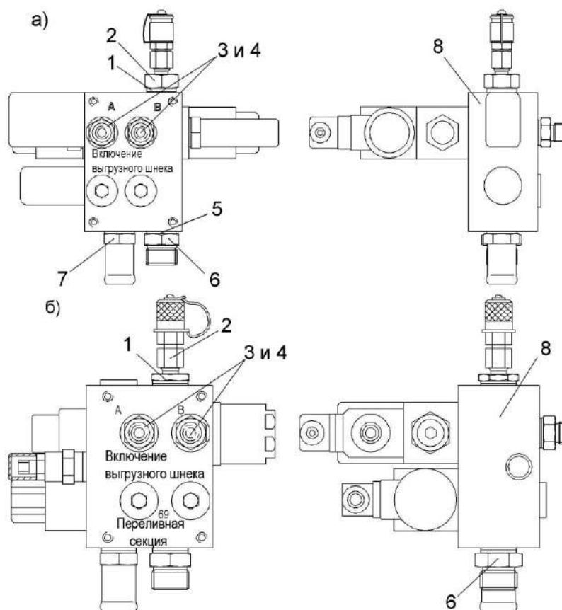
а) гидроблок односекционный;
