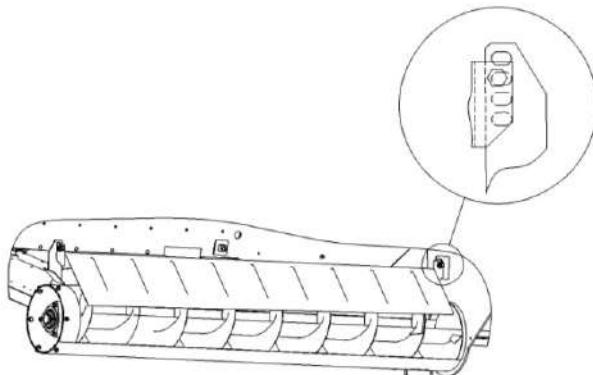
Рисунок 2.22 – Регулировка ограждения над горизонтальным шнеком бункера
