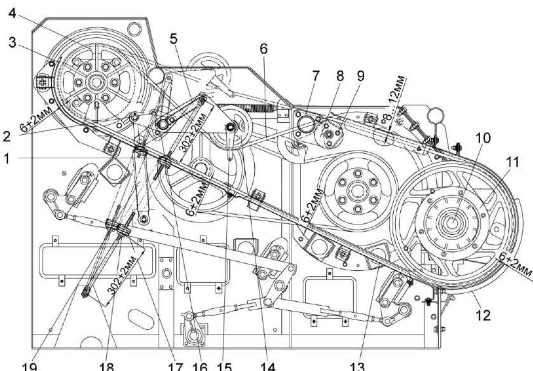
1, 2, 9, 18 – гайки; 3, 12, 13 - щитки; 4, 11 – шкивы; 5 – рычаг; 6 – ремень; 7, 16 – опора; 8, 14 - ролики; 10 – вал; 15 – кронштейн; 17 - пружина; 19 - гидроцилиндр
