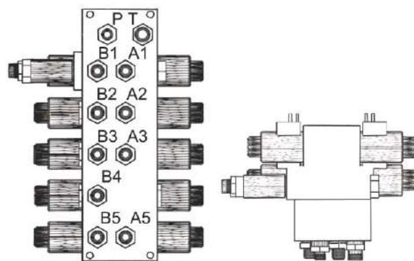
Рисунок 1.22 - Гидроблок пятисекционный
