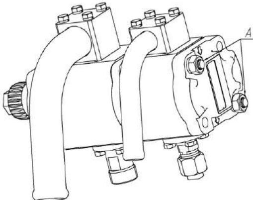
Рисунок 4.1 – Демонтаж гидронасоса
