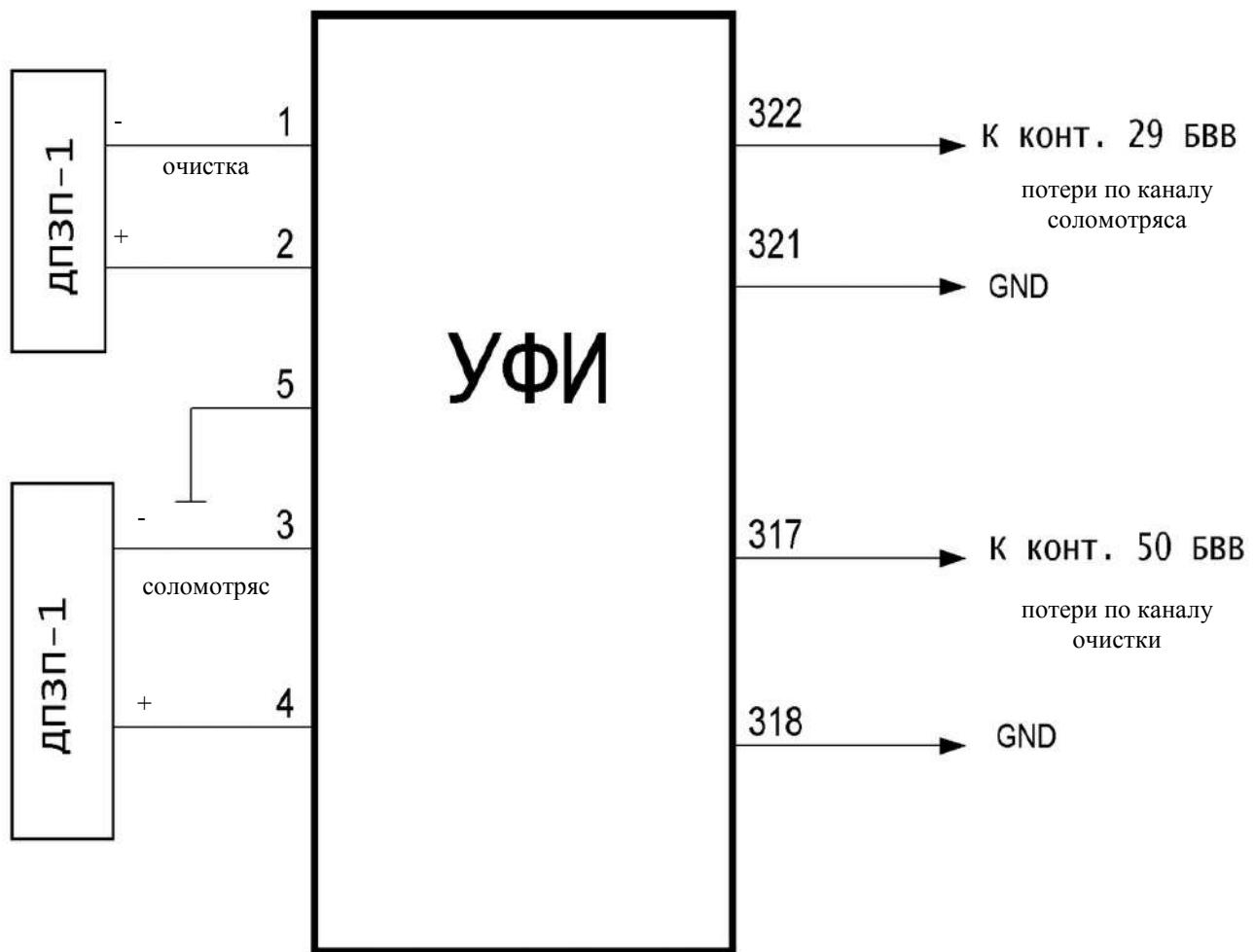
ДПЗП-1 – датчик потерь зерна пьезоэлектрический
