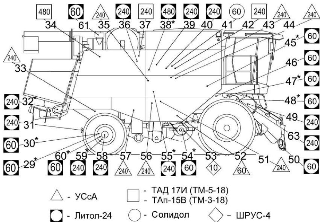
Рисунок 3.3 – Смазка молотилки (вид справа)
