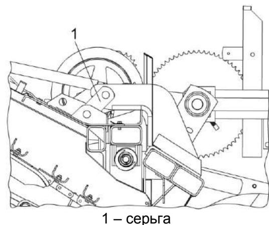
**Рисунок 2.15 – Фиксация механизма продольного копирования жатки**
