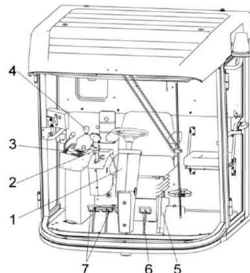
1 – колонка рулевая; 2 – рукоятка управления скоростью движения; 3 – пульт управления; 4 – рычаг переключения передач; 5 – рукоятка стояночного тормоза; 6 – педаль блокировки коробки передач; 7 - тормозные педали
