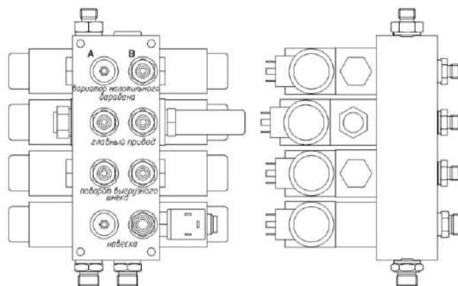
Рисунок 1.21 – Гидроблок четырехсекционный
