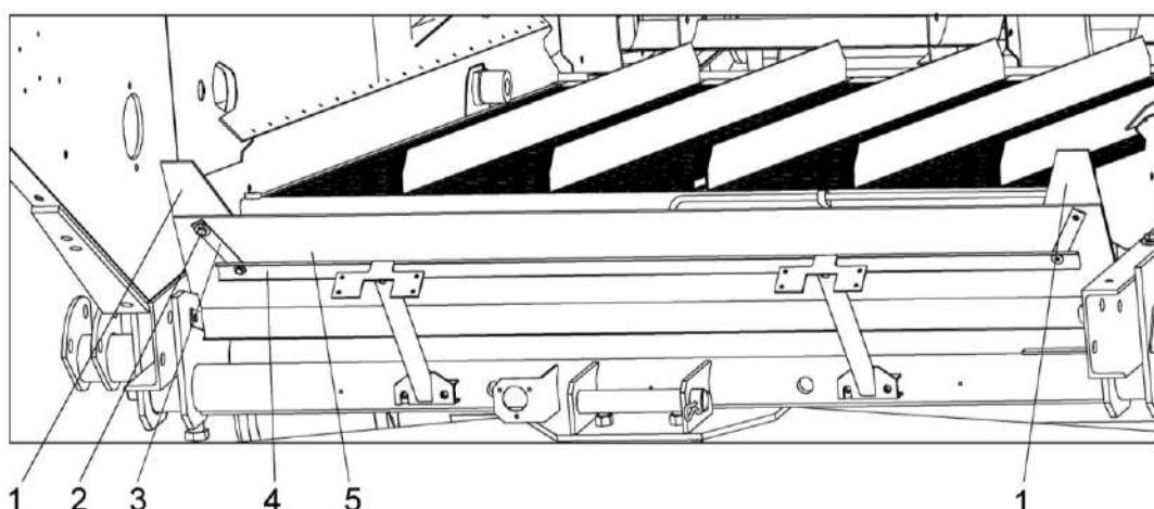
1 - дополнительные щитки; 2 - детали крепления; 3, 4 - планки; 5 - щиток
