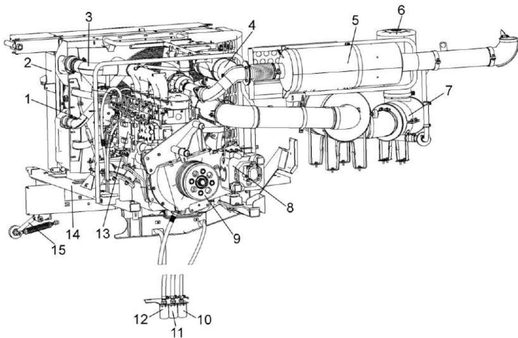
Рисунок 1.16а – Установка двигателя ММЗ
