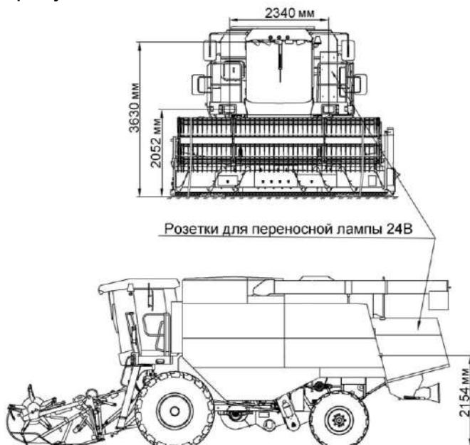
Рисунок 1.29 – Расположение наружного освещения и световой сигнализации комбайна
