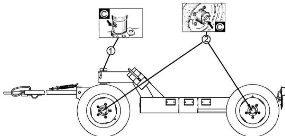
Рисунок 3.5 – Схема смазки транспортной тележки
