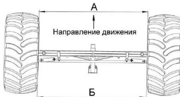
Рисунок 2.25 - Регулировка сходимости колес
