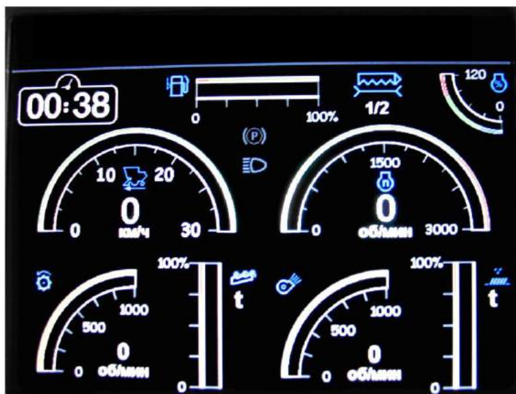
Рисунок 1.111 – Экран технологического режима уборки (комбайнирования)
