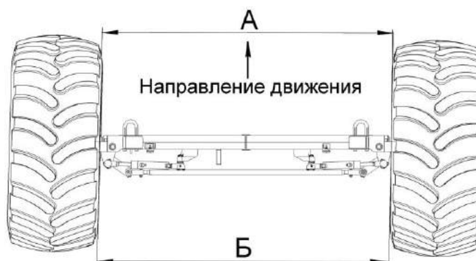
Рисунок 2.36 – Схема регулировки сходимости колес-
