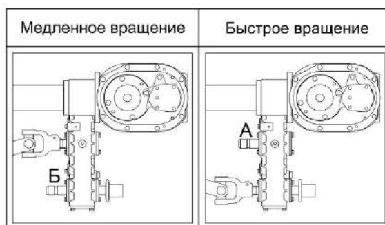
Рисунок 2.15 - Схема подсоединения карданного вала жатки для грубостебельных культур
