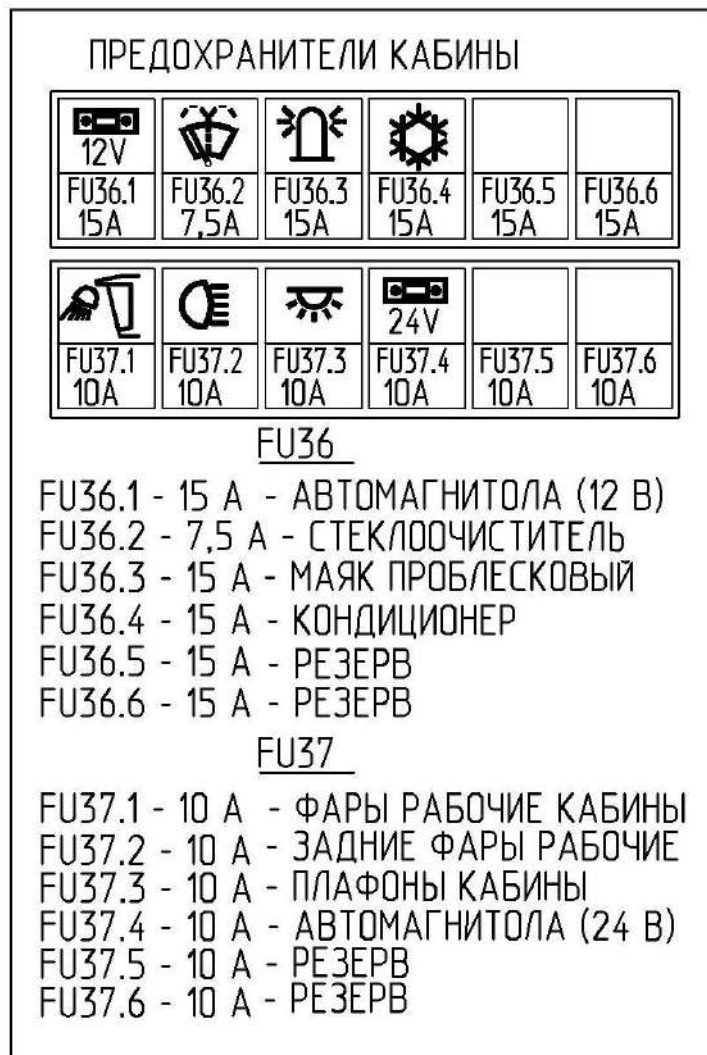
Рисунок 1.23 – Схема соединений предохранителей
