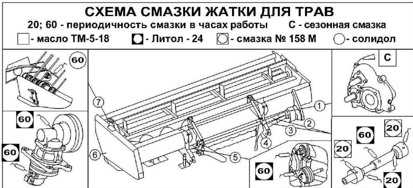
Рисунок 3.2 – Схема смазки жатки
