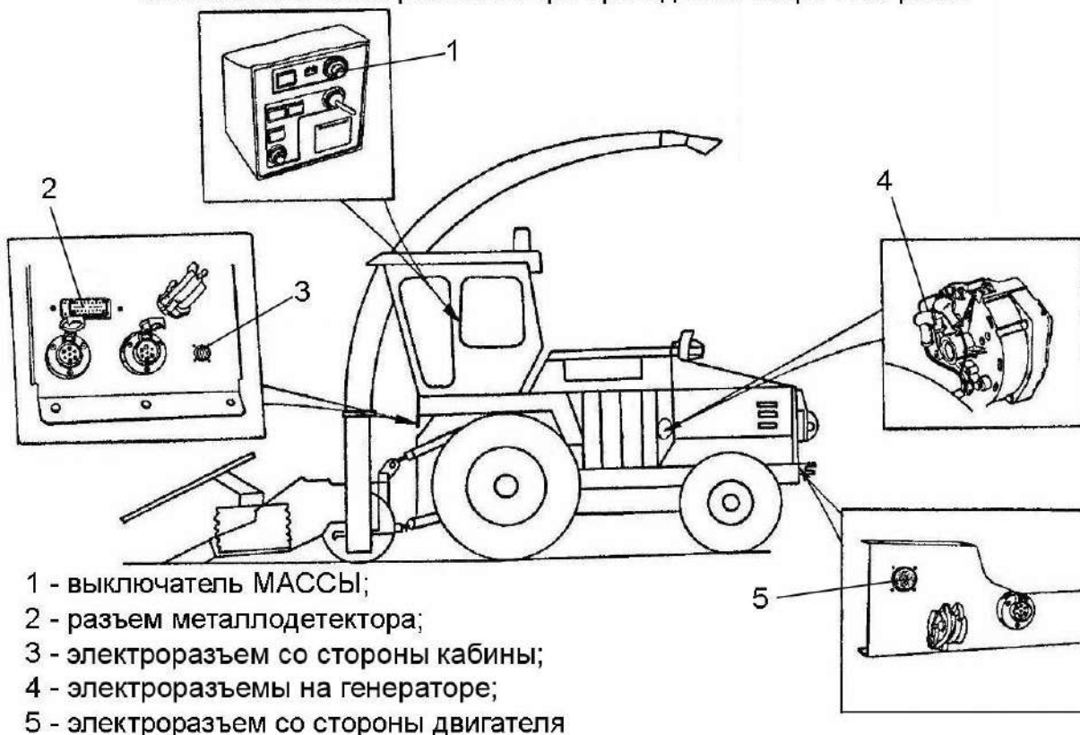
Места отключения разъемов при проведении сварочных работ
