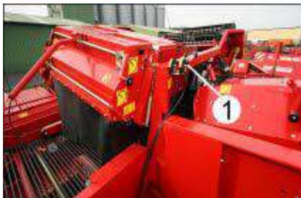
Рисунок 7.32 - Регулировка скорости транспортера второго сепарирующего устройства
