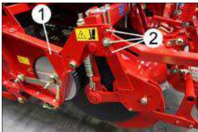
Рисунок 7.7 - Перестановка подкапывающего блока
