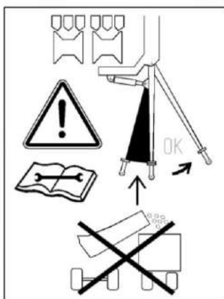
Рисунок 7.3 – Порядок выгрузки бункера
