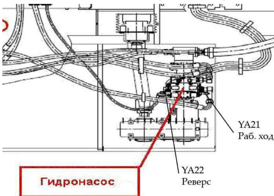
Рисунок М.2 - Расположение магнитов гидронасоса
