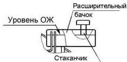
Рисунок 3.3 – Контроль уровня охлаждающей жидкости
