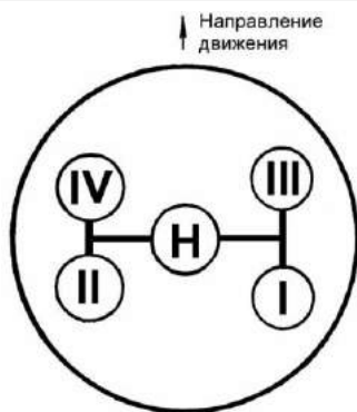
Рисунок 1.36 – Схема переключения передач
