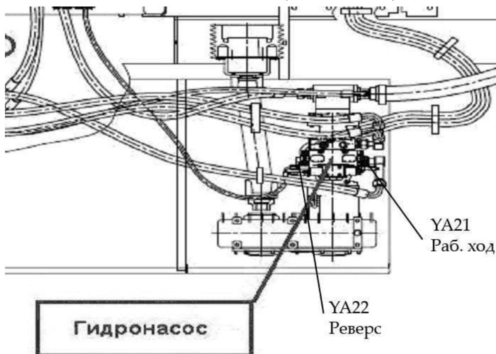
Рисунок М.2 - Расположение магнитов гидронасоса
