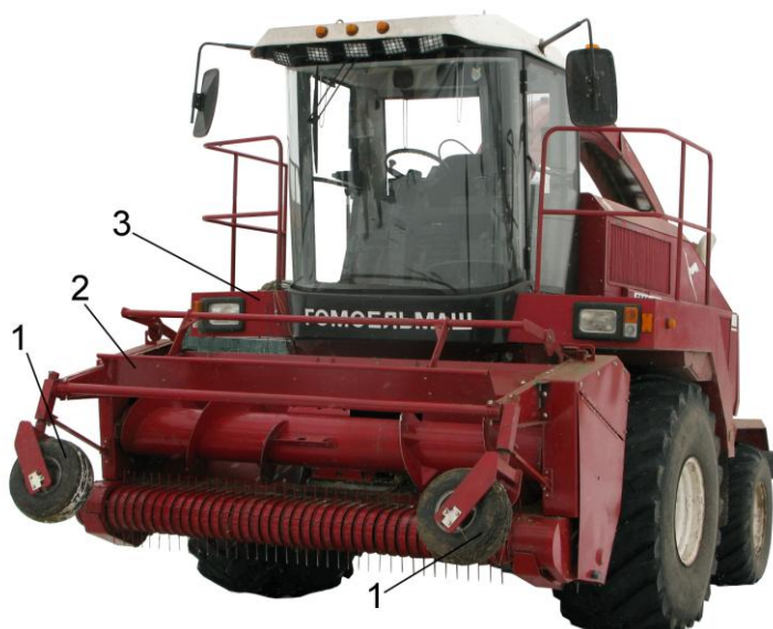
1 – колеса флюгерные; 2 – подборщик; 3 – измельчитель самоходный
