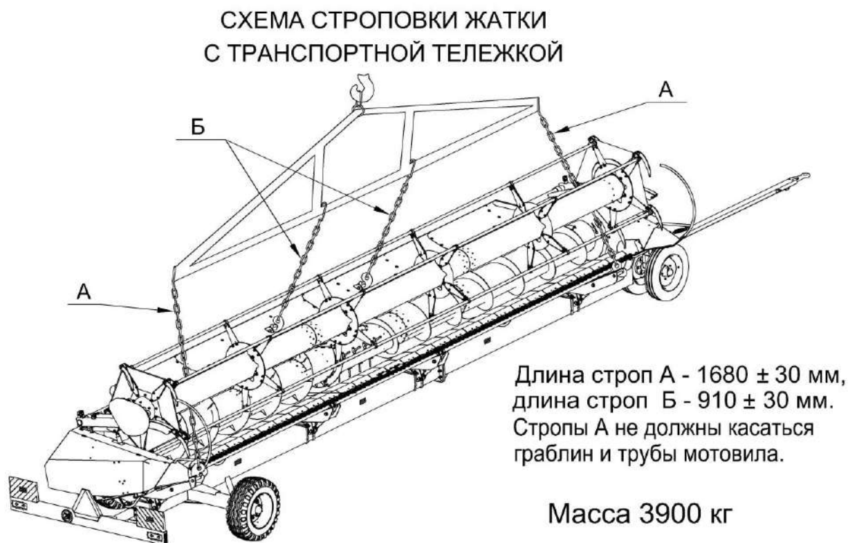
Рисунок 6.1 – Строповка жатки с тележкой
