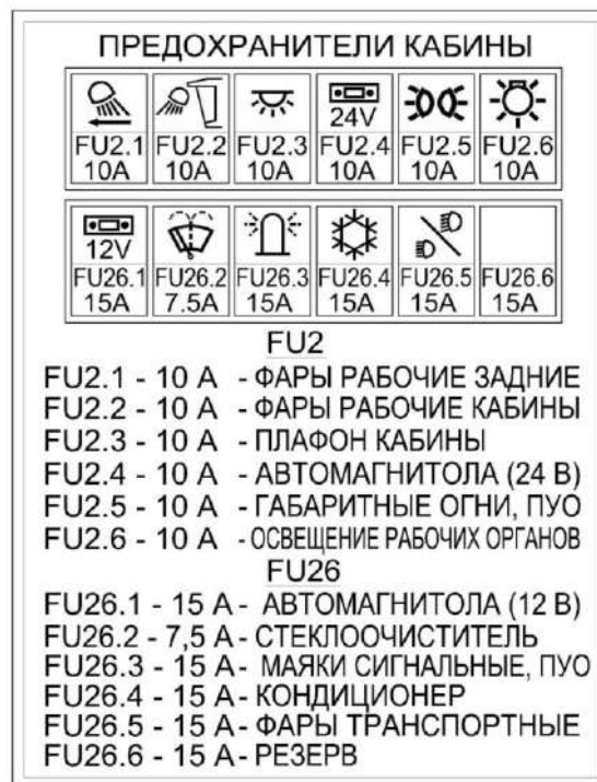
Рисунок 1.38 – Схема расположения предохранителей
