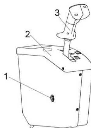
1 – регулировочный болт; 2 – блок управления; 3 – рукоятка управления скоростью движения
