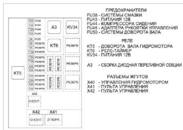
Рисунок 1.30 – Реле и предохранители пульта управления
