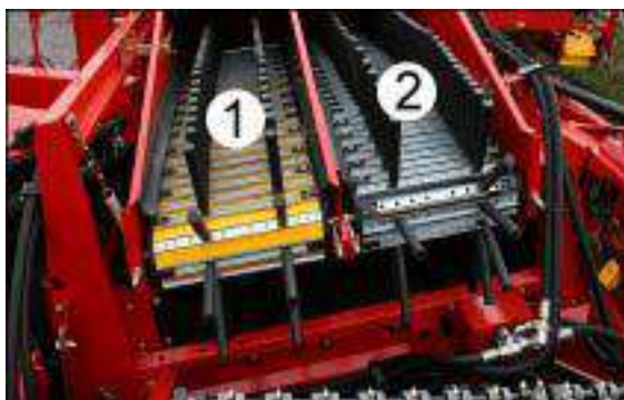
1 - передний пальчиковый транспортер; 2 – задний пальчиковый транспортер
