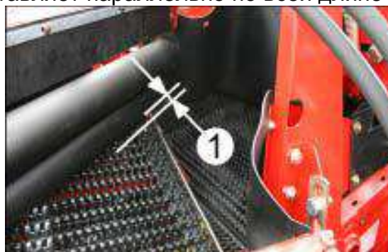
Рисунок 7.35 - Регулировка зазора сдвоенного счищающего вальца
