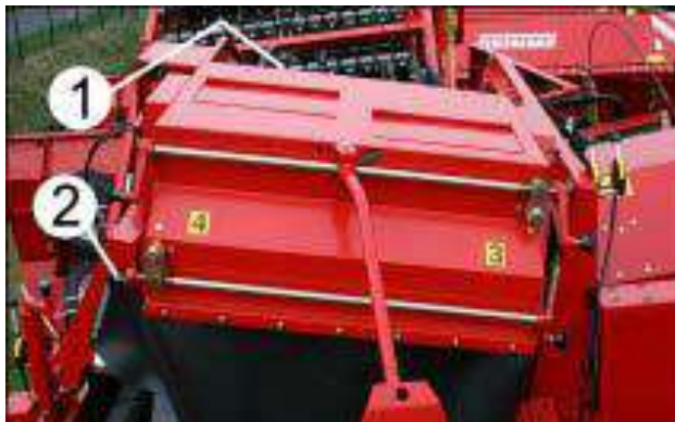
1 – задний пальчиковый транспортер; 2 - ручка
