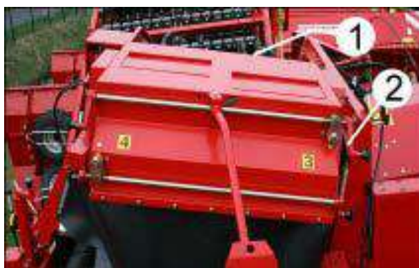
1 – передний пальчиковый транспортер; 2 -ручка
