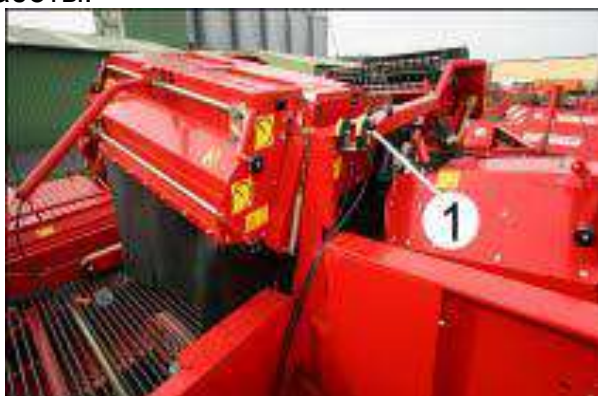
Рисунок 7.32 - Регулировка скорости транспортера второго сепарирующего устройства
