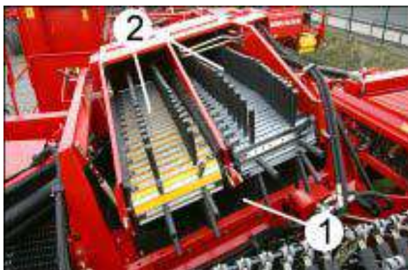
1 – игольчатый транспортер; 2 – пальчиковый транспортер
