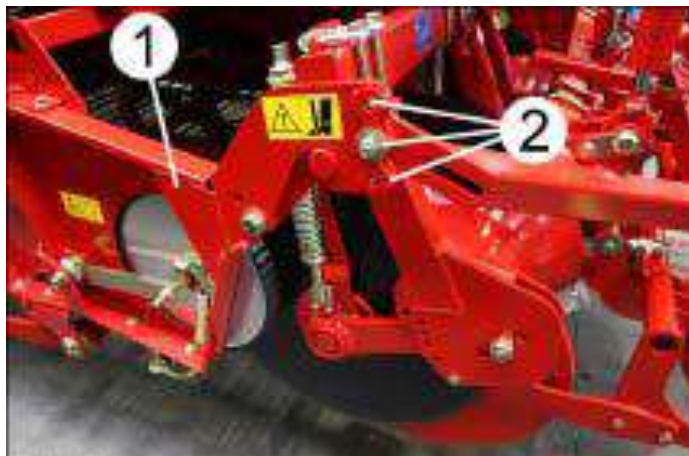
1 – блок подкапывающий; 2 – отверстия
