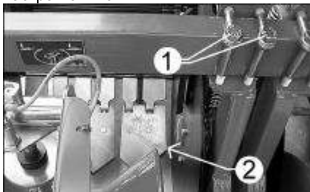
Рисунок 7.10 - Регулировка расстояния между подкапывающим лемехом и диском
