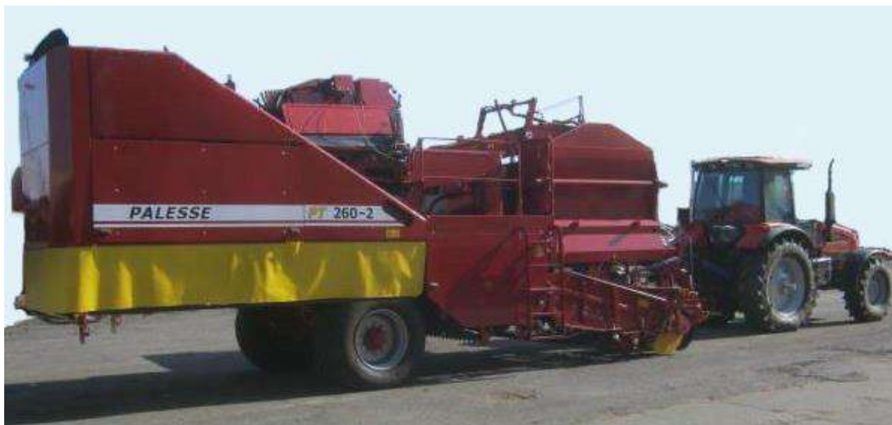
Рисунок 1.1 - Комбайн картофелеуборочный полуприцепной с боковым подкопом КПБ-260-2
