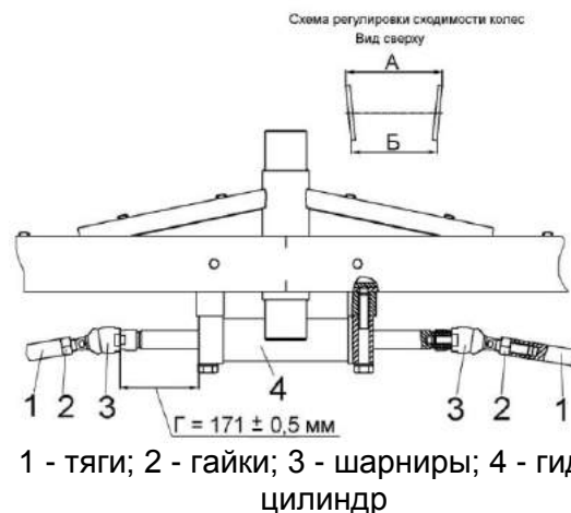
Рисунок 2.18 - Регулировка сходимости колес управляемого ведущего моста
