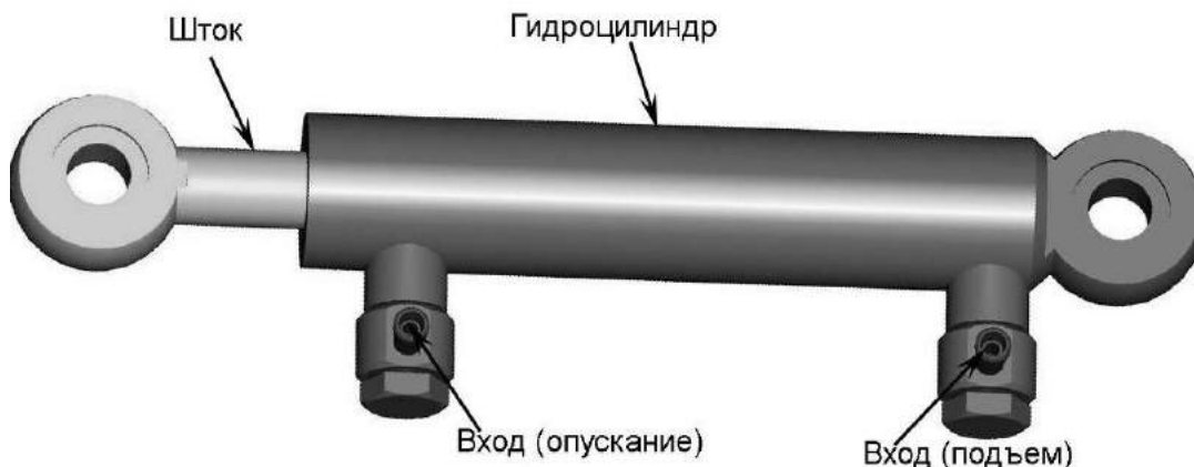
Рисунок 1.55 – Гидроцилиндр подъема силосопровода (Ц2.6)
