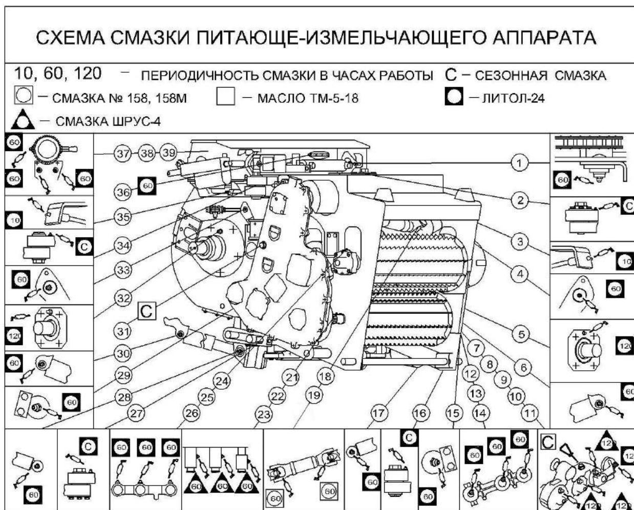
Рисунок 3.28 – Схема смазки питающе - измельчающего аппарата измельчителя
