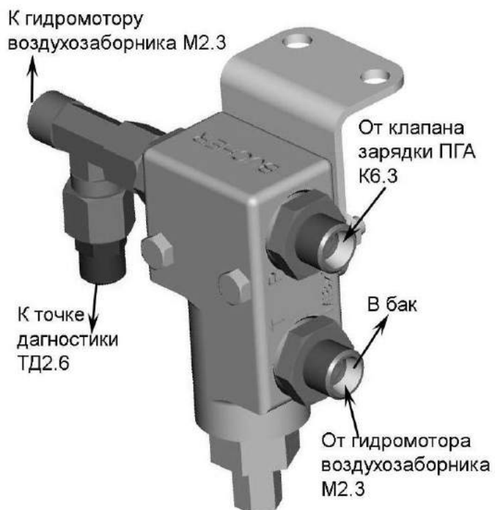
Рисунок 1.53 – Клапан предохранительный (КП2.1)
