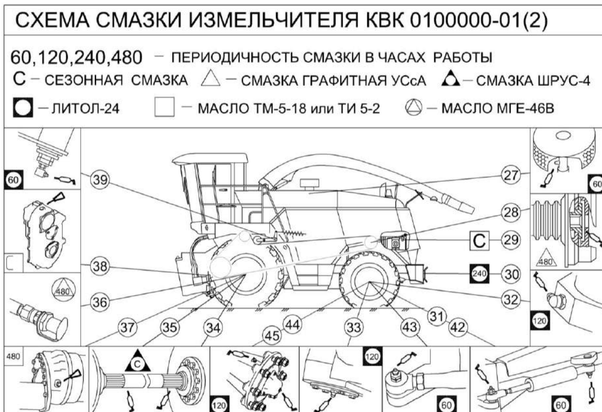
Рисунок 3.27 – Схема смазки измельчителя КВК 0100000 – 01 (вид слева)
