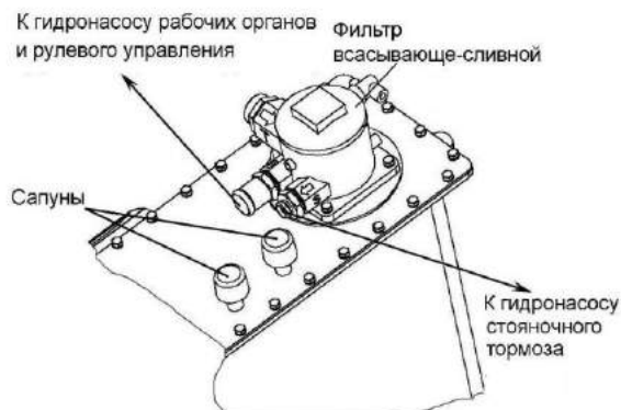
Рисунок 3.21 – Замена фильтроэлемента фильтра и сапунов
