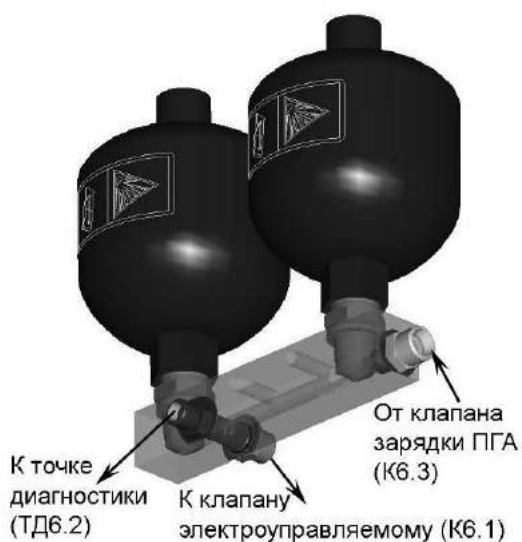
Рисунок 1.70 – Блок пневмогидроаккумуляторов (ПГА6.1, ПГА6.2)
