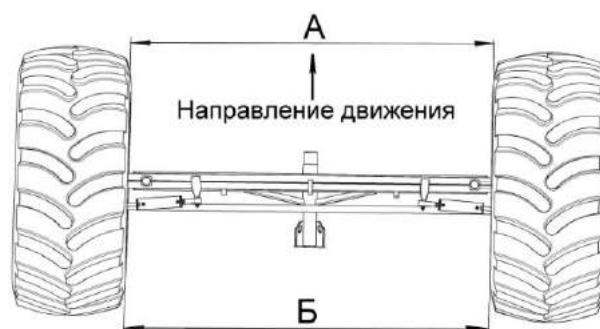
Рисунок 2.20 - Регулировка сходимости колес
