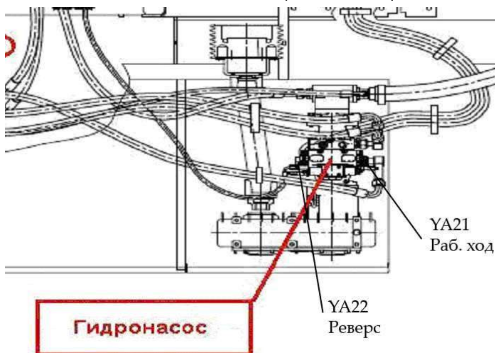
Рисунок М.2 - Расположение магнитов гидронасоса
