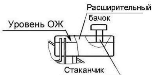
Рисунок 3.3 – Контроль уровня охлаждающей жидкости
