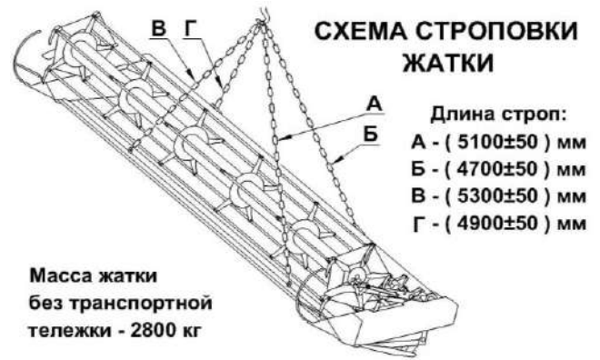
Рисунок 6.2 – Схема строповки жатки
