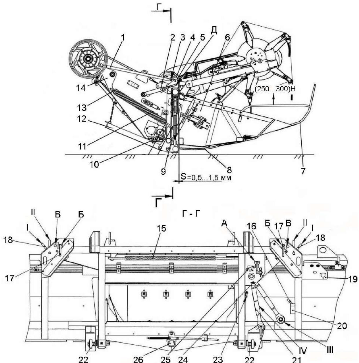
1 – регулируемая тяга; 2, 10 - гидроцилиндр; 3 – серьга; 4, 14, 19, 23 – кронштейны; 5 – ось; 6 – жатка; 7 – прутковый делитель; 8 – башмак; 9 – переходная рамка наклонной камеры; 11, 15 – блоки пружин; 12 - упор; 13 - винт; 16, 17 – пальцы-фиксаторы; 18 – рукоятка упора; 20 – втулка; 21 – толкатель; 22 - эксцентрик; 24 – ось со шплинтом; 25 - рычаг двухлечий; 26 – фиксатор; Д - паз
