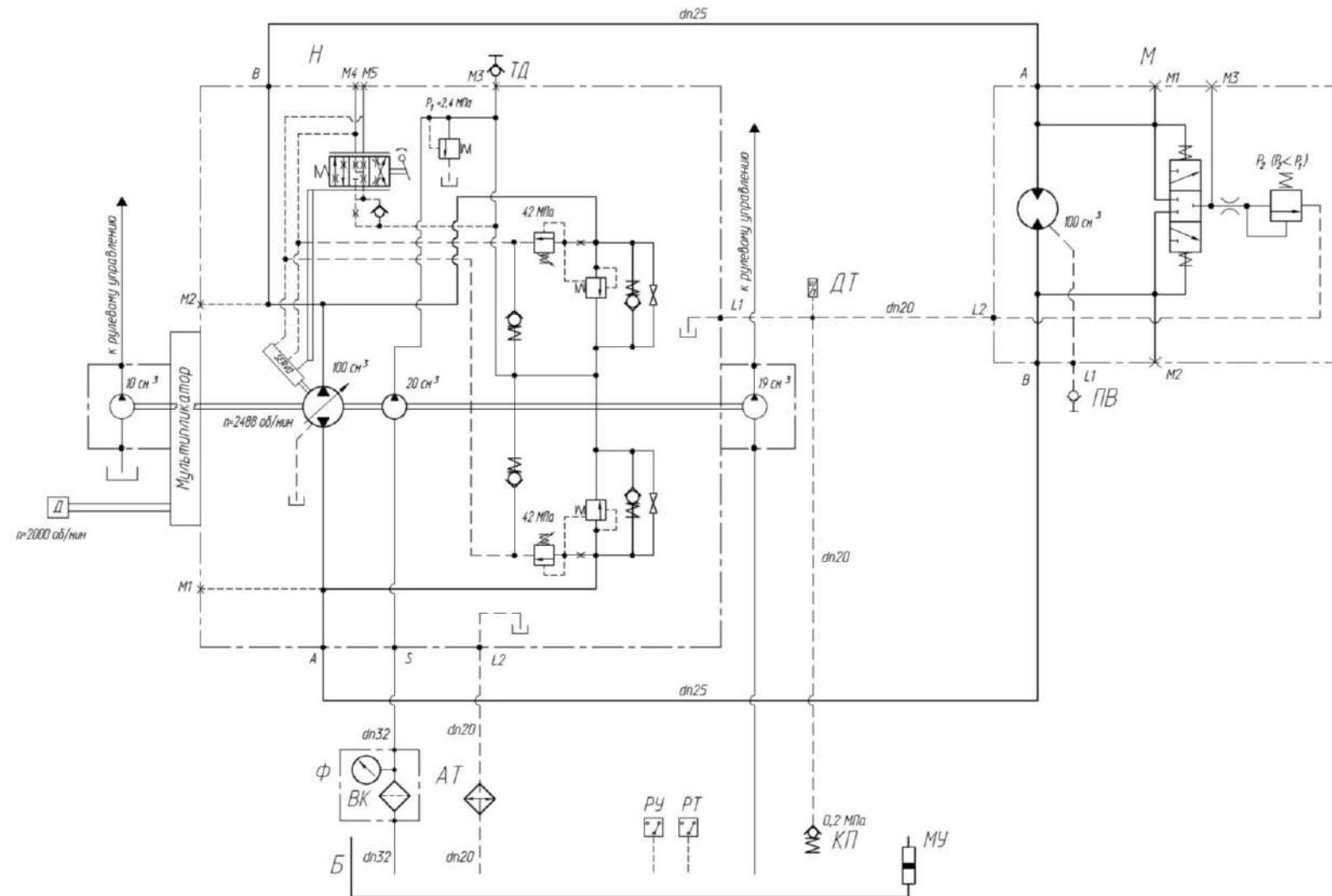
АТ – масляная секция радиатора; Б – бак масляный; ВК – вакуумметр; ДТ – датчик указателя температуры жидкости; КП – гидроклапан обратный; М – гидромотор; МУ – указатель уровня масла; Н – тандем насосов; ПВ – полумуфта внутренняя; РУ – датчик гидросигнализатор; РТ - датчик аварийной температуры жидкости; ТД – соединение резьбовое с колпачком; Ф – фильтр
