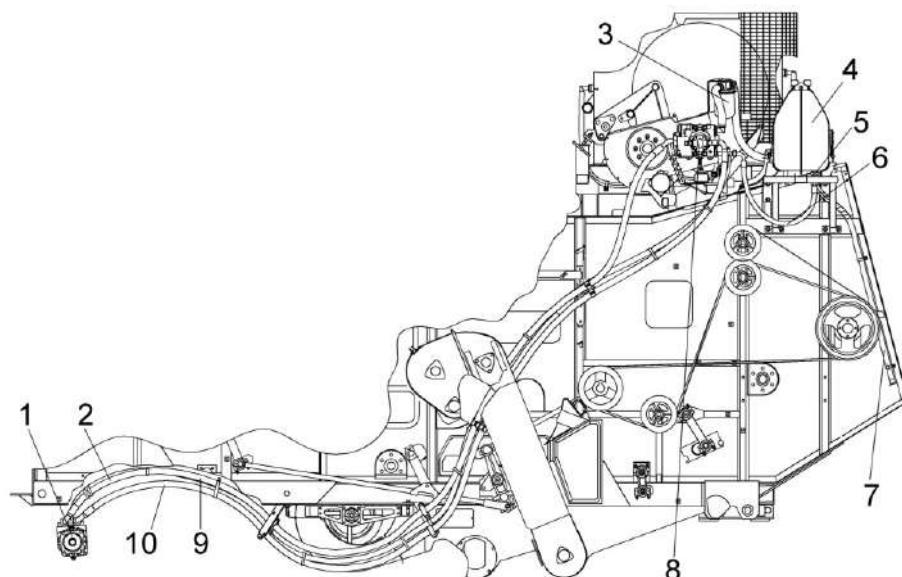
1 – гидромотор; 2, 7 – рукава; 3 – фильтр всасывающий; 4 - бак масляный; 5 - гидроклапан обратный; 6, 9, 10 – рукава высокого давления; 8 - гидронасос
