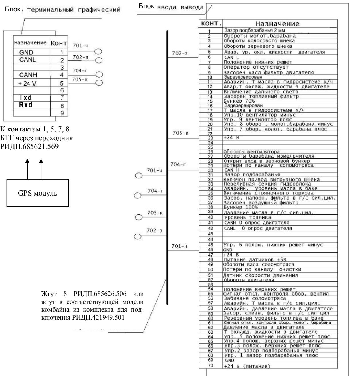
Рисунок 1.143 – Схема подключения БТГ, БВВ и GPS модуля комбайна
