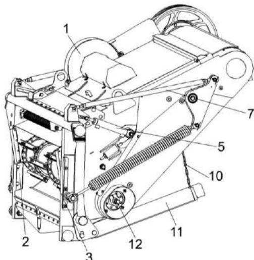
1 – вентилятор; 2 - рамка переходная; 3 – транспортер; 4 – гидрореверс; 5 - гидравлическая система; 6 – рама; 7 – механизм продольного копирования; 8 – вал верхний; 9 – муфта предохранительная; 10 - цепочка; 11 – упор; 12 – вал трансмиссионный
