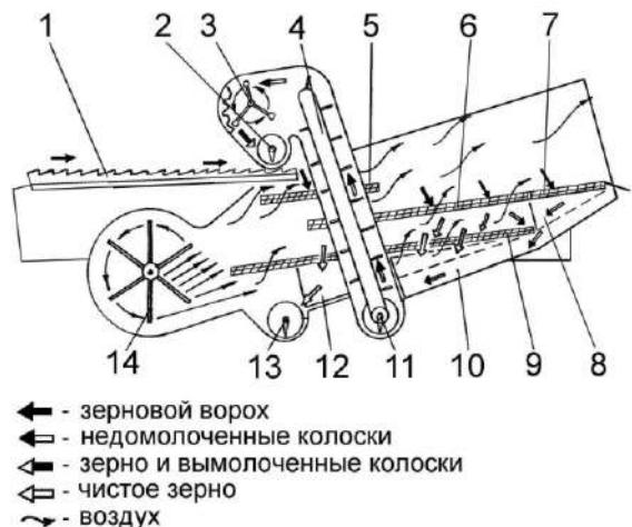
1 – стрясная доска; 2 – шнек распределительный; 3 – устройство домолачивающее; 4 – элеватор колосовой; 5 – дополнительное решето; 6 – решето верхнее; 7 - удлинитель верхнего решета; 8 - поддон удлинителя; 9 – решето нижнее; 10 – поддон колосовой; 11 – шнек колосовой; 12 – поддон зерновой; 13 – шнек зерновой; 14 – вентилятор
