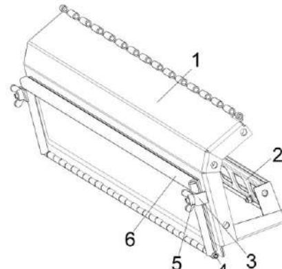
1 – основание; 2 – щит; 3 – прижим; 4 -ось; 5 – гайка-барашок; 6 – крышка
