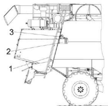
1 – лестница; 2 - топливный бак; 3 - заливная горловина
