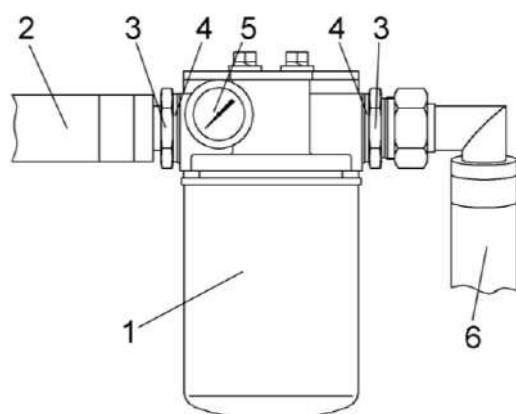
1 – фильтр всасывающий; 2, 6 – рукава высокого давления; 3 – штуцера; 4 – прокладки; 5 – вакуумметр
