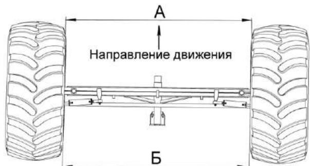
Рисунок 2.26 - Регулировка сходимости колес
