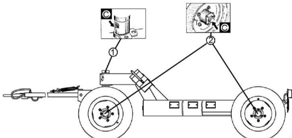
Рисунок 3.5 – Схема смазки транспортной тележки
