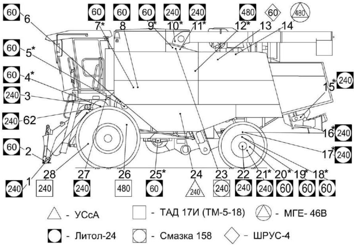
Рисунок 3.2 – Смазка молотилки (вид слева)
