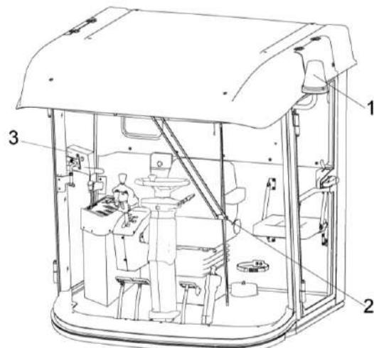
1 – проблесковый маяк; 2 – стеклоочиститель; 3 – модуль терминальный графический
