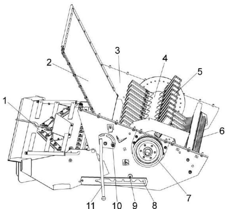
1 – дефлектор; 2 – заслонка; 3 – корпус измельчителя; 4 – ротор измельчителя; 5 – нож; 6 – ножевая опора; 7 – шкив; 8 – полоз; 9, 10 – гайки; 11 - рукоятка сектора
