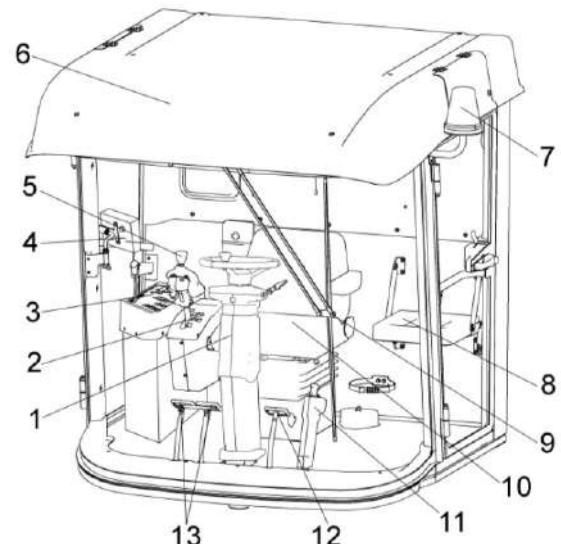
1 – колонка рулевая; 2 – блок управления; 3 – пульт управления; 4 – бортовой компьютер; 5 – рычаг переключения передач; 6 – крыша кабины; 7 – маяк проблесковый; 8 - дополнительное сиденье; 9 – стеклоочиститель; 10 - сиденье; 11 – рукоятка стояночного тормоза; 12 – педаль блокировки коробки передач; 13 - тормозные педали
