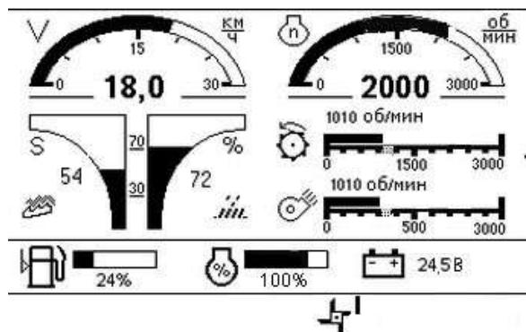
Рисунок 1.90 – Экран технологического режима уборки (комбайнирования)
