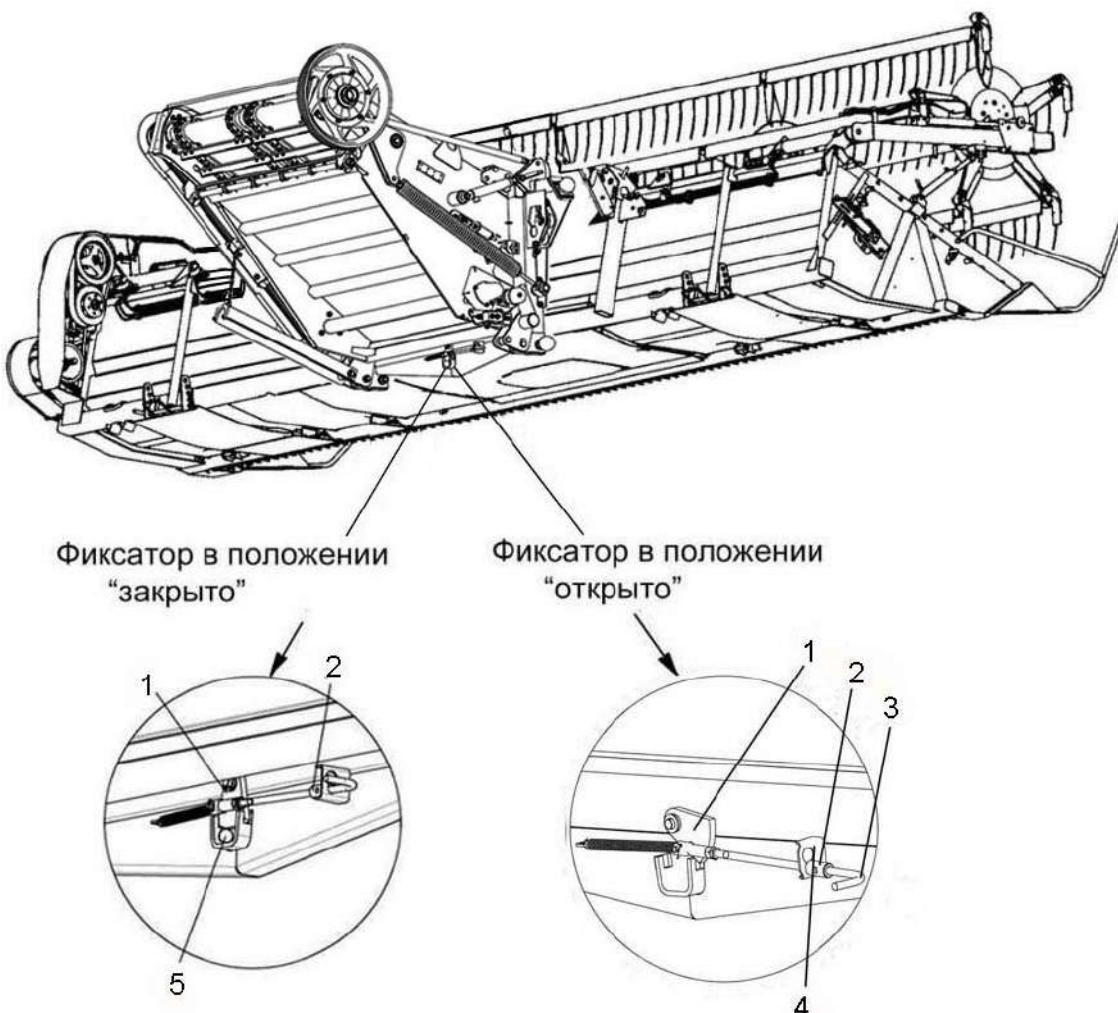
1 – поворотный язычок; 2 – втулка; 3 – фиксатор; 4 – кронштейн; 5 – центральный палец жатки
