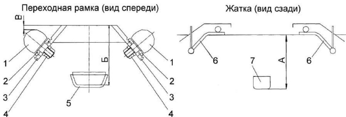
1 – сферический ролик; 2 – рифленая шайба; 3 – пластина; 4 – гайка; 5 – ложе;
