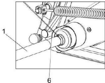
1 - вал карданный; 2, 4, 5 – гидровыводы; 3 – электрическая розетка; 6 - цепочка
