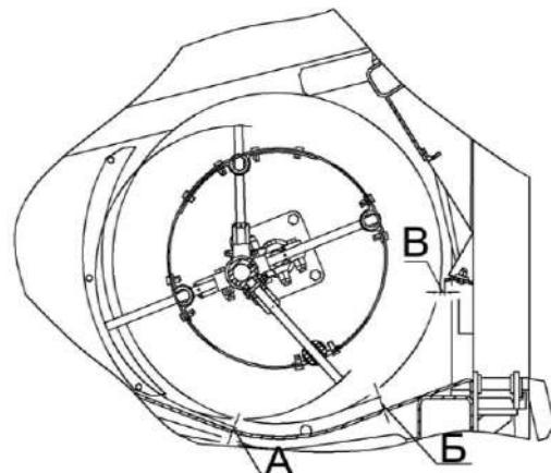
А – зазор между витками шнека и днищем жатки;
