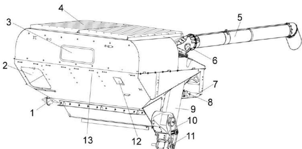
1 – шнек загрузной; 2 - крышка; 3 - смотровое окно; 4 - крыша бункера; 5 - шнек поворотный выгрузной; 6 - отвод с редуктором; 7 – настил; 8 – виброродно; 9 - шнек наклонный выгрузной; 10 – цепная передача привода шнека горизонтального; 11 – редуктор; 12 - окно пробоотборника; 13 - бункер
