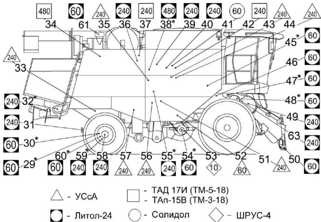
Рисунок 3.3 – Смазка молотилки (вид справа)
