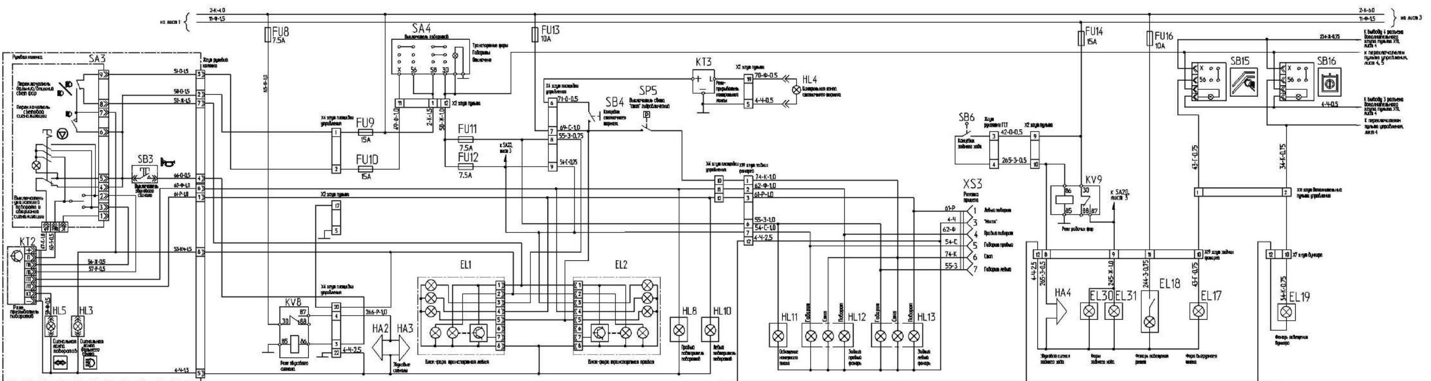
Рисунок Б.2 – Схема электрическая принципиальная комбайна (лист 2)
