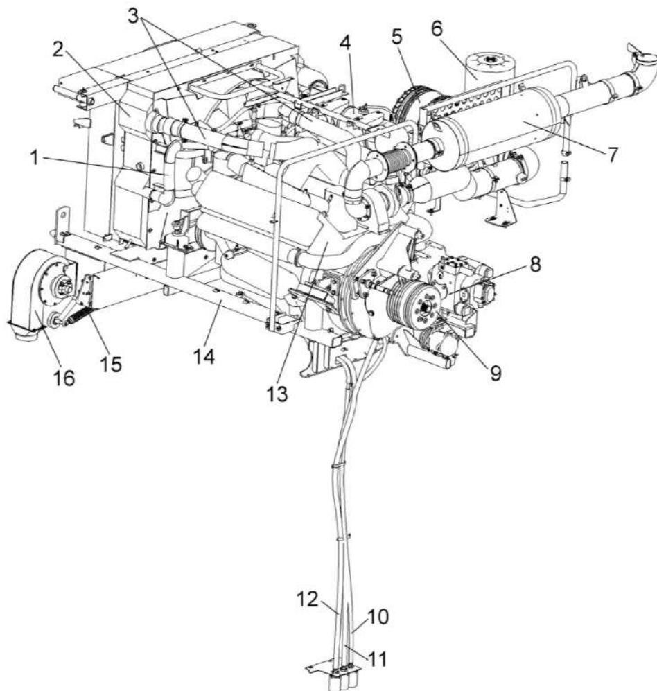
1 – труба водяная верхняя; 2 – радиатор; 3 – трубы воздушные; 4 – бачок расширительный; 5 – воздухозаборник; 6 – воздухозаборник вращающийся; 7 – глушитель; 8 – установка гидронасосов; 9 – главный привод; 10 – сливной рукав охлаждающей жидкости; 11 – сливной рукав масла из редуктора; 12 – сливной рукав масла из картера двигателя; 13 – двигатель; 14 – рама подмоторная; 15 – устройство натяжное; 16 – вентилятор
