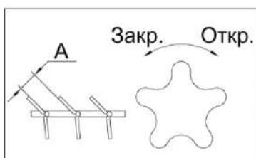
В случае появления повышенных потерь полноценного зерна в голове или щуплого зерна с головой следует установить дополнительные щитки 1 (рисунок 2.20) на нижнем решетном стане.
