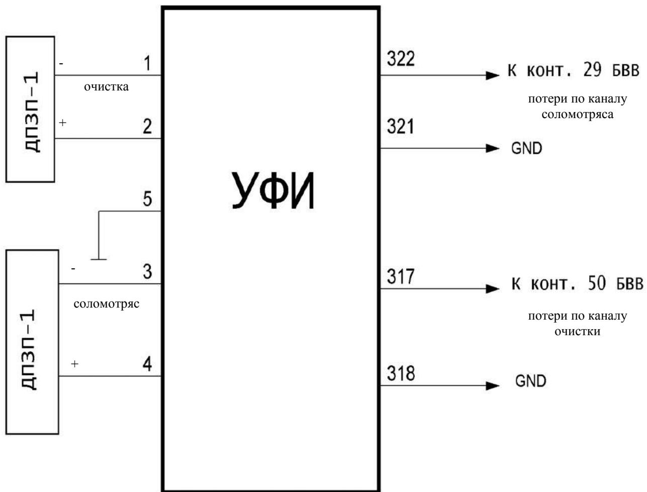
ДПЗП-1 – датчик потерь зерна пьезоэлектрический
