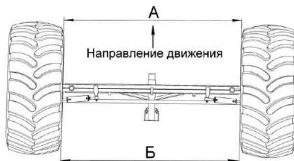
Рисунок 2.22 - Регулировка сходимости колес
