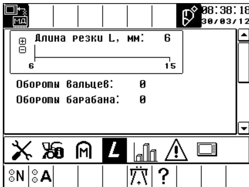
Рисунок 2.17 – Установка длины резки
