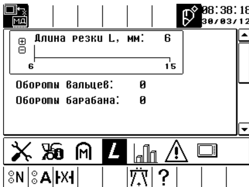
Рисунок 1.35 – раздел «Установка длин резок»
