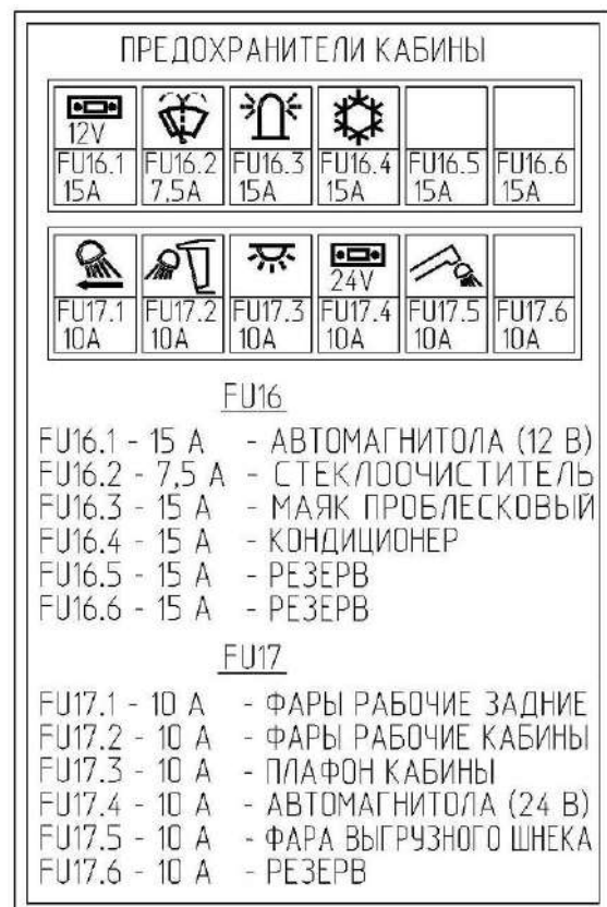
Рисунок 1.44 – Схема расположения предохранителей
