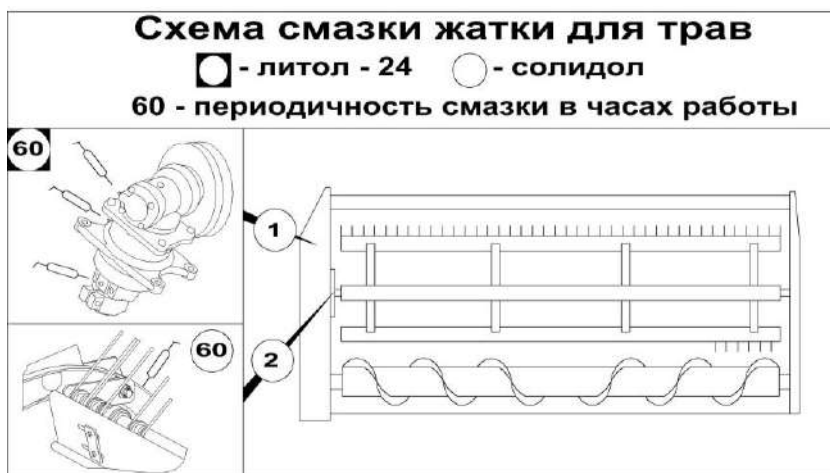
Рисунок 3.5 – Схема смазки жатки для трав
