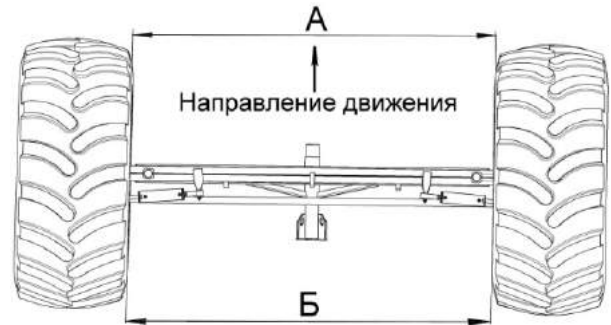
Рисунок 2.9 - Регулировка сходимости колес
