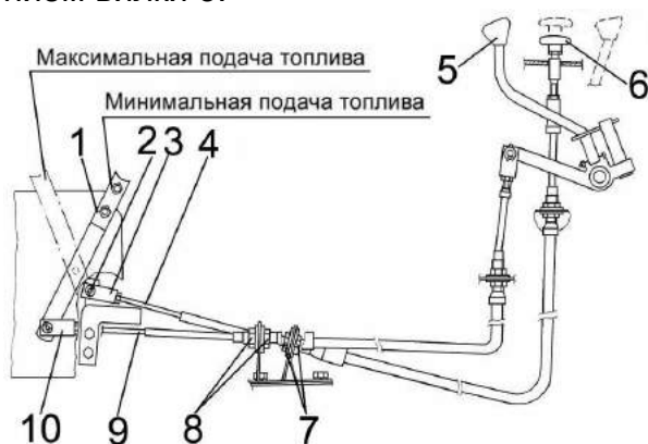
Рисунок 2.11 – Механизмы управления подачей топлива и остановкой двигателя
