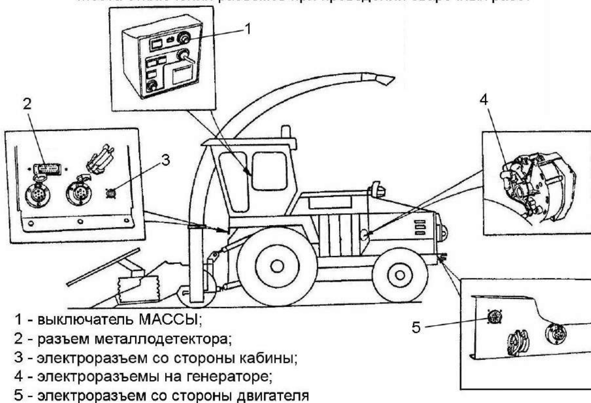
Места отключения разъемов при проведении сварочных работ
