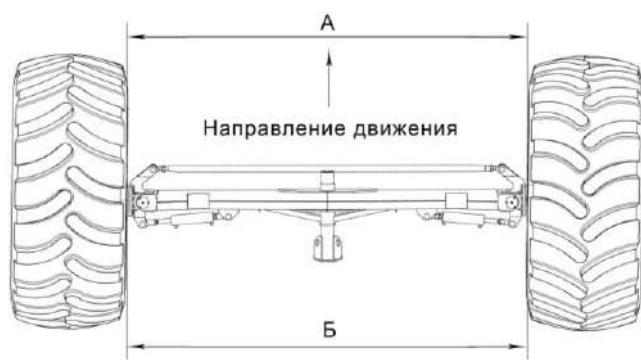
Рисунок 2.17 - Регулировка сходимости колес
