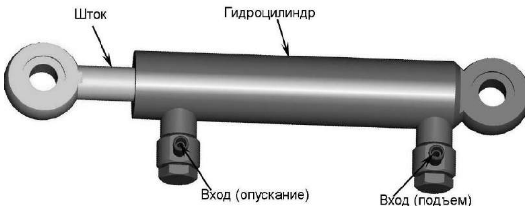
Рисунок 1.55 – Гидроцилиндр подъема силосопровода (Ц2.6)
