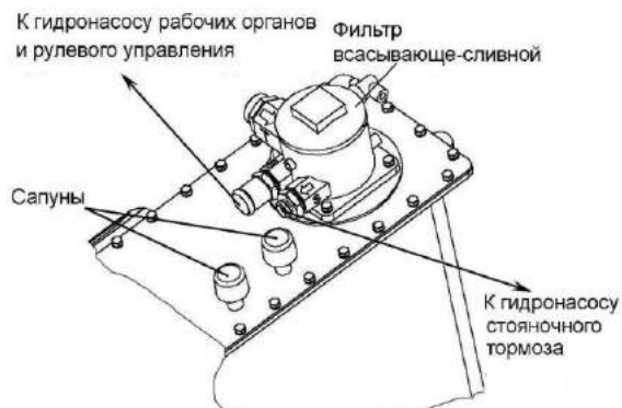
Рисунок 3.13 – Замена фильтроэлемента фильтра и сапунов
