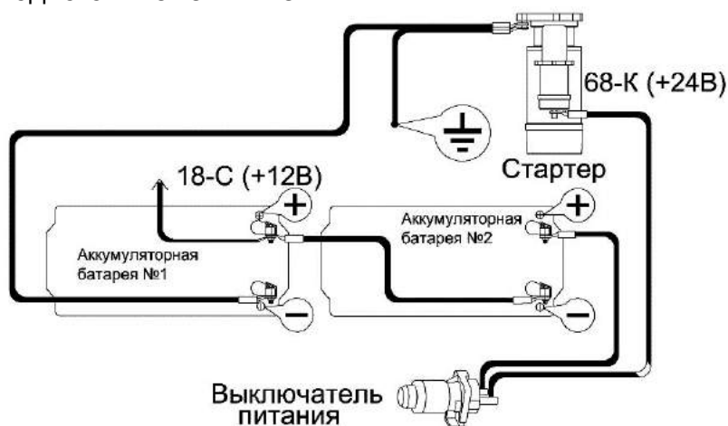
Рисунок 2.1 – Схема подключения АКБ
