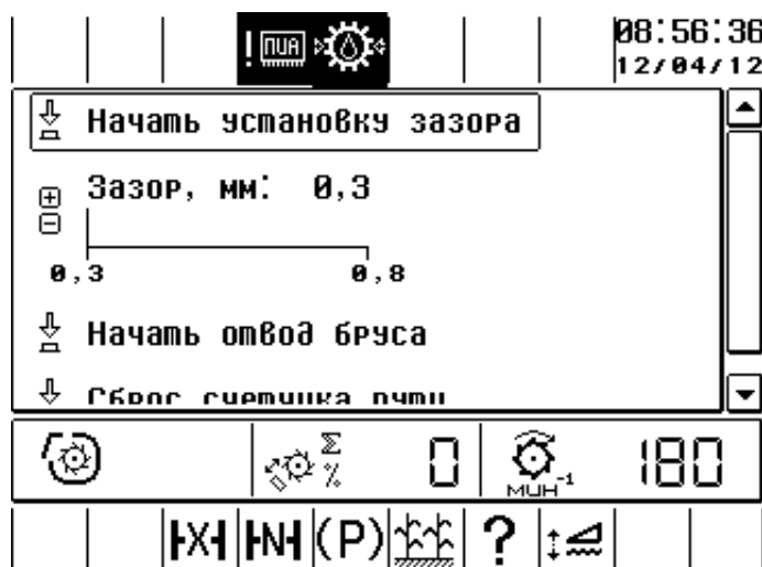
Рисунок 2.12– Меню установки зазора
