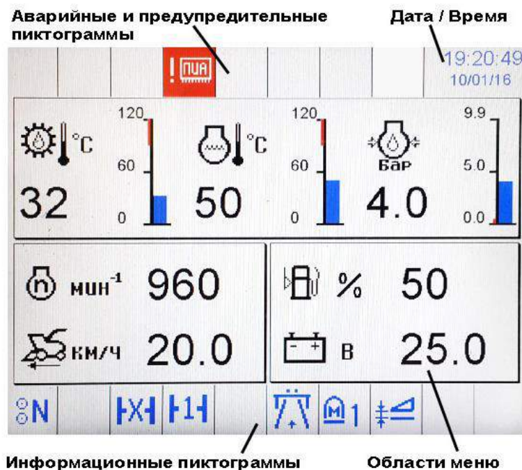
Рисунок Р.2 – Области на экране терминала
