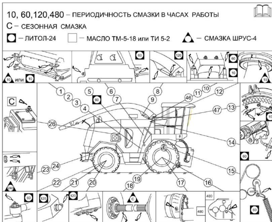
Рисунок 3.14 – Схема смазки измельчителя КВК 0100000 (вид справа)
