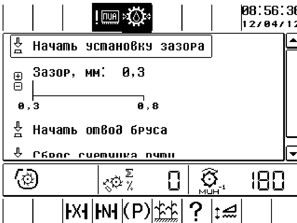
Рисунок Ж.25– Меню установки зазора
