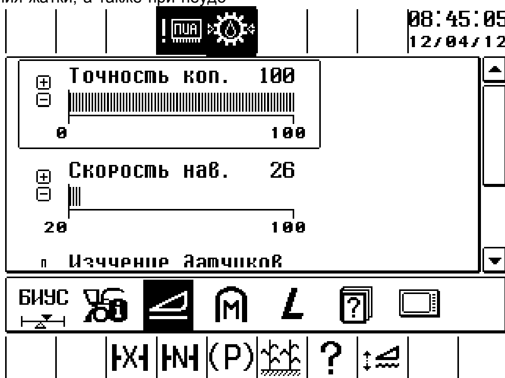
Рисунок Ж.20 – Установки автоматики навески
