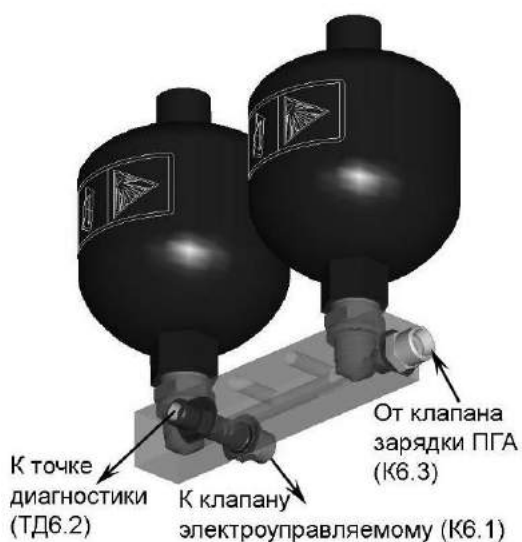
Рисунок 1.70 – Блок пневмогидроаккумуляторов (ПГА6.1, ПГА6.2)
