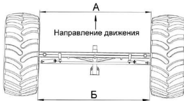
Рисунок 2.26 - Регулировка сходимости колес
