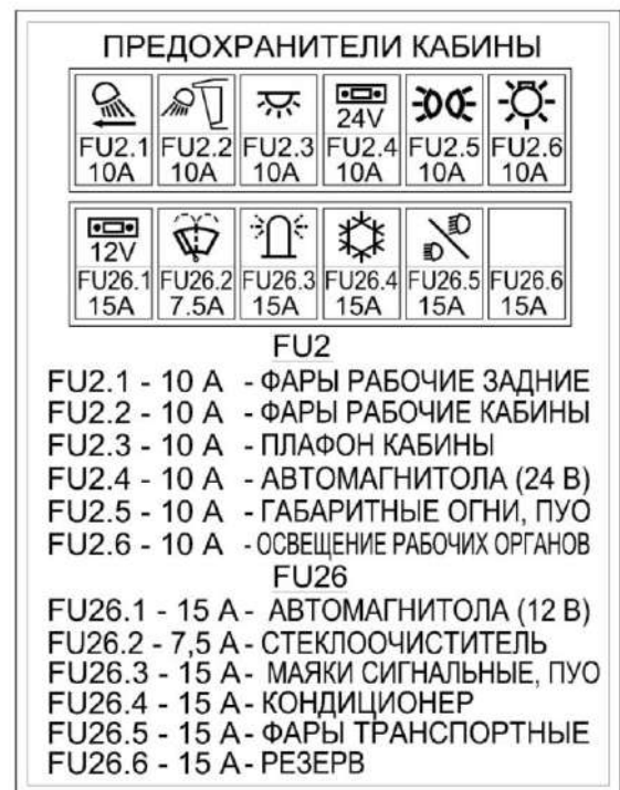
Рисунок 1.38 – Схема расположения предохранителей
