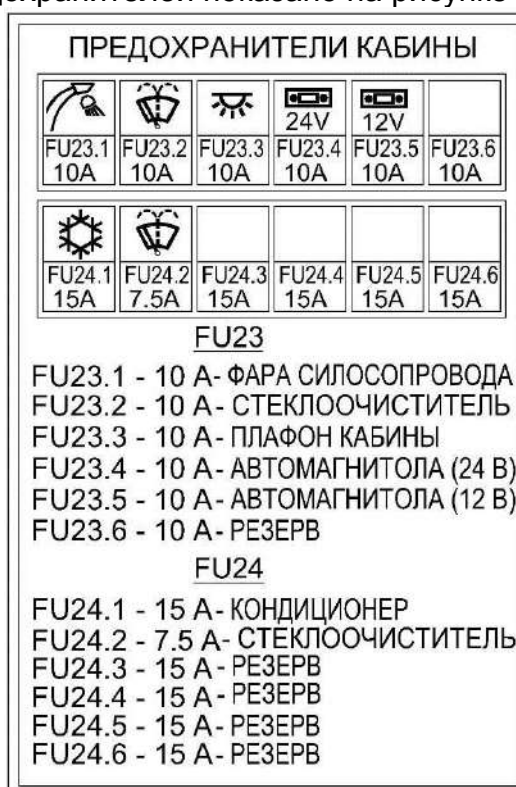
Рисунок 1.47 – Предохранители кабины
