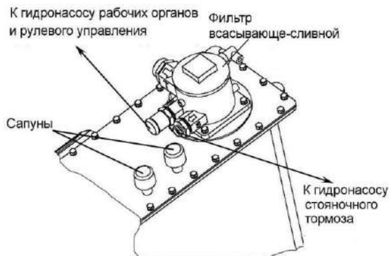
Рисунок 3.13 – Замена фильтроэлемента фильтра и сапунов
