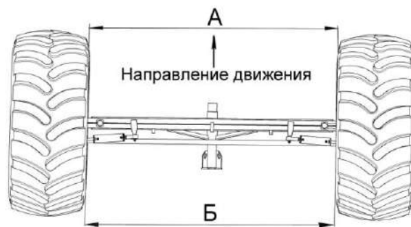
Рисунок 2.26 - Регулировка сходимости колес
