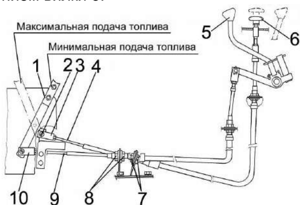
Рисунок 2.11 – Механизмы управления подачей топлива и остановкой двигателя
