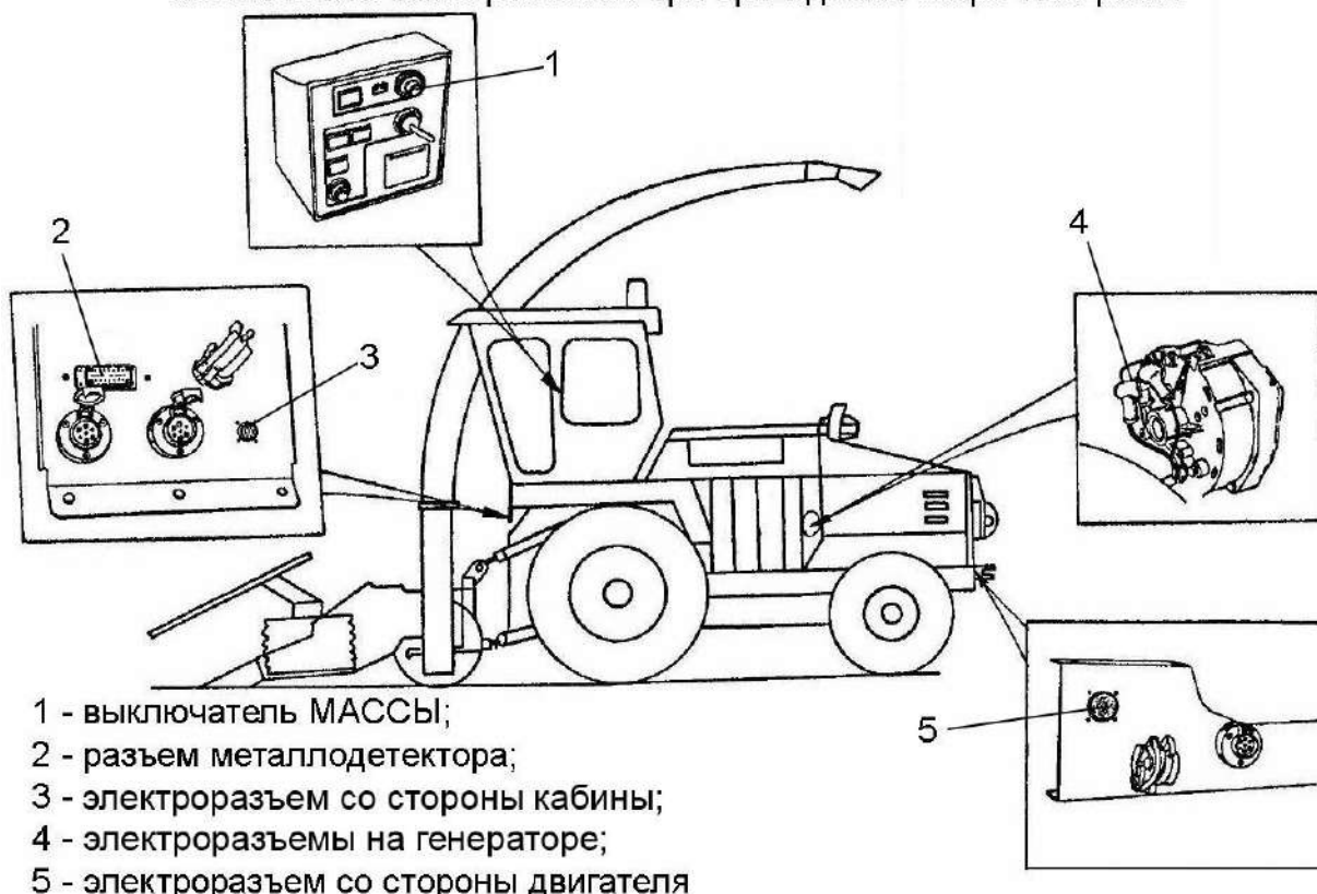
Места отключения разъемов при проведении сварочных работ
