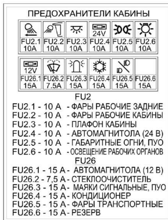
Рисунок 1.37 – Схема расположения предохранителей
