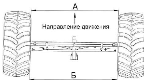
Рисунок 2.14 - Регулировка сходимости колес
