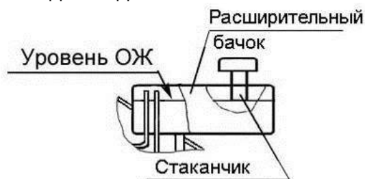
Рисунок 3.3 – Контроль уровня охлаждающей жидкости
