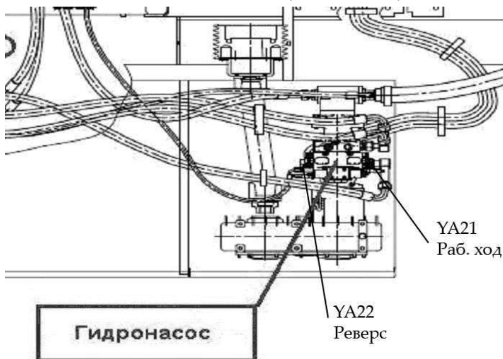
Рисунок М.2 - Расположение магнитов гидронасоса
